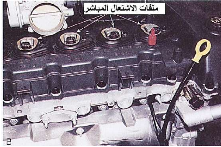
شكل (4-1) ملفات الاشتعال المباشر مركبة على المحرك
