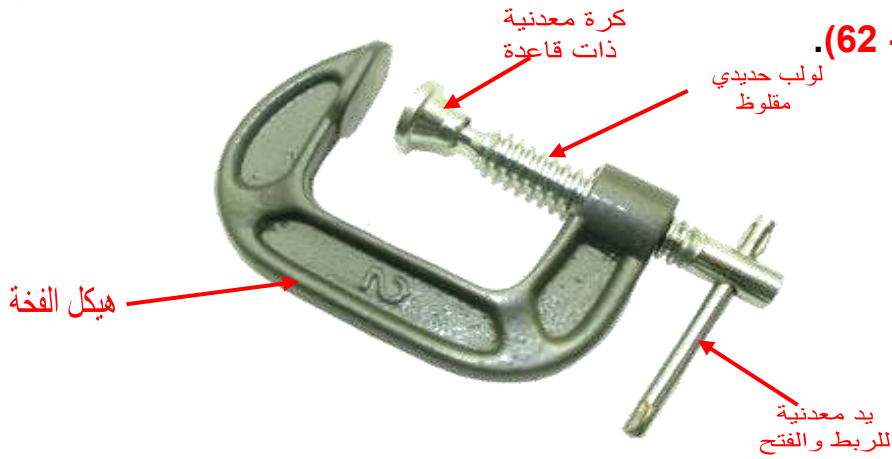
الشكل (2 - 62) يوضح فخة حديدية على شكل حرف C
