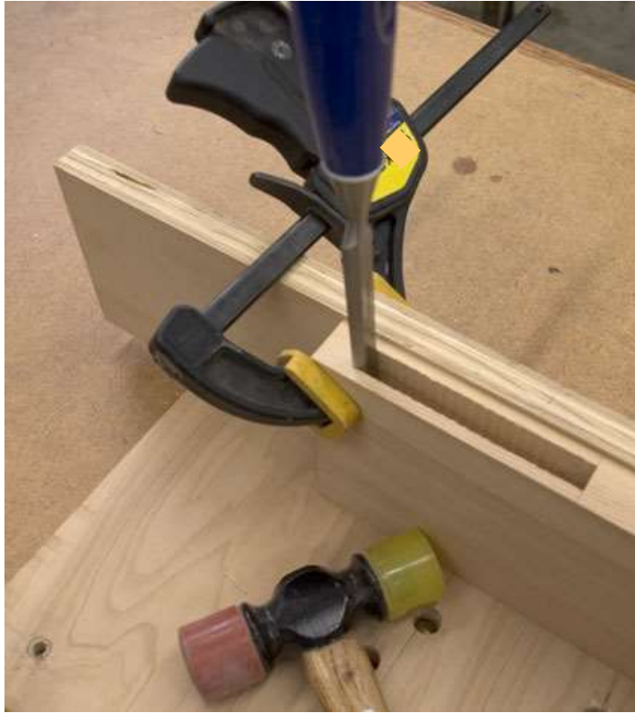
الشكل (2 - 84) يوضح تعامل المنقار مع سطح الشغلة
