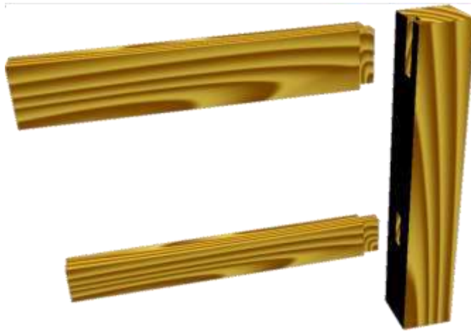
شكل (3 - 11) تجميع الأرجل مع العارضة الجانبية للطاولة
