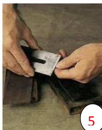
شكل ( 2 - 33 ) يبين كيفية سن سلاح الرندة
