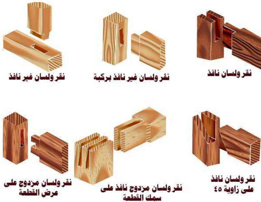
شكل رقم (3 - 9) يبين أنواع وصلات النقر واللسان
