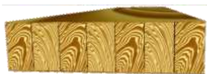
الشكل (1-64) يوضح الألواح ذات السدائب الرقيقة
