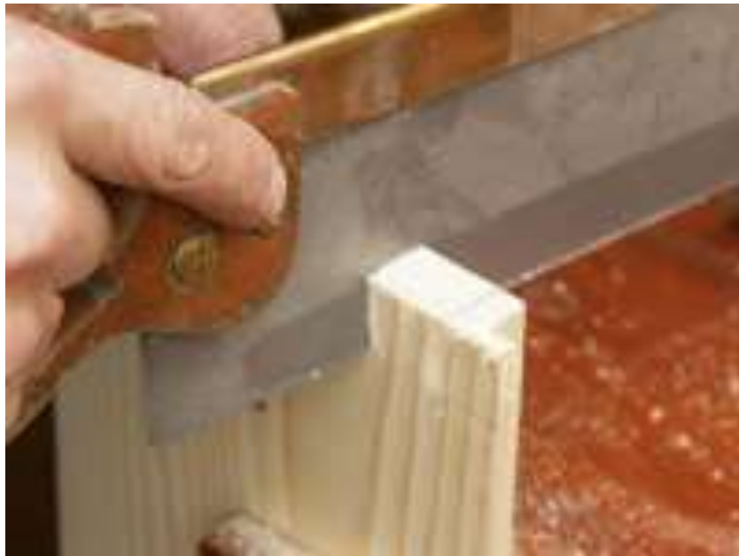
الشكل (2 - 36 أ) يوضح استعمال منشار الظهر
