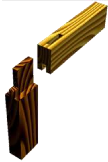
شكل (3 - 14) يوضح تعشيقة نقر ولسان نافذ بركبة
