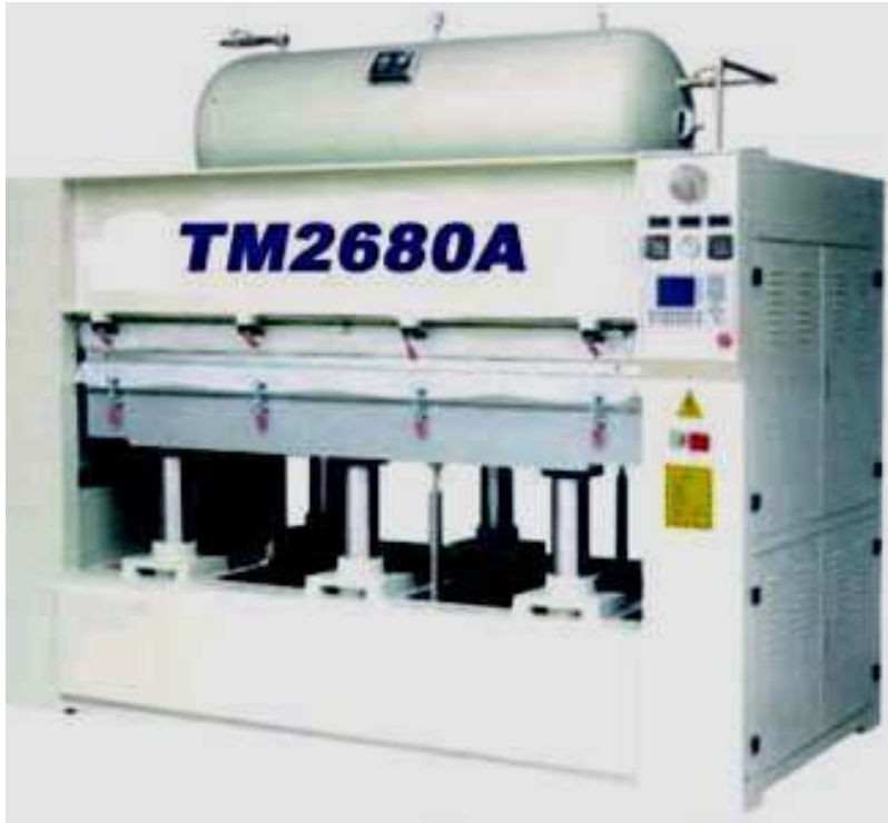
شكل (1 - 59) يبين المكبس الحراري ذو الكيس المطاطي
