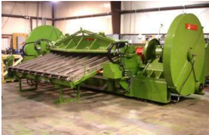
شكل (1 - 48 ب) يبين ماكنة قطع القشرة المركزية
