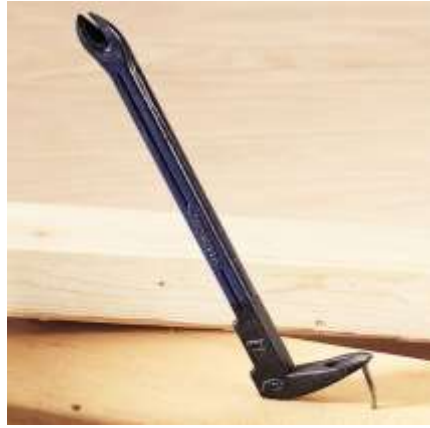
الشكل (2 - 57) يوضح العتلة الخاصة لرفع المسامير الكبيرة
