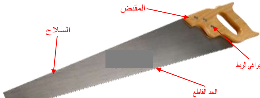
الشكل (2 - 33) يوضح منشار (الشق الطولي) منشار الدفع
