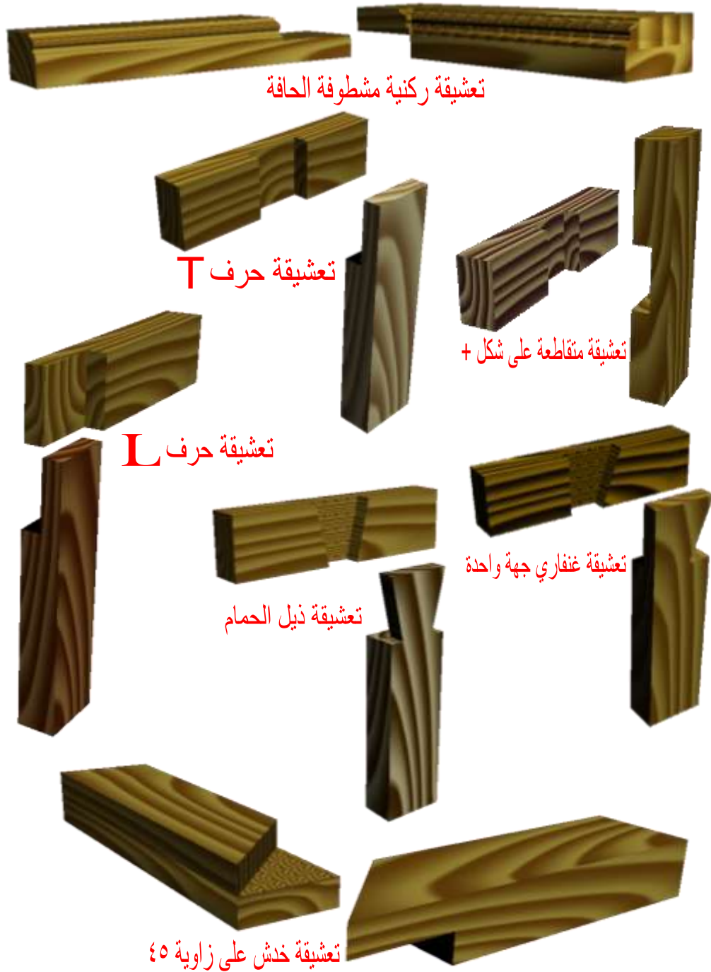
شكل (3 - 1) يوضح أنواع وصلات الخدش
