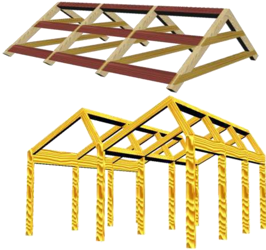
شكل (3 - 17) يوضح استعمال تعشيقة اللجام في عمل المسقفات
