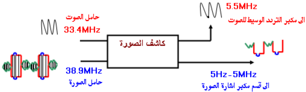
الشكل (5 - 13) المخطط الكتلي لكاشف الصورة
