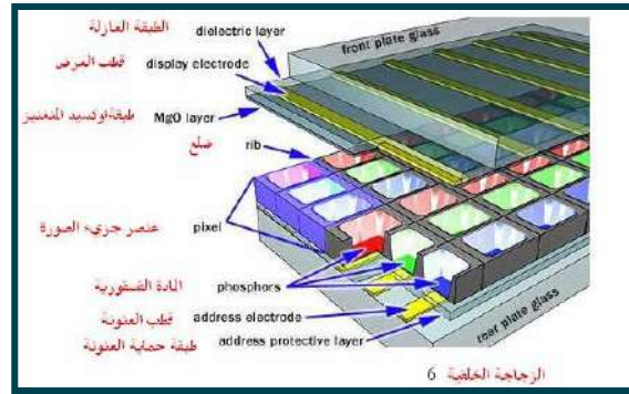
الشكل (5-65) يبين تركيب شاشة البلازما
