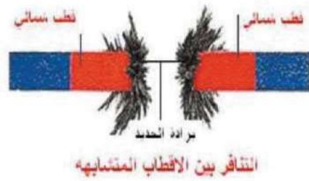
الشكل ( 19 - 2 ) التجاذب والتنافر بين الأقطاب المغناطيسية
