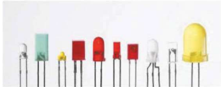
الشكل ( 31 - 4 ) انواع واحجام مختلفة من ثنائيات الانبعاث الضوئي
