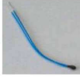
الشكل ( 1 - 13 ) مقاومات نوع P.TC , N.T.C
