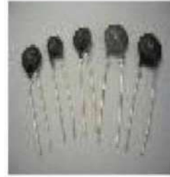
الشكل ( 1 - 13 ) مقاومات نوع P.TC , N.T.C
