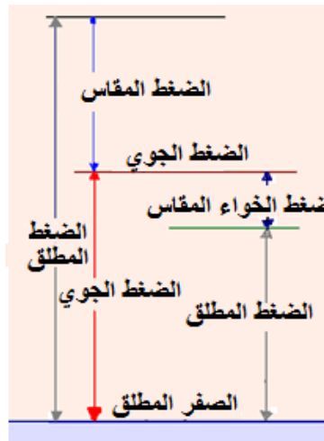
شكل 7-1 الضغط الجوي والضغط المقاس وضغط الخواء والضغط المطلق
