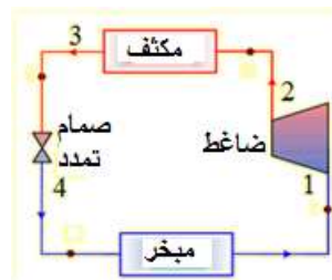
شكل 8-4 دورة كارنو بعد إبدال التوربين بصمام تمدد
