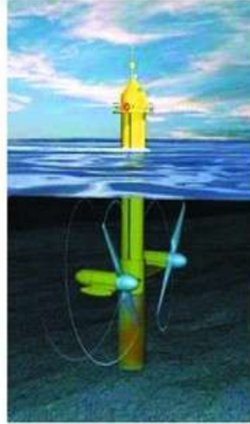
الشكل رقم (2-6) رسم توضيحي يبين الخطط المستقبلية لإنشاء مثل هذه المولدات بغرض الاستفادة من طاقة الأمواج الداخلية لتوليد الكهرباء
