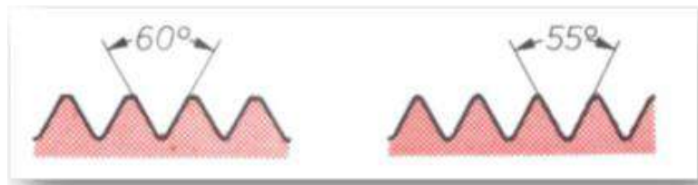
شكل 6-42 زوايا سن لولب التثبيت
