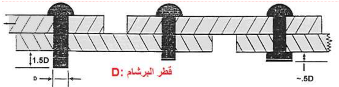
شكل 7-13 مقطع تجميعي الربط بالبرشام
