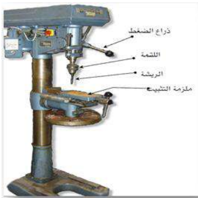
شكل 6-35 أجزاء المثقب العمودي البسيط
