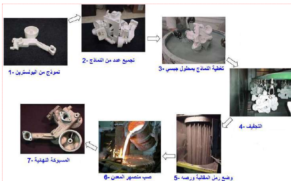
شكل 4-8 سباكة بنماذج الرغوة المفقودة (البولسترين)
