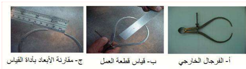
شكل 1-11 فرجال القياس الخارجي وطريقة استعماله
