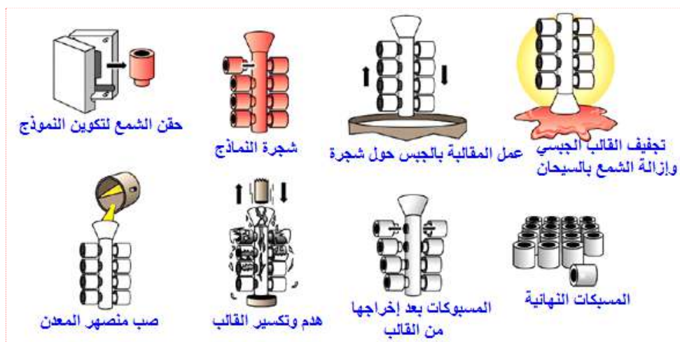
شكل 4-9 السباكة الدقيقة بالشمع المفقود
