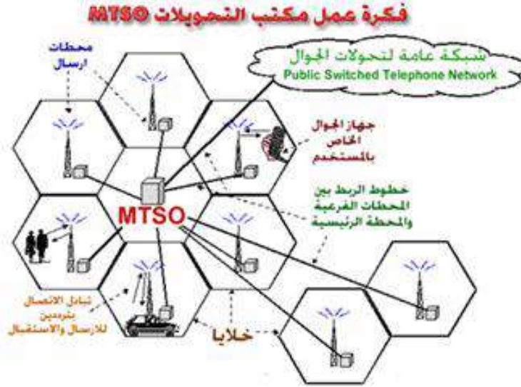
الشكل ( 6 - 4 ) فكرة عمل مكتب التحويلات MTSO
