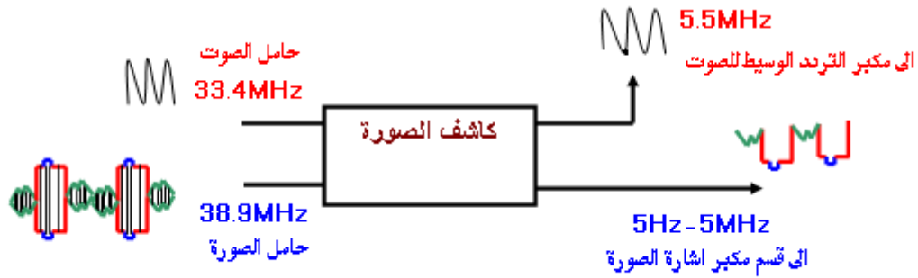
الشكل ( 30 - 5 ) المخطط الكتلي لكاشف الصورة
