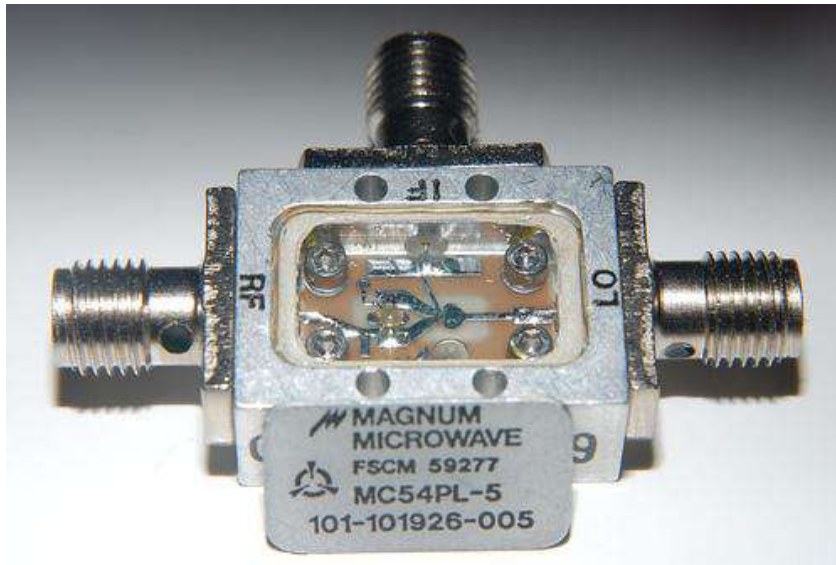
الشكل ( B - 6 - 7 ) يوضح المازج في منظومة مايكروويف
