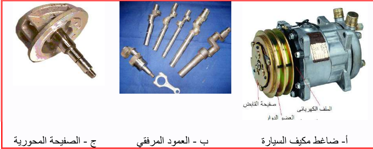
شكل 5-15 الضاغط الترددي في السيارة
