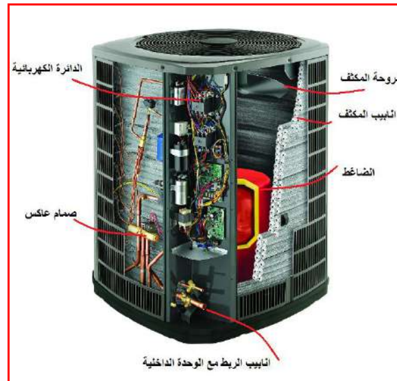
شكل 5-7 الوحدة الخارجية لمكيف الهواء المنفصل
