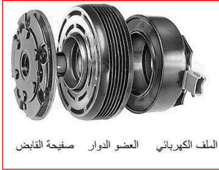
شكل 5-17 القابض المغناطيسي لضغط السيارة
