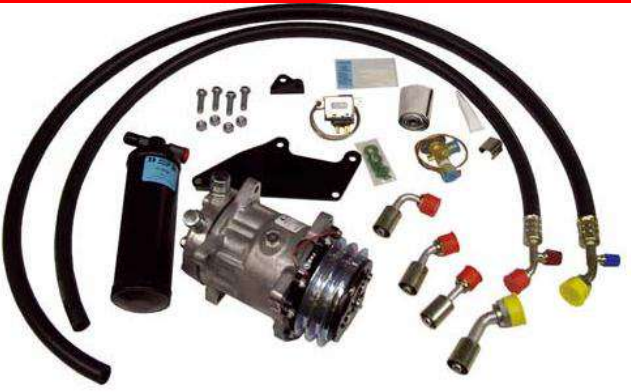
شكل 21-5 أجزاء منظومة التثليج في السيارة
