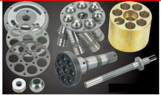
شكل 20-5 أجزاء ضاغط السيارة
