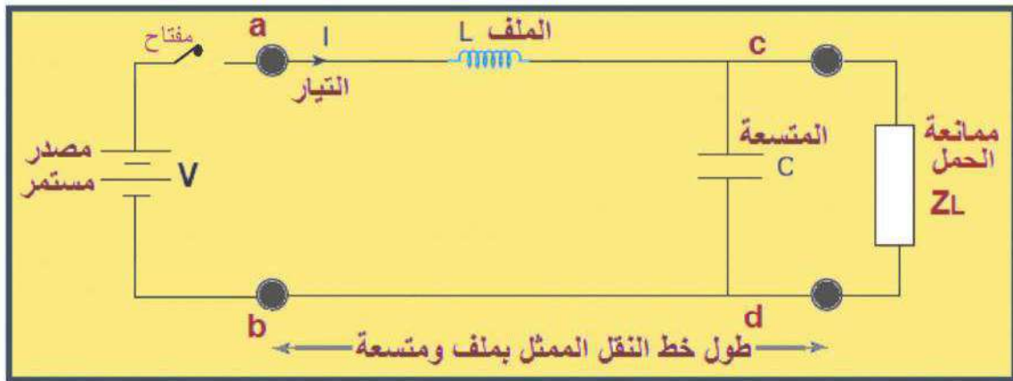
الشكل (5-7) خط نقل طوله مالا نهاية وقد اهملت فيه المقاومة وهو يتصل بمصدر تيار مستمر
