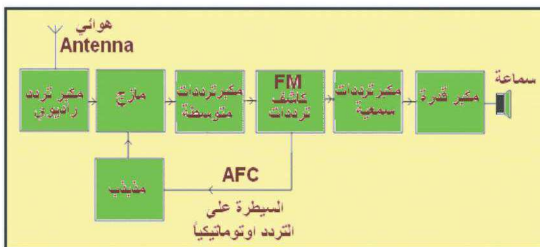
الشكل (4-34) مخطط كتلوي لجهاز راديو FM
