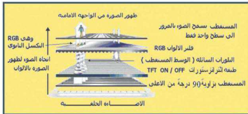
الشكل ( 6-8 ) شاشة عرض السائل المتبلور TFT
