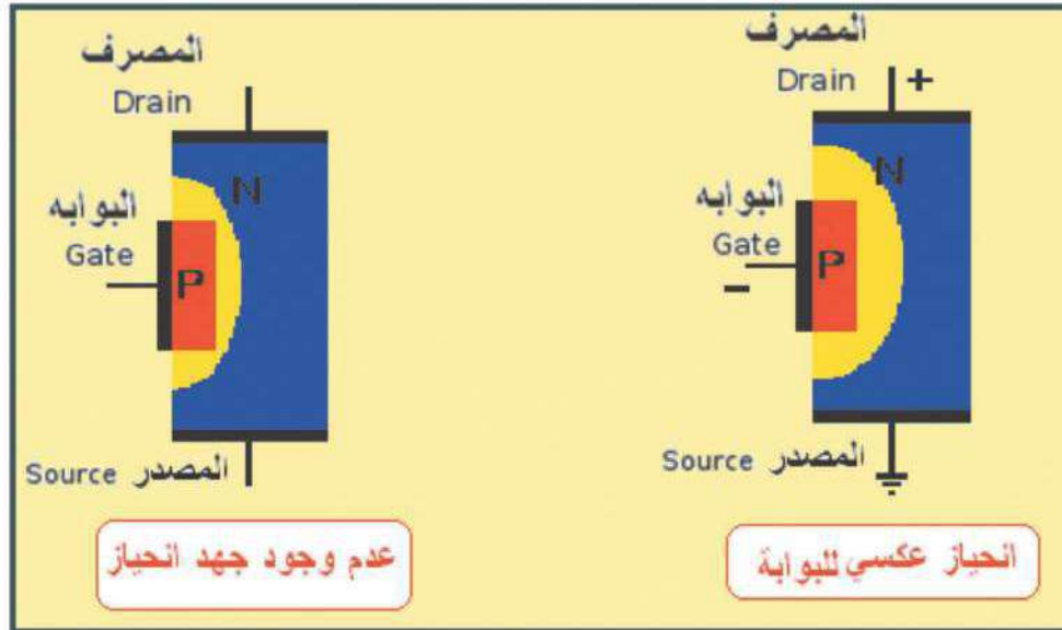
الشكل ( 4-7 ) الاتجاه الأمامي والاتجاه الخلفي لترانزستور الـ FET
