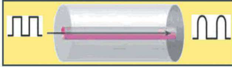
الشكل (5-21) الانتشار عبر الألياف أحادية النمط
