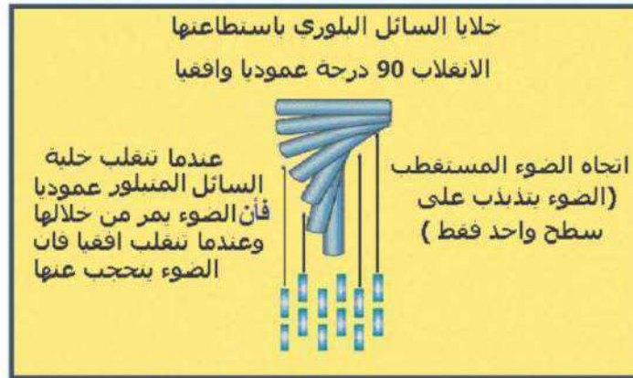
الشكل (6-7) رسم توضيحي عن الخلايا البلورية ضمن السائل البلوري
