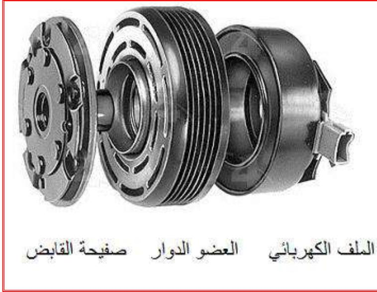
شكل 5-17 القابض المغناطيسي لضغط السيارة
