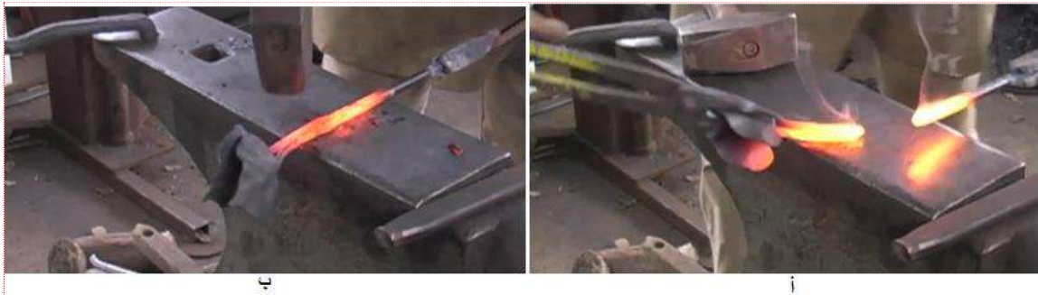
شكل 6-14 عملية لحام الحدادة للفولاذ، أ- تسخين قطع العمل للاحمرار، ب- لحام قطعتي العمل تراكيباً
