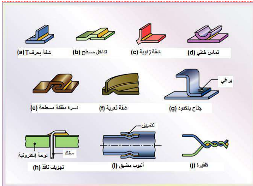
شكل 5-6 الأنواع الشائعة لوصلات القصدرة
