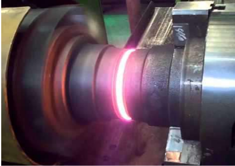
شكل 6-23 عملية لحام القصور الذاتي الاحتكاكي
