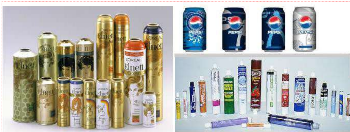
شكل 7-21 حاويات وعلب مختلفة مشكلة بالبثق الصدمي
