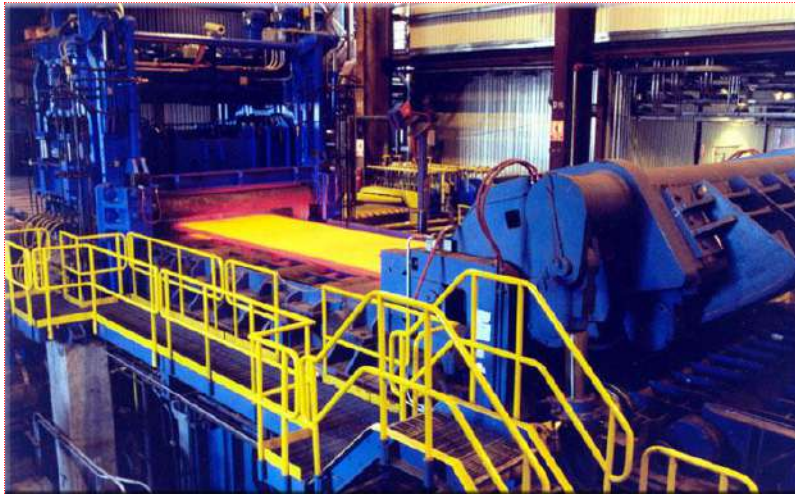
شكل 3-7 درفلة الكتل الكبيرة إلى مقاطع صغيرة على الساخن
