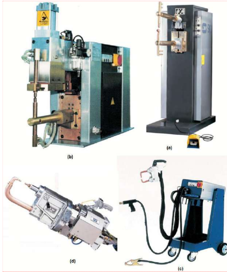
شكل 3-8 أنواع مكائن لحام المقاومة النقطي (a) مكائن الذراع المتأرجح، (b) مكائن الضغط، (c) المكائن المحمولة، (d) اليدوية
