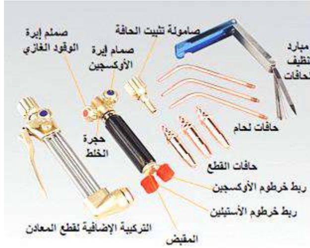
شكل 4-6 مشعل لحام الوقود الغازي وأجزائه
