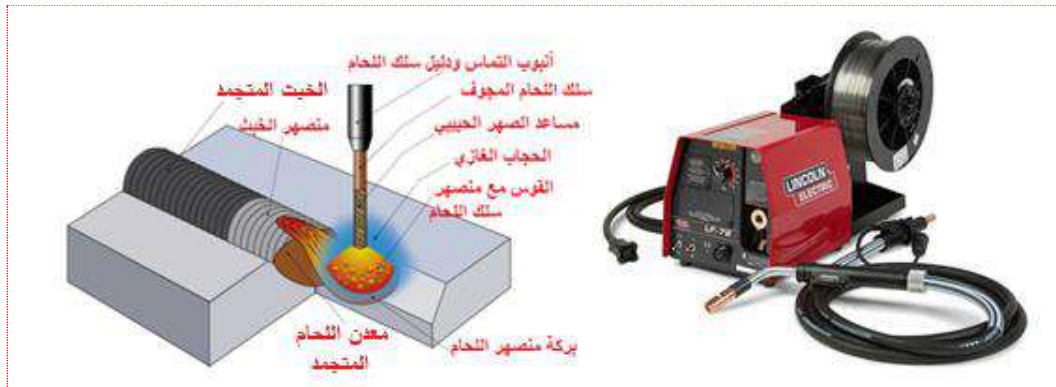
شكل 2-8 مخطط عملية اللحام بالسلك المجوف مع ماكينة اللحام
