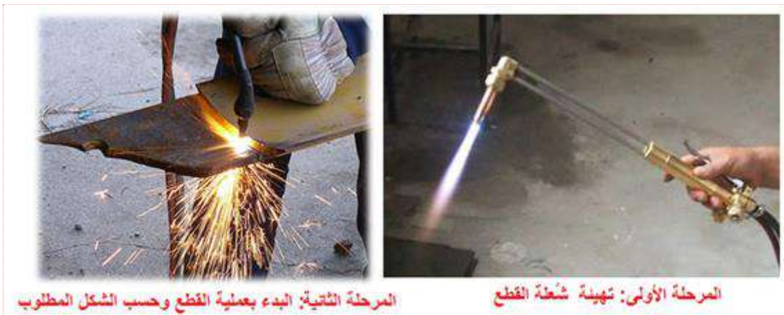
شكل 4-16 عملية قطع المعادن بالمشعل الغازي
