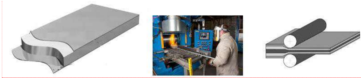
شكل 6-16 تغليف الصفائح بالدرافيل
