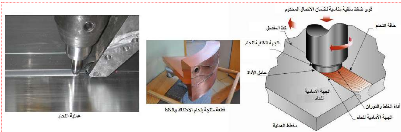
شكل 6-26 عملية اللحام بالاحتكاك والمزج بالحركة
