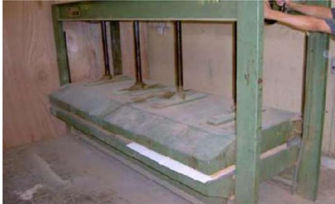
شكل رقم (3-1) يوضح اتمام عملية الكبس بالمكبس الميكانيكي
