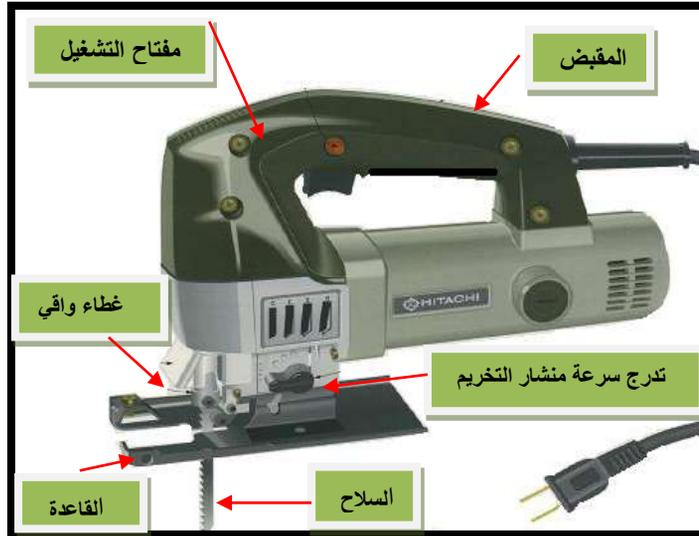
الشكل رقم (6-2) يوضح منشار التخريم اليدوي الكهربائي
