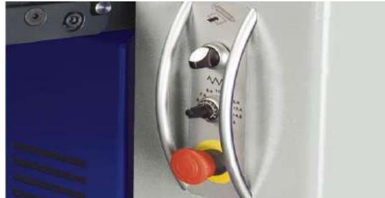
شكل (1 - 79) يوضح أزرار سرعة التغذية
