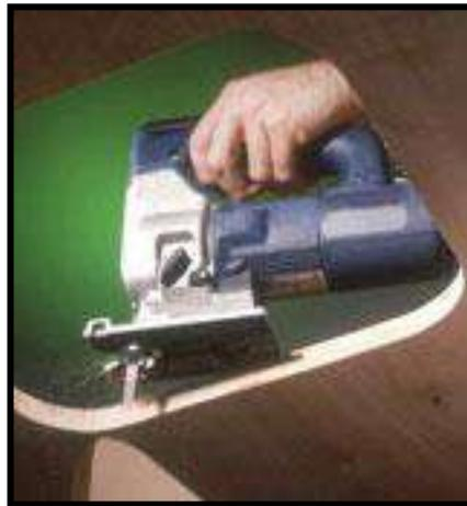
شكل رقم (10-2) يوضح عملية استخدام منشار التخريم للقطع بزواوية مائلة
