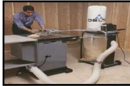
شكل رقم (2-42) يوضح طريقة الربط وشفط النشارة
