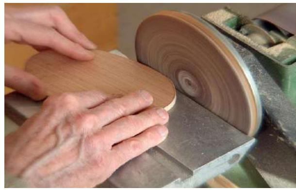
3. شكل (1 - 163) يوضح ضبط الحافات على ماكينة التنعيم الدائرية شكل (1 - 164) يوضح ضبط القطوعات المائلة تستعمل ماكينة التنعيم القرصية في ضبط المنحنيات الخارجية والأقواس والأشكال الدائرية كما في الشكل (1-165) .
