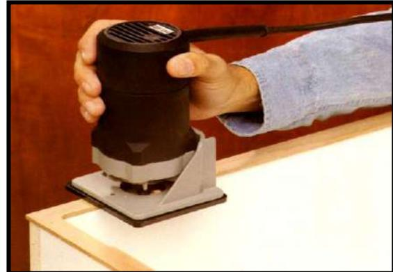
شكل رقم (2-39) يوضح عملية تسوية الحافات باستخدام الروتر
