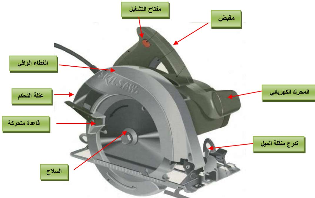
شكل (2 - 1) يوضح منشار الصينية اليدوي الكهربائي
