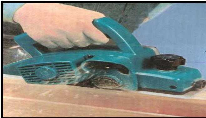
شكل رقم (2-15) عملية استخدام الرنده الكهربائية في ضبط حواف الألواح
