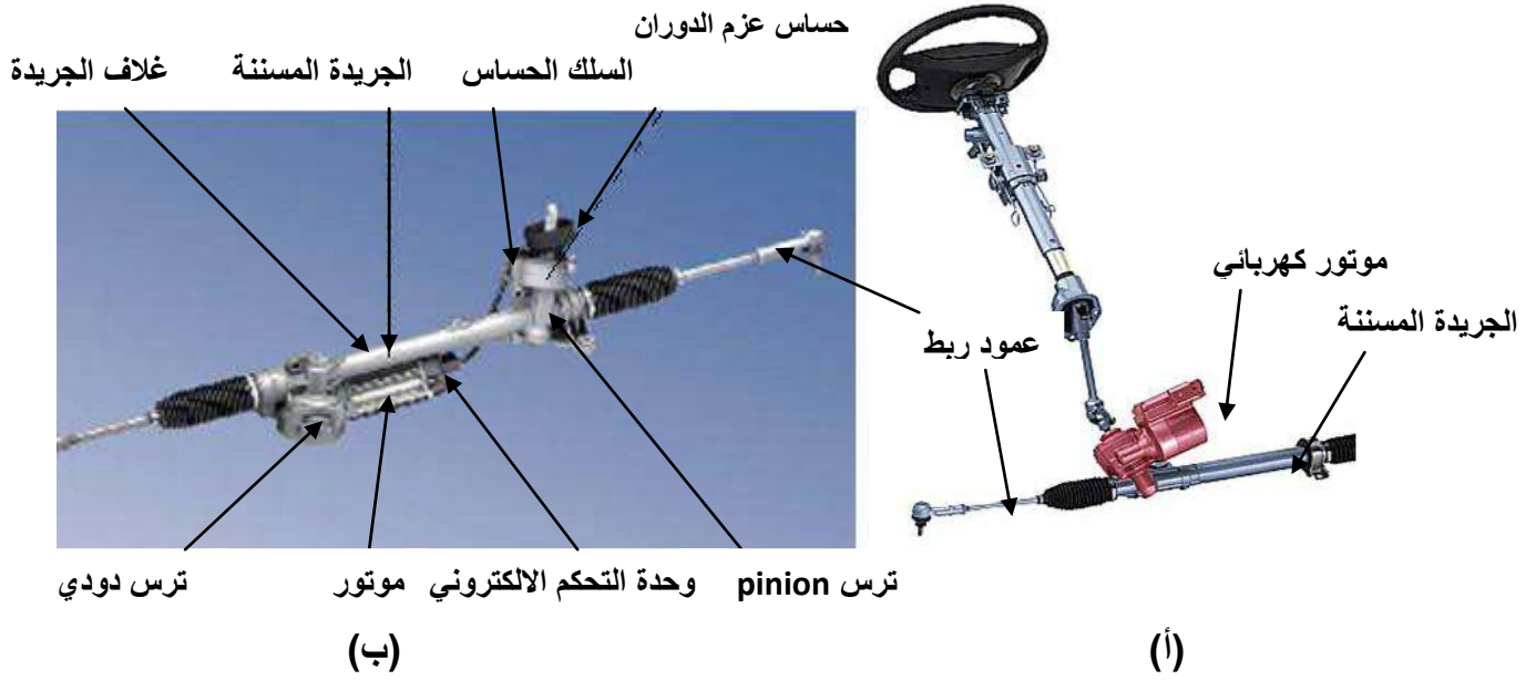
شكل ( 5- 13 ) (أ) نظام التوجيه المساعد الالكتروني نوع محرك كهربائي على الترس (Pinion)
