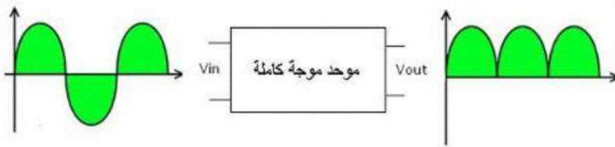
الشكل (3-5) يوضح مخطط الموحد موجة كاملة
