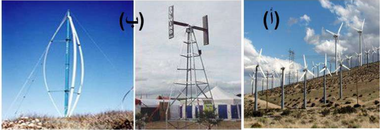
الشكل (6-3) أ- توليد الطاقة بالتوربين ذو المحور الافقي ب- توليد الطاقة بالتوربين ذو المحور العمودي
