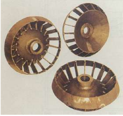
شكل 4-29 مروحة محرك كهربائي مربوطة بلحام الـ TIG
