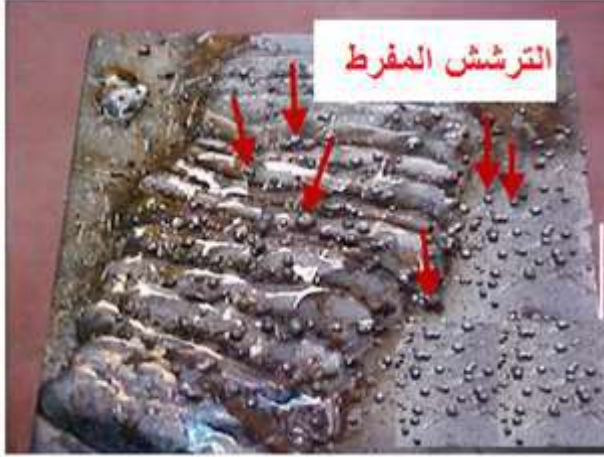
الشكل 5-13 عيب الترشش المفرط
