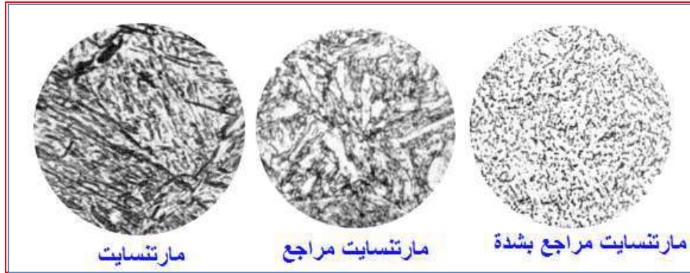
شكل 4-23 بنية المارتنسايت وبنية المارتنسايت المراجع
