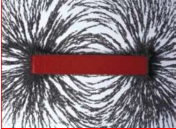
الشكل 5-24 انتظام جسيمات الحديد على خطوط القوة المغناطيسية
