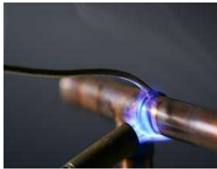
الشكل 6-7 طريقة الطلاء بالقصدير بواسطة اللهب المكشوف
