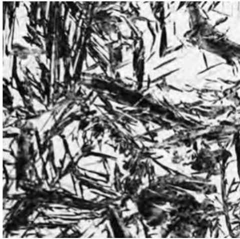
شكل 4-11 البنية المجهرية لطور المارتنسايت من سبيكة الفولاذ
