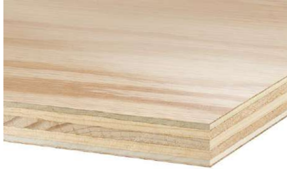
شكل (2 - 13) Plywood Panels complex (الخشب المجمع)
