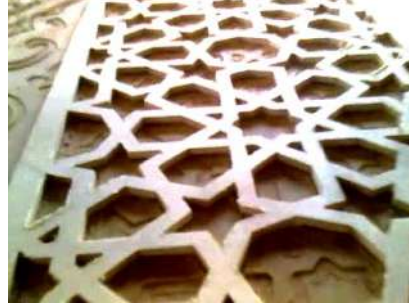
شكل (4 - 5) أعمال التفريغ على ماكينة CNC
