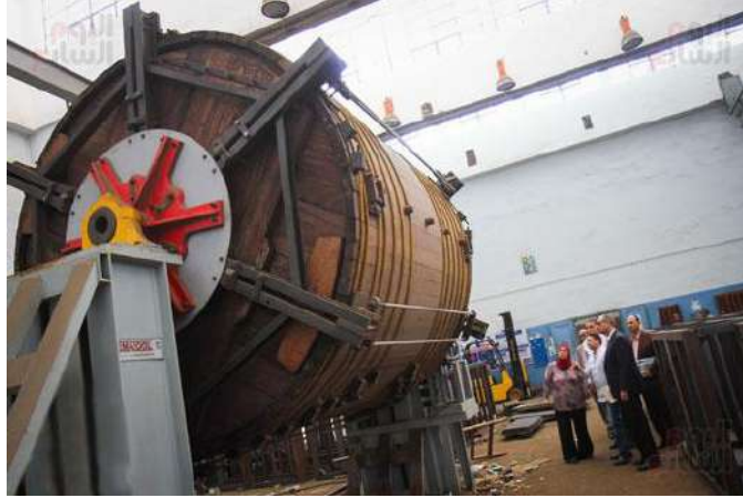
شكل (3 - 17) النواعير الخشبية لإزالة الصوف من الجلود في المرحلة الحديثة من الدباغة
