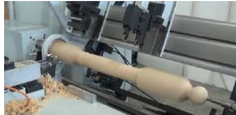
شكل (4 - 7) تنفيذ عصا اسطوانية على المخرطة الرقمية
