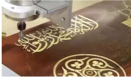
شكل (4 - 6) تنفيذ الكتابة الغائرة على ماكينة CNC
