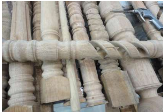
شكل (4 - 10) الأعمدة ذات التفريغ اللولبي
