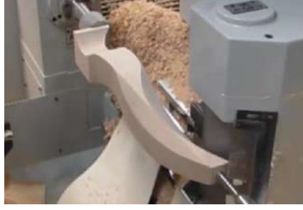
شكل (4 - 8) المخرطة الرقمية ذات الحامل الواحد
