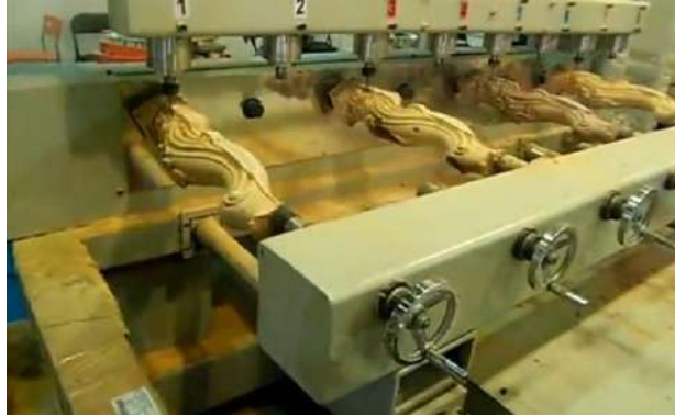
شكل (4 - 9) المخرطة الرقمية ذات الرؤوس المتعددة
