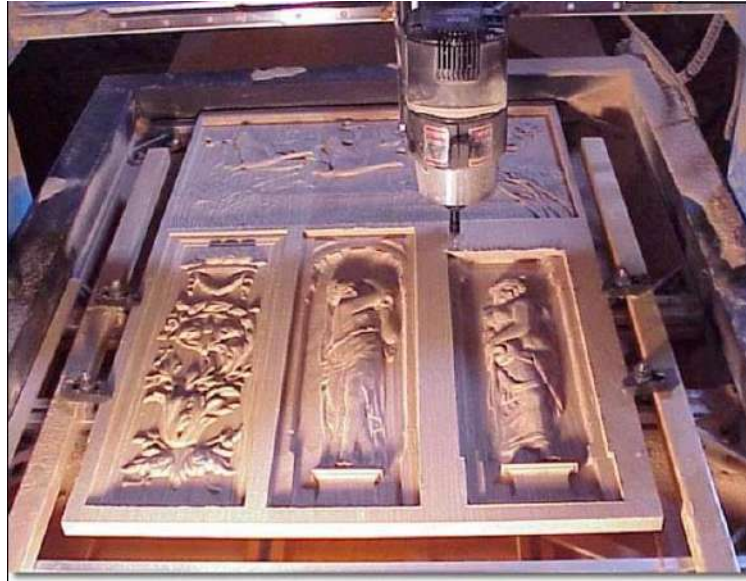
شكل (4 - 31) الحفر الثلاثي الأبعاد على ماكينة CNC Router
