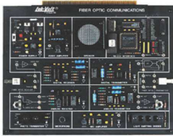
الشكل (3-7) لوحة تدريبية للإرسال والاستلام باستخدام الألياف البصرية
