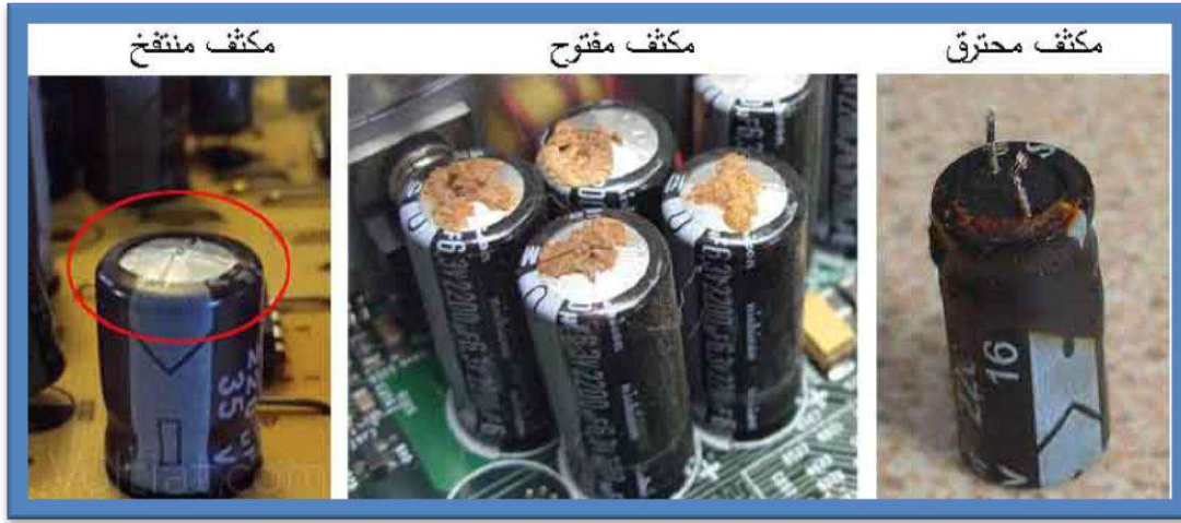
الشكل ( 3 - 8 ) انواع تلف المتسعة
