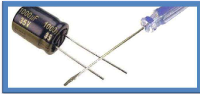
الشكل (7-3) عملية افرغ شحنة المكثف
