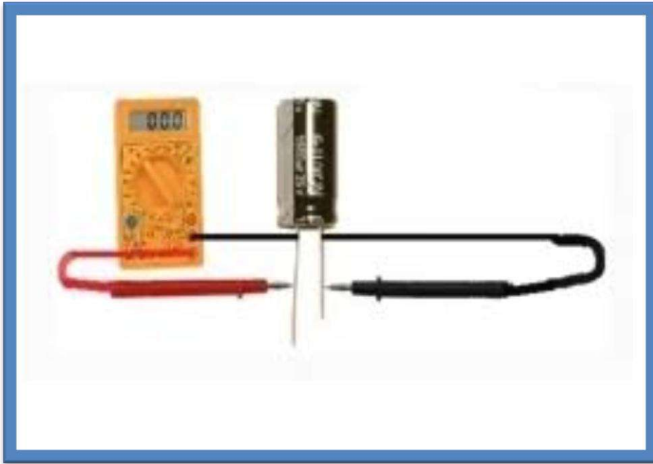
الشكل ( 8-3 ) الفحص بطريقة الاومية
