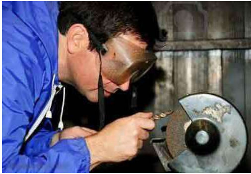
الشكل (5-26) يوضح عملية التجليخ
