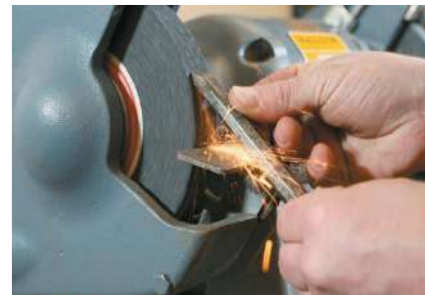
الشكل (5-27): حركة قطعة العمل أثناء عملية التجليخ.
