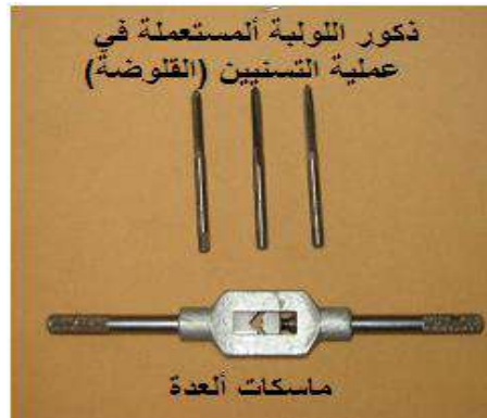
الشكل (5-34) أ- أدوات التسنيين الداخلي ب- ذكور اللولة (قلووظ)
