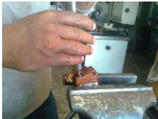
شكل (168-1) براغي تثبيت الملف الكهربائي على الحاقن
