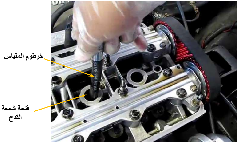
شكل ( 1-61 ) ربط خرطوم المقياس في مكان شمعة القذح او مكان حاقن (بخاخ) الوقود (محرك الديزل)
