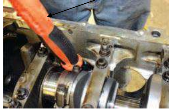
شكل (15-1) أخراج المكبس من الاسطوانة
