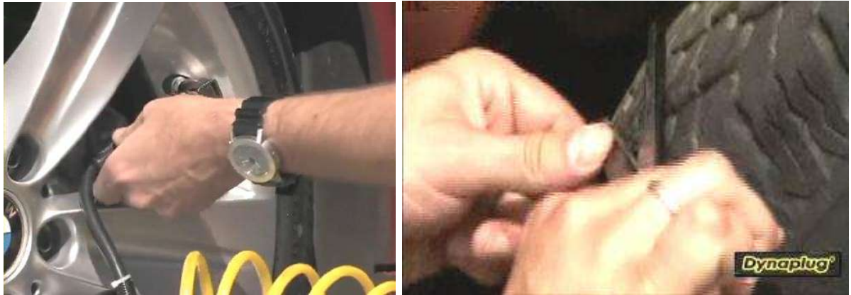
شكل ( 7-5 ) تزويد الإطار بالهواء
