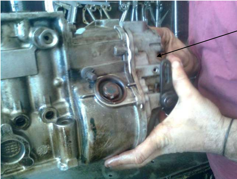
شكل (148-1) تركيب مجموعة الحاكم الميكانيكي
