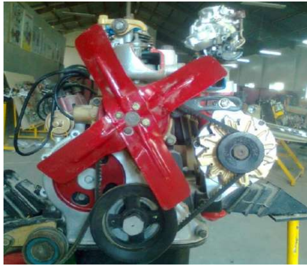
شكل (103-1) تركيب البكرات والسيور بعد اكمال تركيب غطاء مسننات التوقيت
