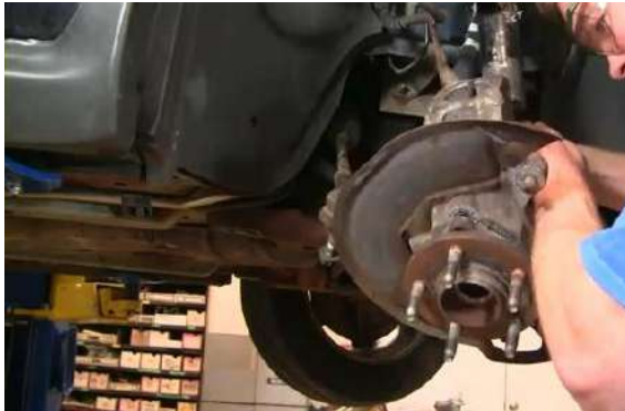
شكل (56-3) تعليق الموقف في مكان مناسب شكل (57-3) افتح اللوالب المثبتة لسرّة العجلة في الحامل
