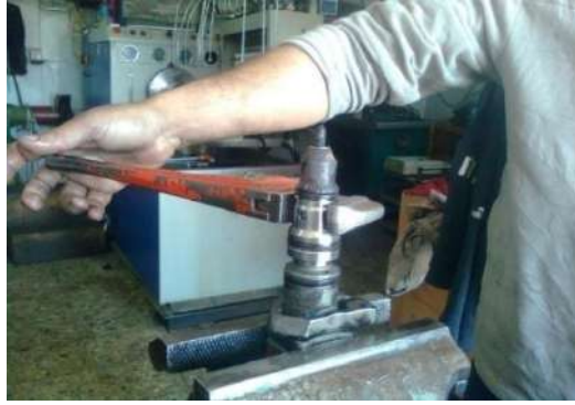
شكل (1-158) فتح الحاقن الكهربائي
