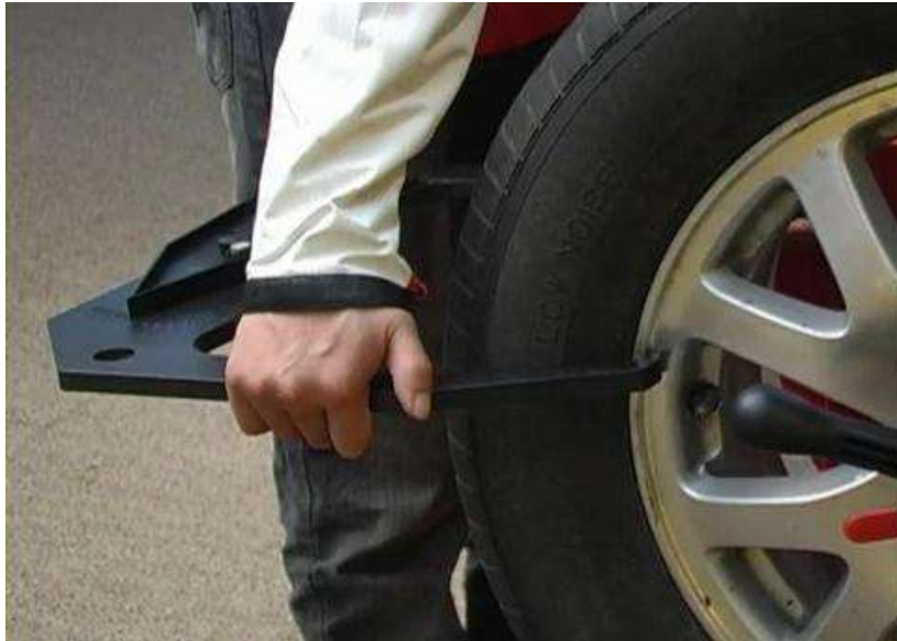
شكل (109-4) قياس عرض الاطار المعدني من الشفة الداخلية للإطار إلى الشفة الخارجية
