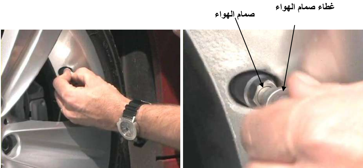
شكل (5-15) أخرج الهواء الزائد
