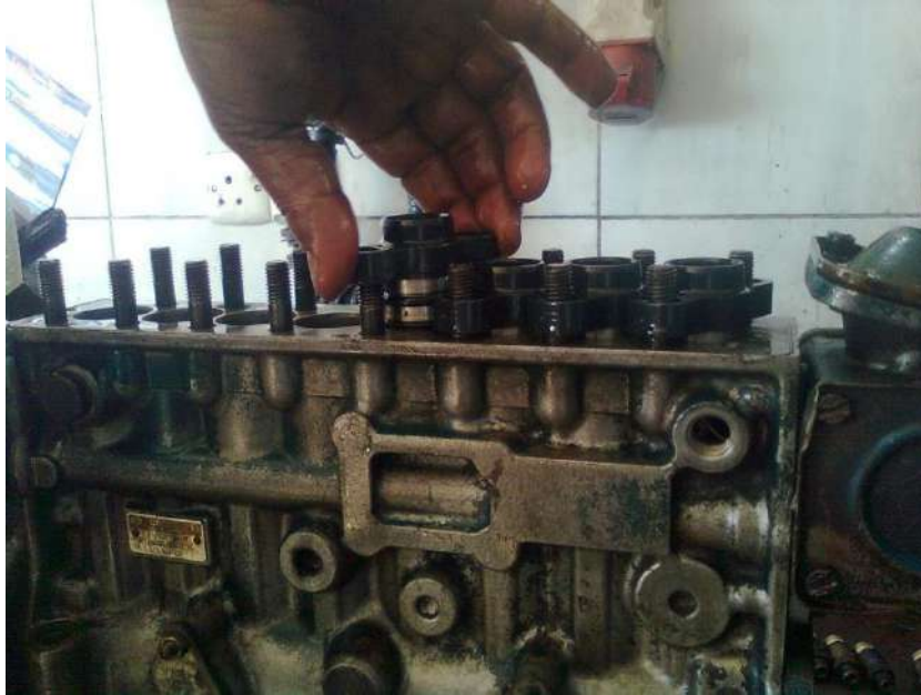
شكل (144-1) تثبيت مجموعة الكباس على جسم المضخة
