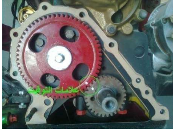
شكل (102-1) تعشيق المسننين عند تقابل العلامات
