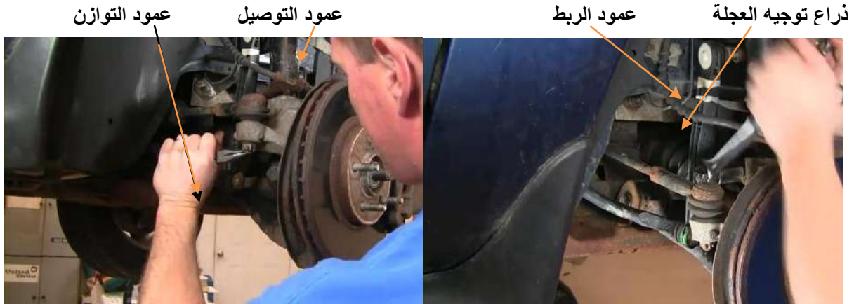
شكل (3-51) لولب ربط تثبيت حامل العجلة مع القائم
