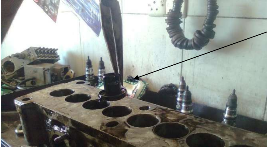
شكل (138-1) استخراج دليل الكباس
