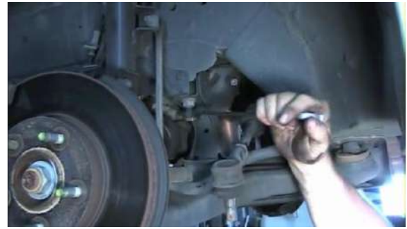
شكل ( 39-4 ) فتح لوالب ربط جهاز الاستدارة بالإطار المعدني شكل ( 40-4 ) نزع جهاز التوجيه.
