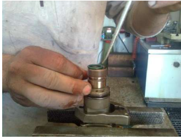
شكل (163-1) تركيب الواشر المطاطي ( مانع التسرب )
