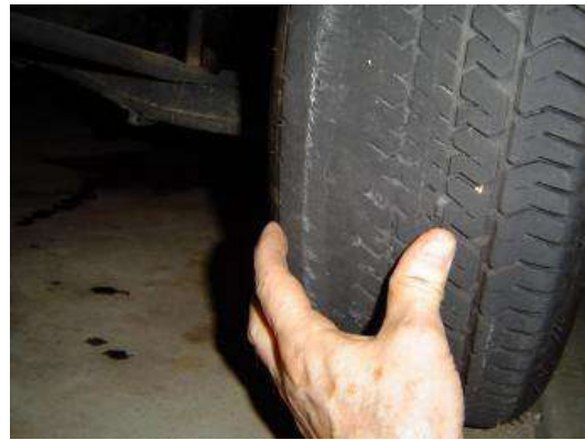
شكل (4-102) فحص الإطار المطاطي من وجود الشقوق
