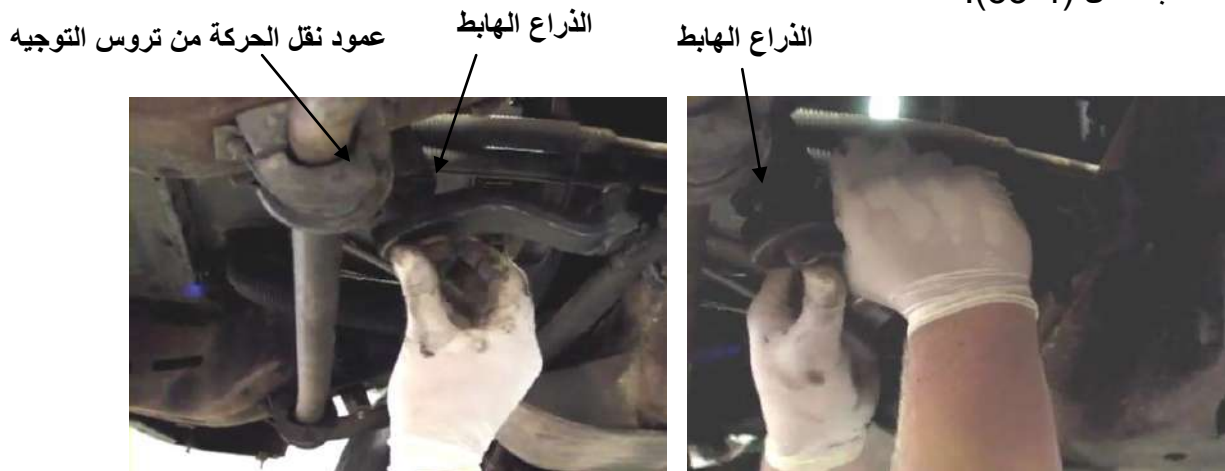
شكل ( 51-4 ) تركيب الذراع الهابط في مكانه شكل (52-4) إدخال الصامولة باليد
