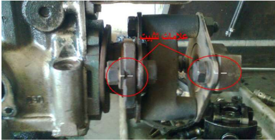
شكل (132-1) تأشير وصلة تدوير مضخة الحقن (الكوبلن)
