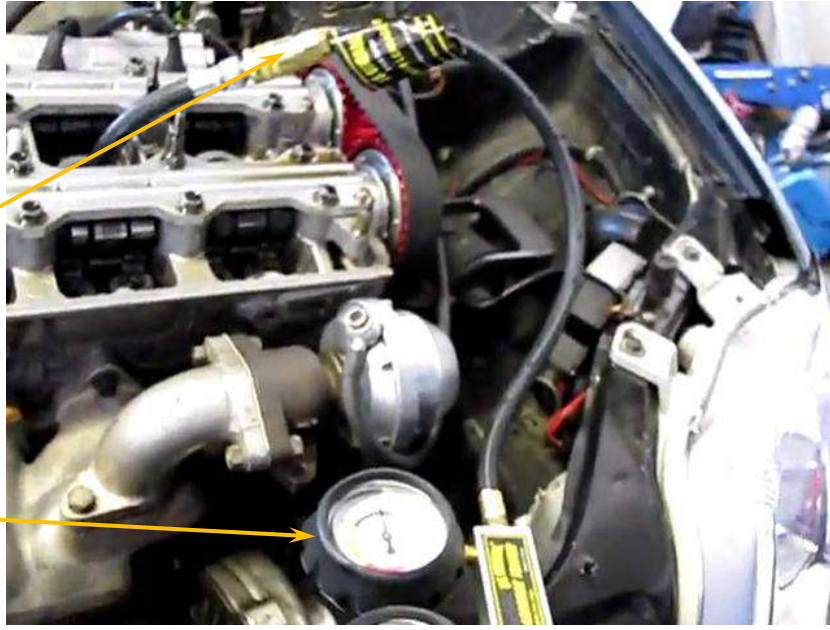
شكل ( 62-1 ) وصل الخرطوم بالمقياس
