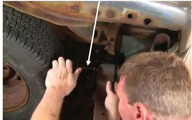
شكل ( 10-3 ) وضع اللولب في مكانه في عين النابض شكل ( 11-3 ) شد الصامولة باليد
