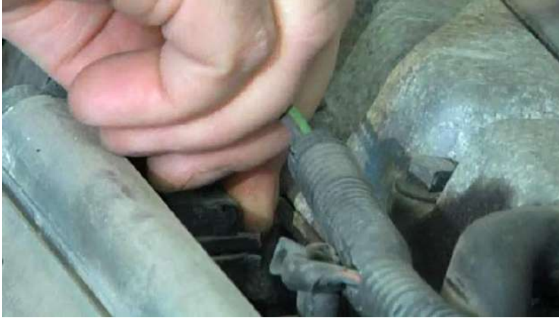
شكل (1-198) فصل (الفيشة) الكهربائية للحاقن (البخاخ)
