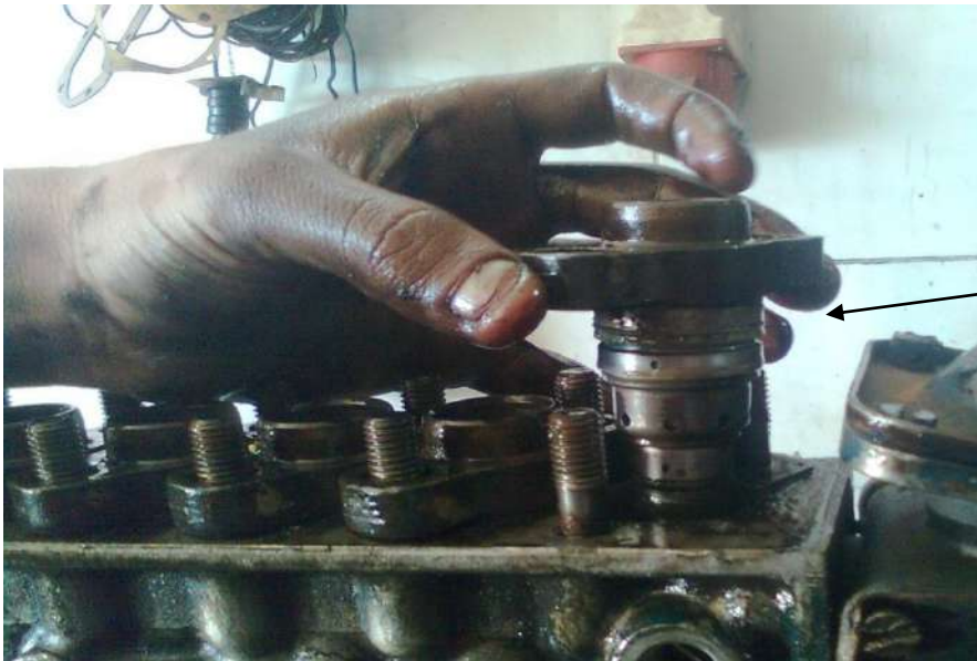
شكل (139-1) استخراج مجموعة الكباس
