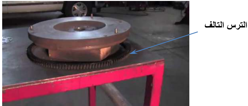
شكل (70-1) فصل الترس عن الحذافة
