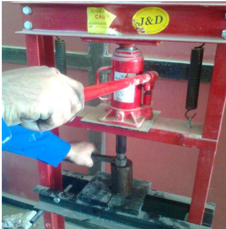
شكل (24-1) الضغط على الجلبة الجديدة بالتدرج لتركيبها على ذراع التوصيل
