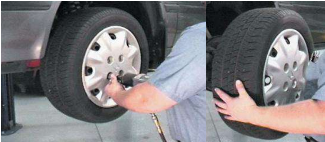
شكل (21-2) فتح لولب تثبيت العجلة في المركبة
