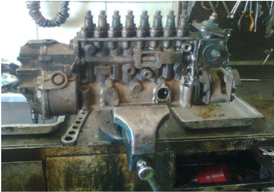
شكل (1-127) تهيئة مضخة الحقن على منضدة العمل
