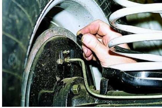
شكل (2-41) تركيب الغطاء المطاطي للولب التنفيس
