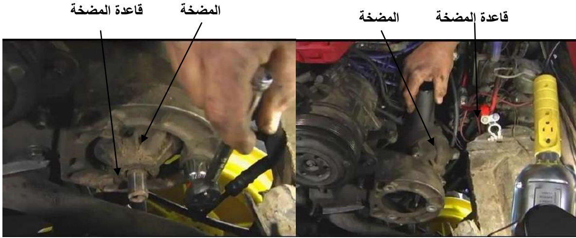
شكل ( 69-4 ) فتح لوالب تثبيت المضخة من قاعدتها شكل ( 70-4 ) رفع المضخة من مكانها.
