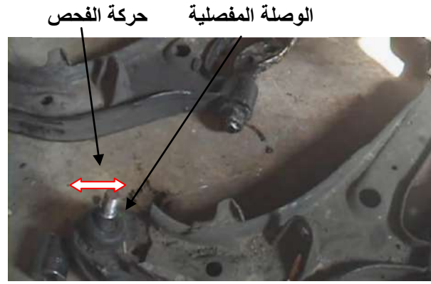
شكل (3-86) فحص الوصلة المفصليّة
