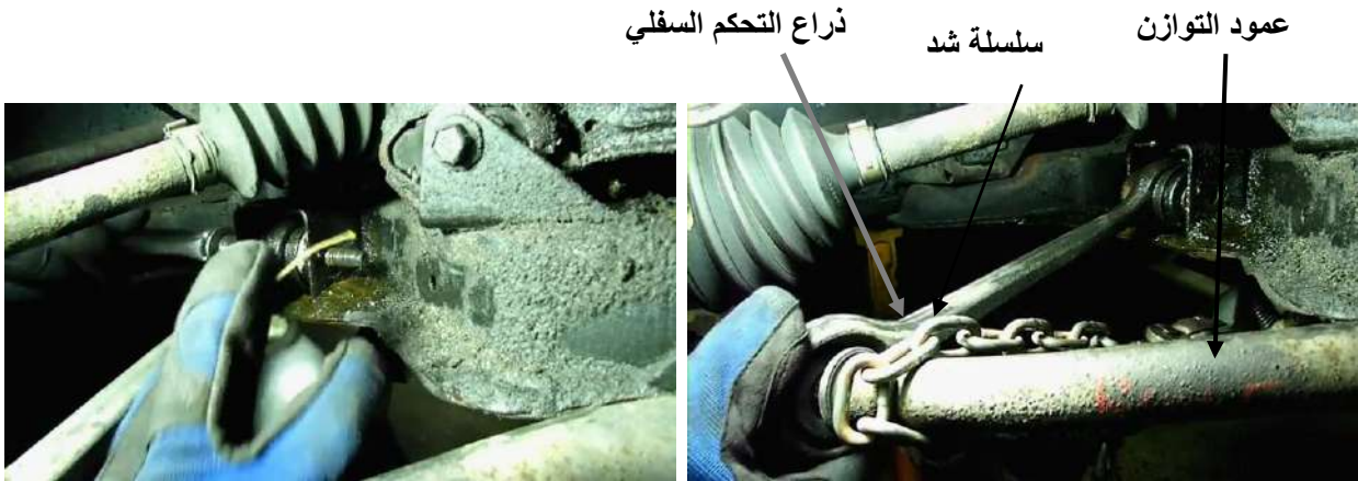
شكل (38-3) فك برغي ربط ذراع التحكم السفلي بهيكل المركبة
