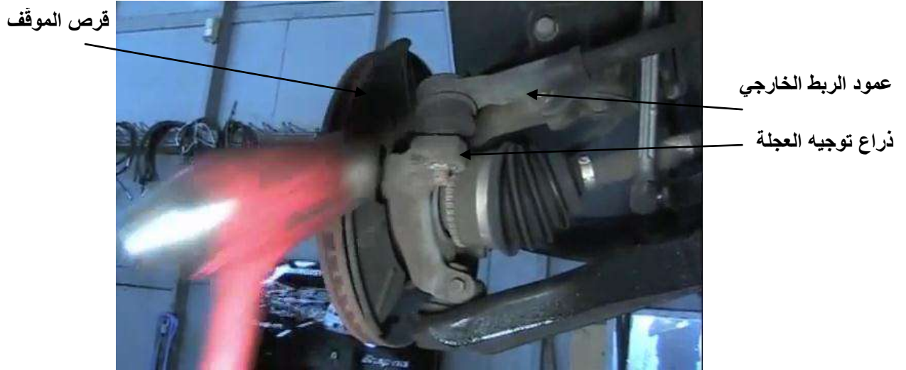
شكل (4-34) الطَّرْق على ذراع التوجيه
