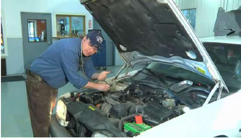
شكل (1-199) اختفاء الصوت الناتج من عمل الحاقن ( البخاخ)
