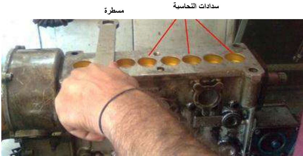
شكل (1-150) استخدام المسطرة في تثبيت السدادات النحاسية
