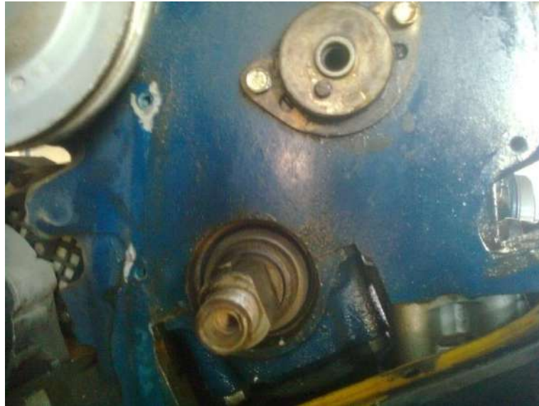
شكل (1-107) رأس المحور القلاب عندما يكون المكبس رقم (1) في ن.م.ع
