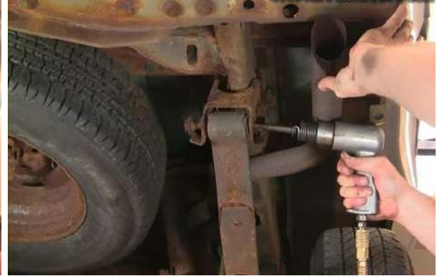
شكل ( 8-3 ) دفع اللولب بمطرقة تعمل بالهواء المضغوط
