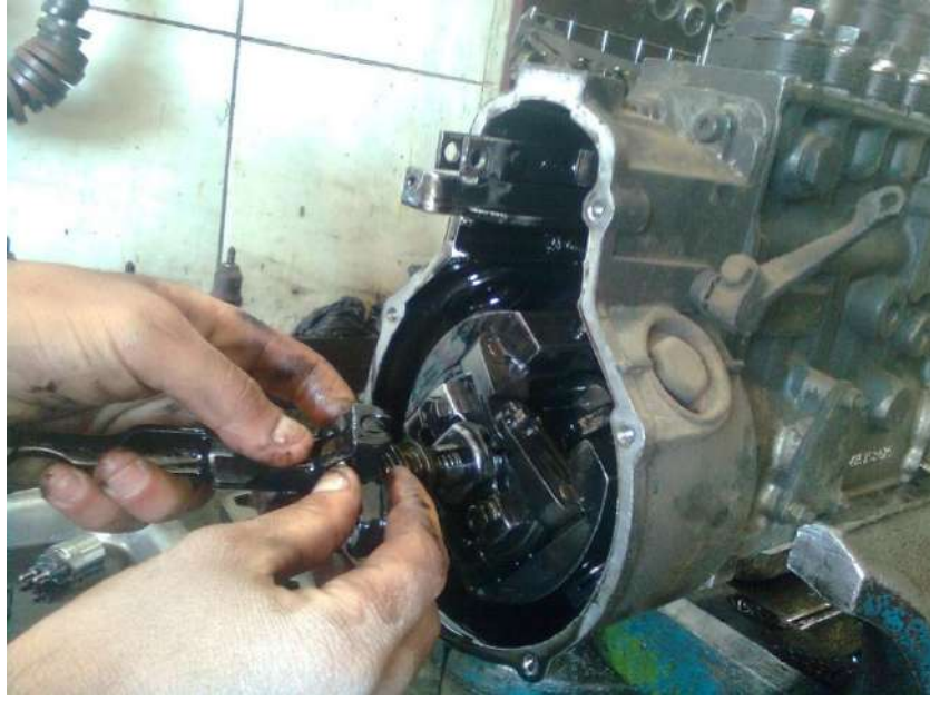
شكل (128-1) نزع غطاء الحاكم وفصل (العتلات) الوصلات الميكانيكية
