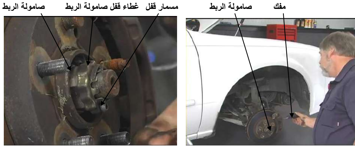
شكل (93-3) منع حامل العجلة من الحركة بوضع المفك شكل (94-3) مسمار قفل الصامولة
