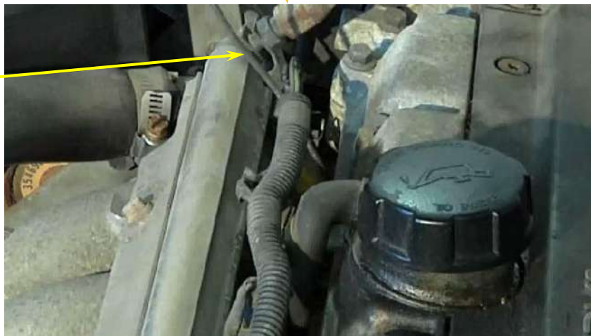
شكل (1-197) وضع أنبوبة السماعة على الحاقن(البخاخ)
