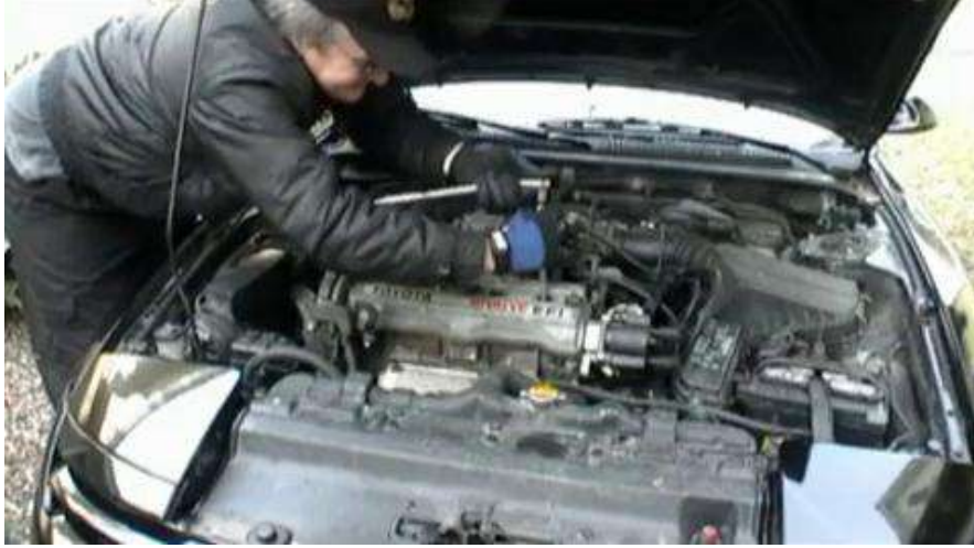
شكل (1-48) فك شمعات القدح او حاقتات الوقود (محرك الديزل)
