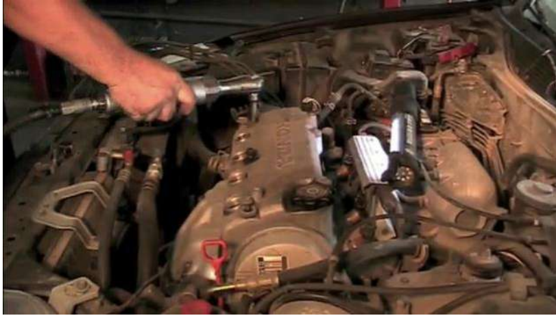
شكل (77-1) فك لواب تثبيت غطاء الصمامات
