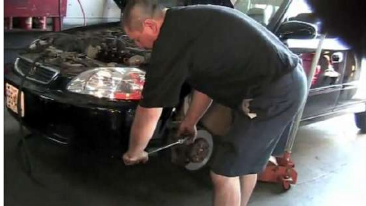
شكل (1-86) تدوير عمود المرفق لضبط خلوص الصمامات الأخرى
