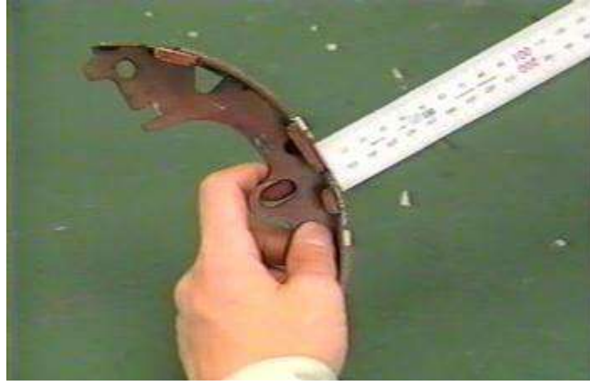
شكل (2-31) قياس بطانة الاحتكاك لحذاء الموقف
