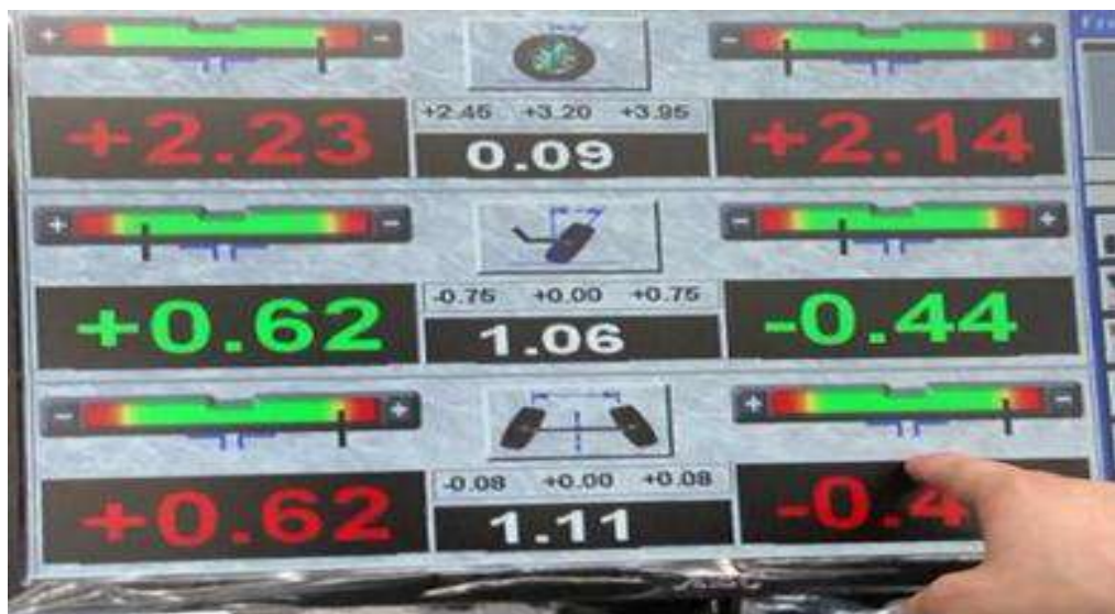
شكل (101-4) تحدد نوع الزاوية لعمل الصيانة
