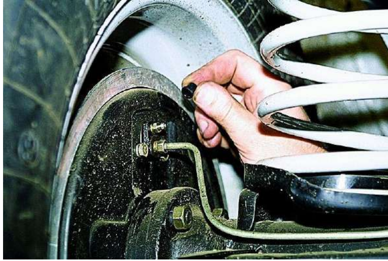
شكل (2-35) فتح الغطاء المطاطي للولب التنفيس
