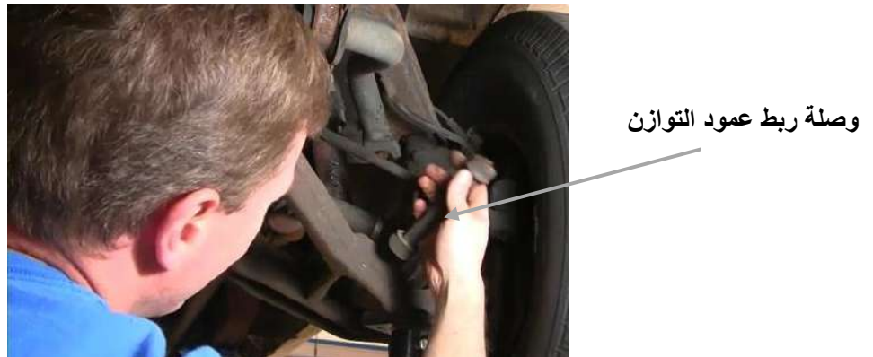
شكل ( 27-3 ) نزع وصلة الطرف الآخر
