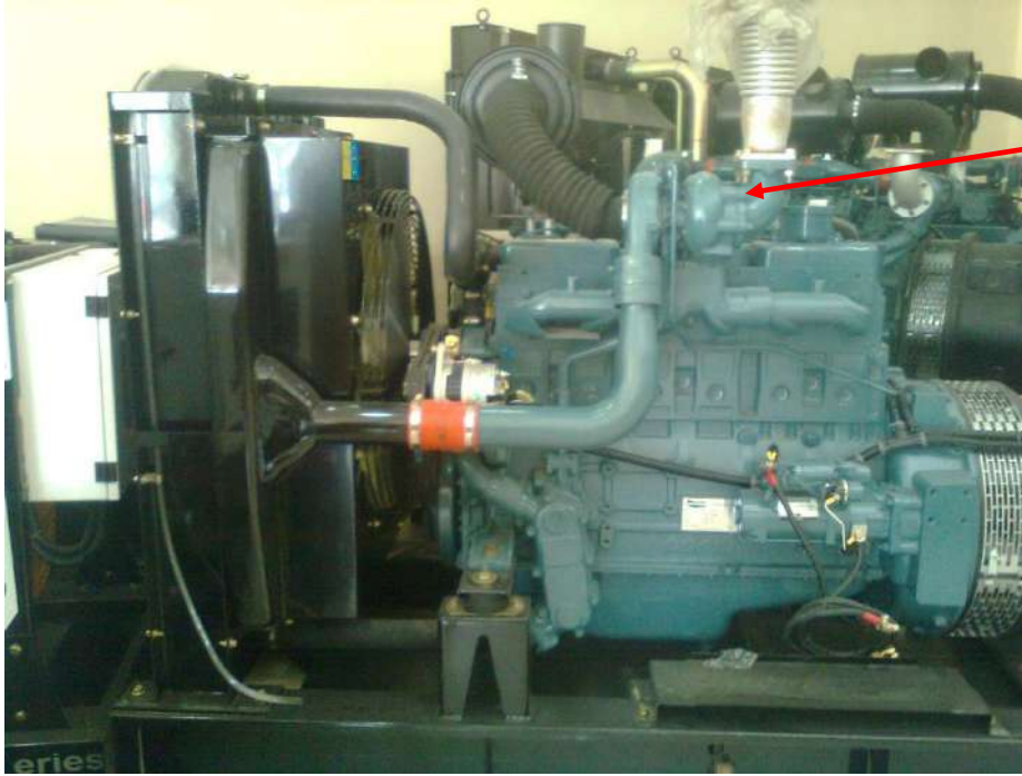
شكل (120-1) منظومة تبريد هواء الدخول الى المحرك
