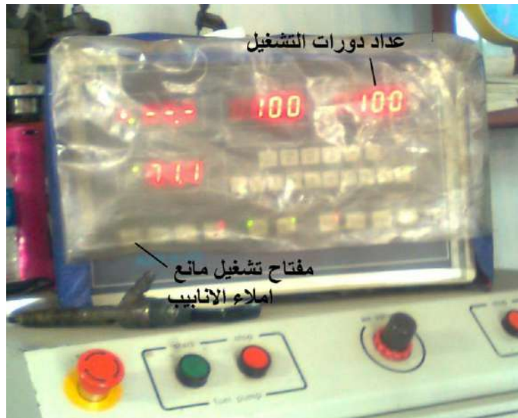
شكل (172-1) تشغيل جهاز الفحص على السرعة الحياضية 100 دورة/ دقيقة
