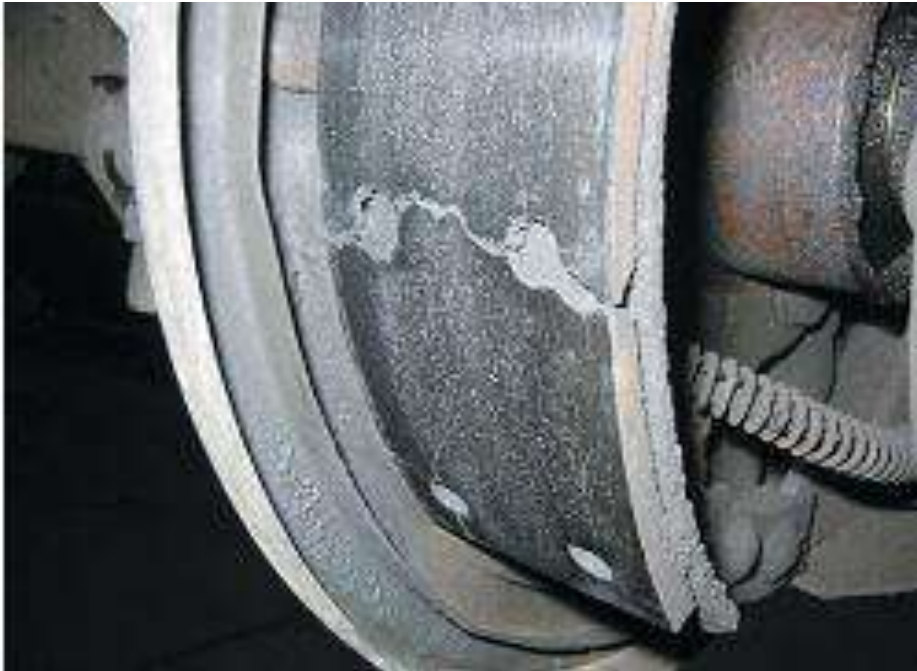
شكل (2-34) تآكل بطانة الاحتكاك لموقف الهلالي
