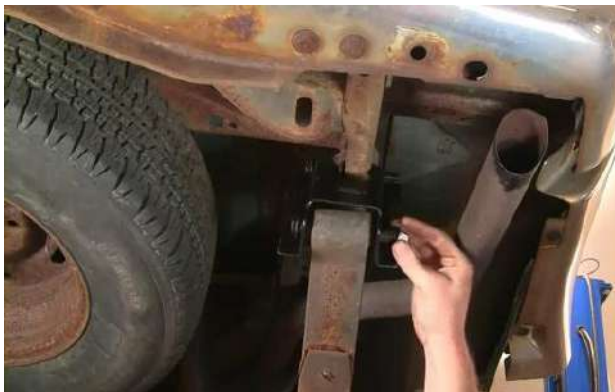
شكل ( 10-3 ) وضع اللولب في مكانه في عين النابض شكل ( 11-3 ) شد الصامولة باليد
