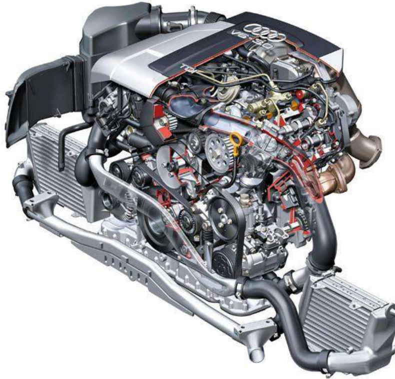
شكل (98-1) محرك ديزل يستخدم السير المطاطي المسنن في ادارة مسننات التوقيت
