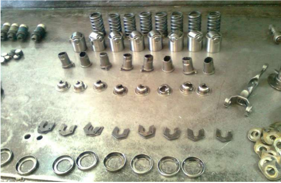
شكل (140-1) وضع الأجزاء بالترتيب بعد غسلها
