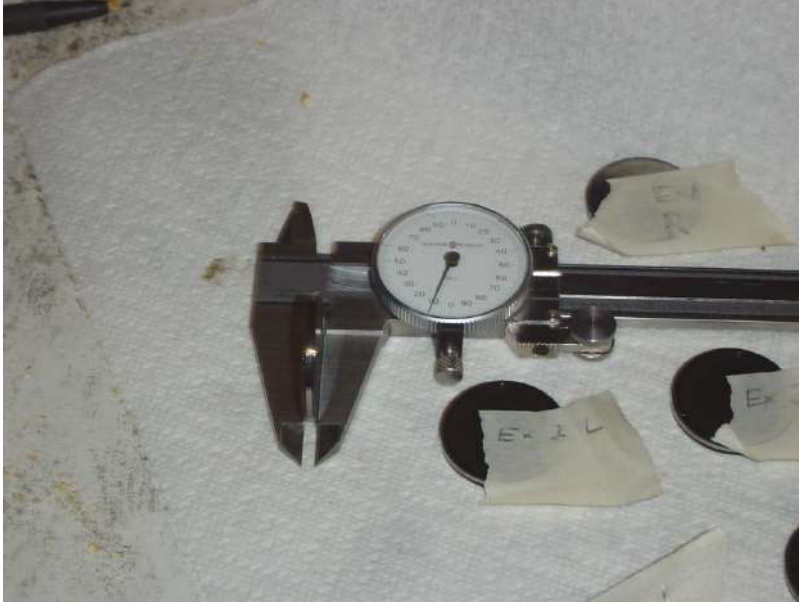
شكل (91-1) قياس سمك القرص المنزوع ومن ثم ترقيمه
