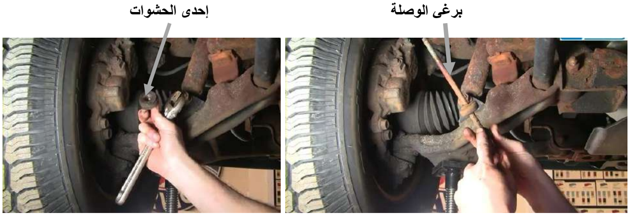
شكل ( 25-3 ) اخرج اللولب من مكانه شكل ( 26-3 ) فحص الحشوة
