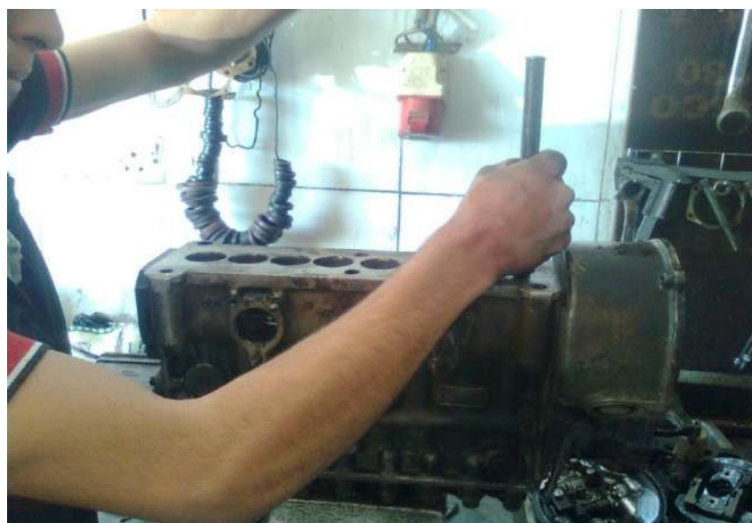
شكل (135-1) اخراج السدادات النحاسية
