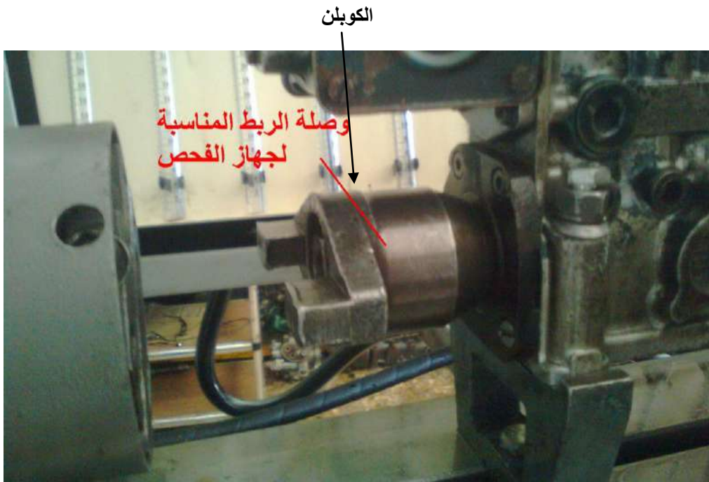
شكل (152-1) تركيب وصلة الربط المناسبة لجهاز الفحص
