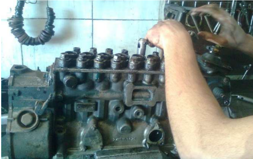
شكل (1-130) تعليق الكباس
