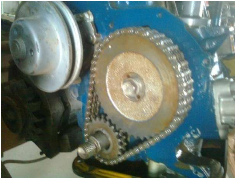
شكل (105-1) إزالة غطاء مسننات التوقيت بالسلاسل
