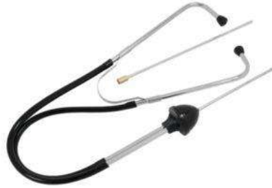
شكل (1-196) سماعة الفحص لتشخيص أعطال المحرك
