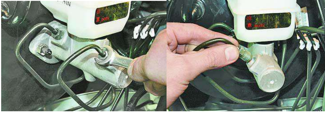
شكل (9-2) فتح الانابيب المتصلة بالاسطوانة الرئيسية للموقف
