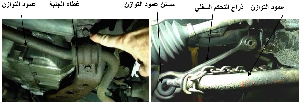
شكل ( 3-41 ) انزع ذراع التحكم السفلي من مكانه شكل ( 3-42 ) براغي غطاء الجلبة المطاطية
