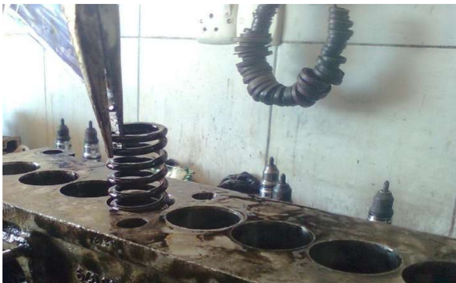
شكل (137-1) استخراج النوايض
