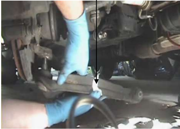
شكل (3-82) نزع ذراع التحكم السفلي الامامي من مكانه
