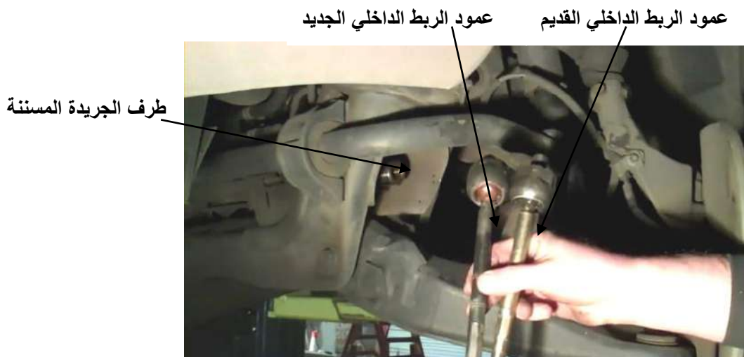
شكل ( 25-4 ) نزع عمود الربط من مكانه وإحضار عمود ربط جديد
