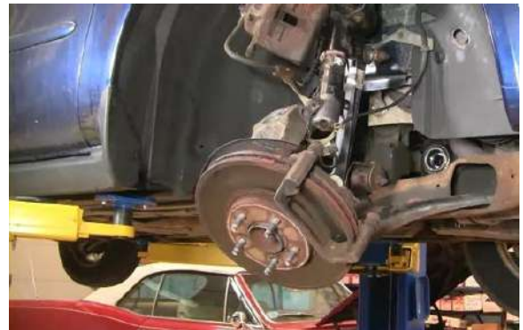
شكل (56-3) تعليق الموقف في مكان مناسب شكل (57-3) افتح اللوالب المثبتة لسرّة العجلة في الحامل
