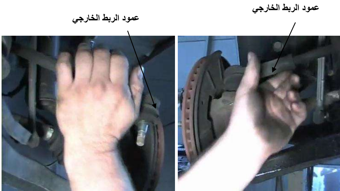
شكل (4-36) نزع عمود الربط الخارجي
