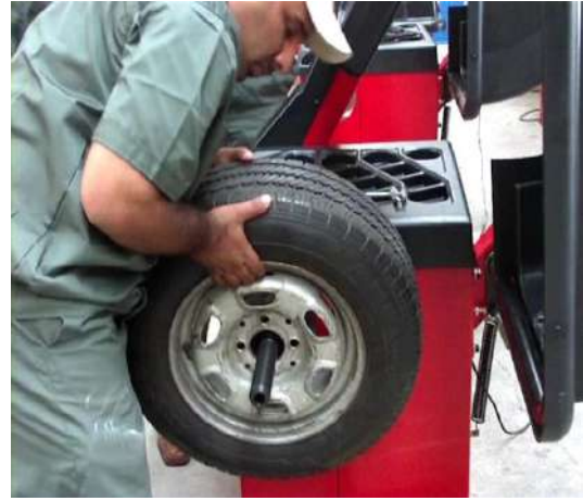
شكل (4-104) وضع العجلة المراد موازنتها في جهاز موازنة
