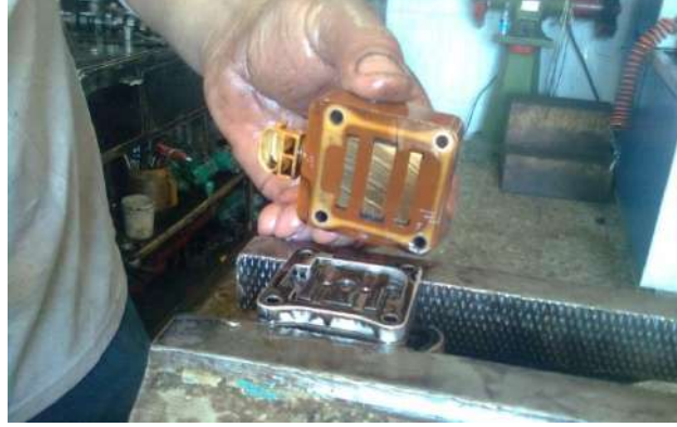
شكل (161-1) فتح المغناطيس الكهربائي للحاقن
