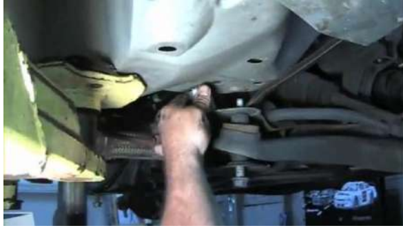
شكل ( 39-4 ) فتح لوالب ربط جهاز الاستدارة بالإطار المعدني شكل ( 40-4 ) نزع جهاز التوجيه.
