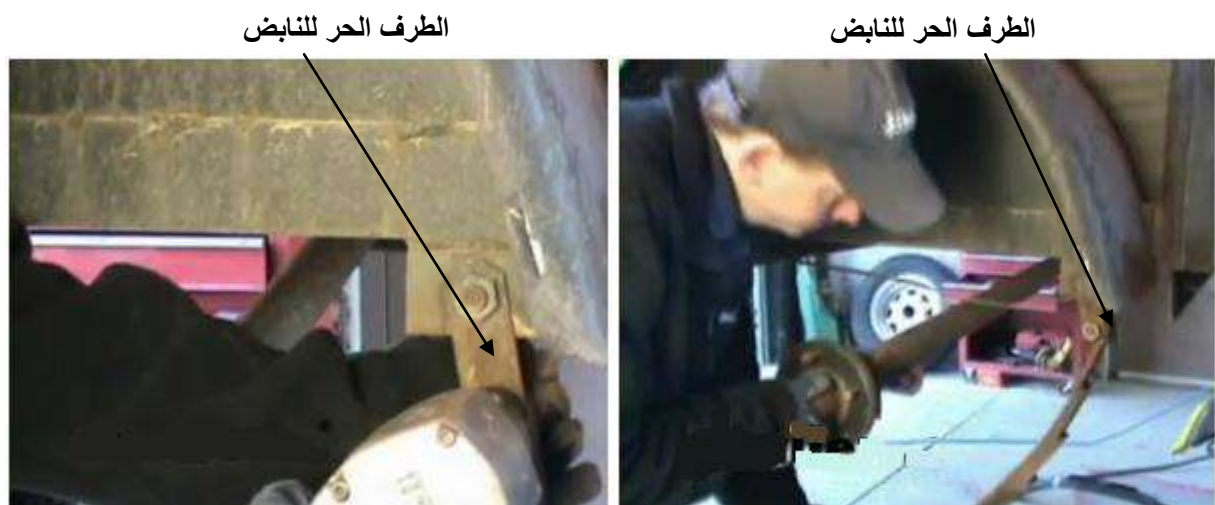
شكل ( 19-3 ) فتح صامولة لولب ربط النابض الطرف الحر
