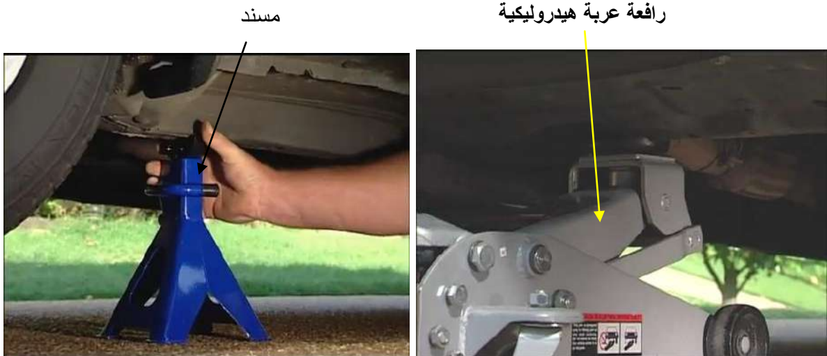
شكل (3-92) وضع المسند تحت السيارة
