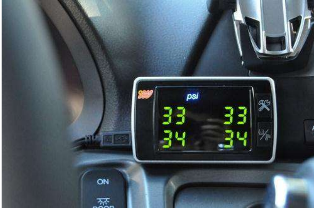
الشكل ( 5-24 ) تثبيت شاشة جهاز مراقبة ضغط الإطارات ودرجة حرارته على لوحة المقاييس (الدشبول) أمام السائق
