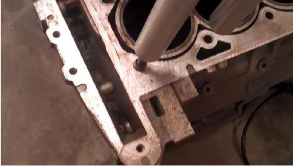
شكل (31-1) تثبيت برغي التثبيت على كتلة الاسطوانات
