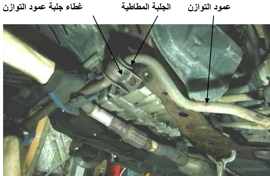
شكل ( 3-43 ) نزع عمود التوازن من مكانه
