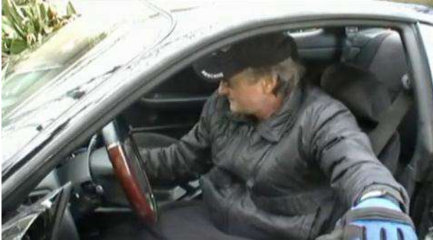
شكل (1-51) تدوير المحرك مع الضغط على دواسة الوقود
