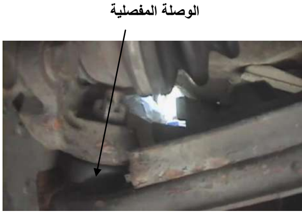
شكل (3-87) الوصلة المفصليّة تربط الذراع بحامل العجلة
