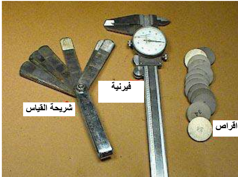
شكل (1-87) الأدوات المستعملة لضبط الخلوص
