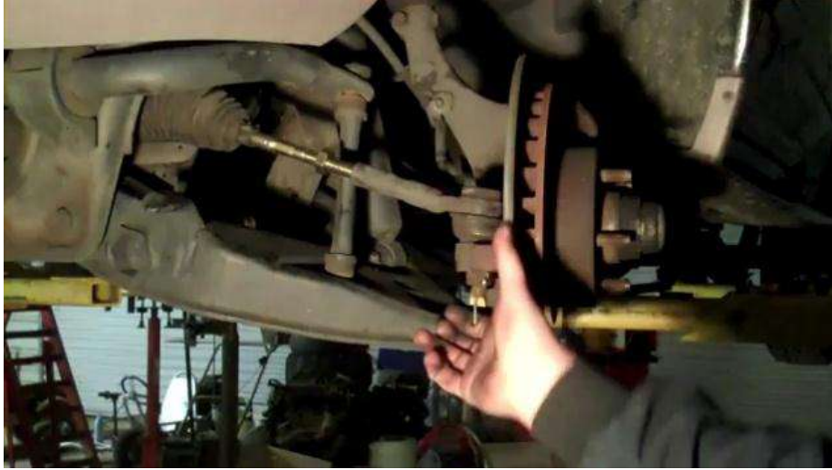
شكل ( 30-4 ) إدخال المسمار المفلوق
