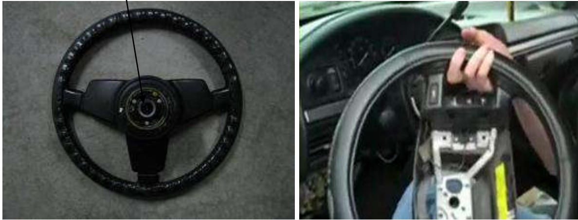
شكل (4-7) اخرج عجلة القيادة شكل (4-8) فحص حزوز وسط العجلة وباقي أجزائها
