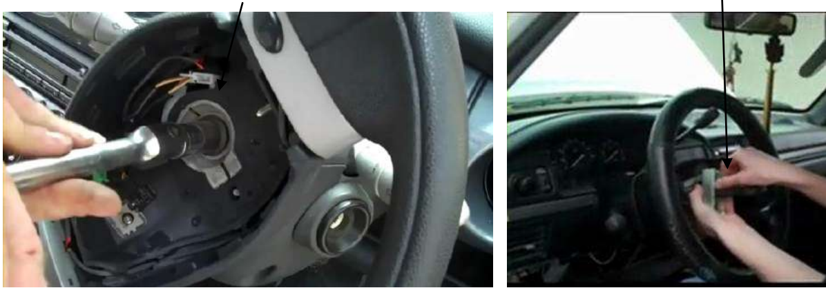
شكل (4-5) وضع فخّة السحب شكل (4-6) إدارة لولب تثبيت عجلة القيادة بواسطة المفتاح
