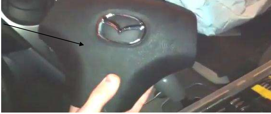
شكل ( 4- 79 ). وضع غطاء عجلة القيادة الجديد الذي يحتوي على كيس الهواء
