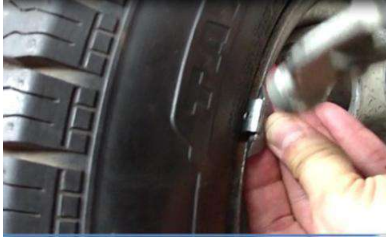
شكل (4-112) تثبيت الرصاص بطرق حسب القيمة المعطاة
