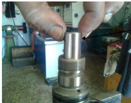
شكل (164-1) تركيب المكبس في جسم الحاقن
