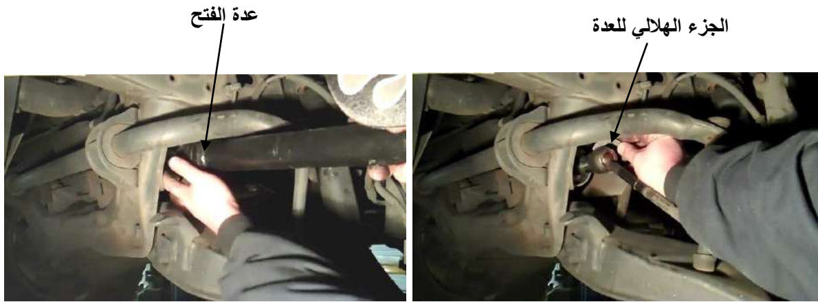
شكل ( 23-4 ) تركيب الجزء الهلالي للعدة على صامولة المفصل شكل ( 24-4 ) فتح صامولة المفصل
