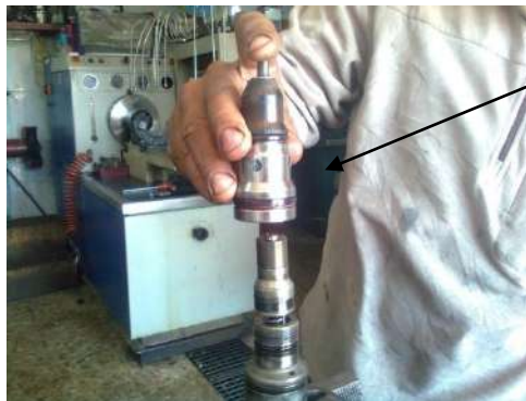
شكل (167-1) إعادة تركيب الحاقن الكهربائي
