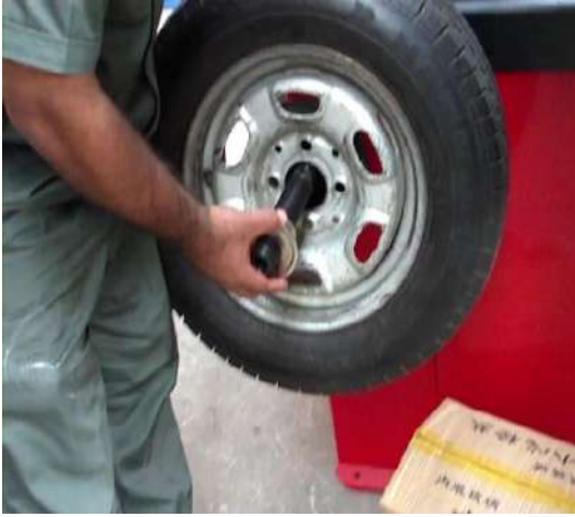
شكل (4-105) وضع قطعة حديدية بقطر مناسب
