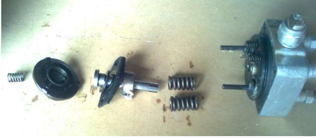
شكل (156-1) تفكيك موزع الوقود
