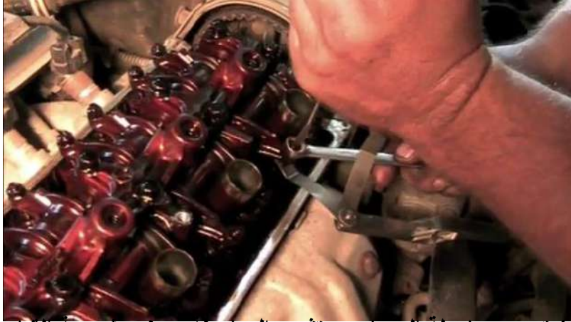
شكل (1-85) تدوير صامولة الصمام مع تثبيت الصامولة ووضع شريحة القياس لغرض المعايرة
