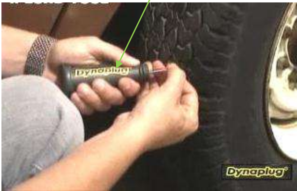
شكل (3-5) تحميل العدة بالحشوة
