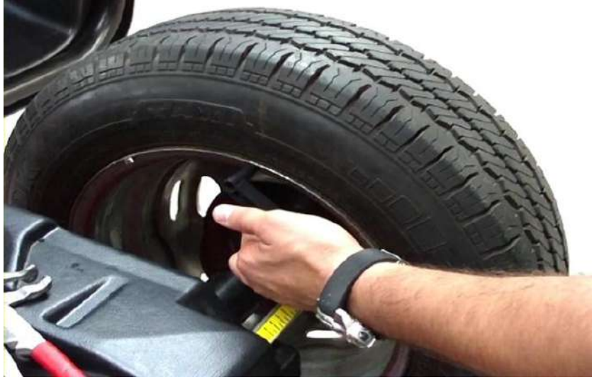
شكل (108-4) سحب مسطرة القياس في الجهاز إلى شفة الإطار المعدني وقم بأخذ القياس
