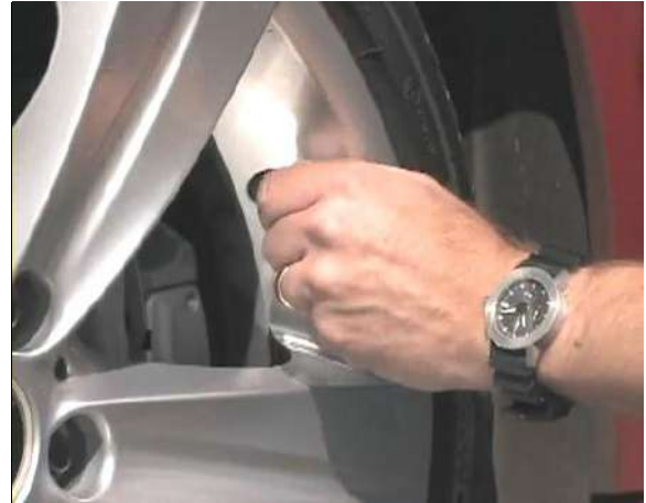
شكل (8-5) فك غطاء صمام الهواء.
