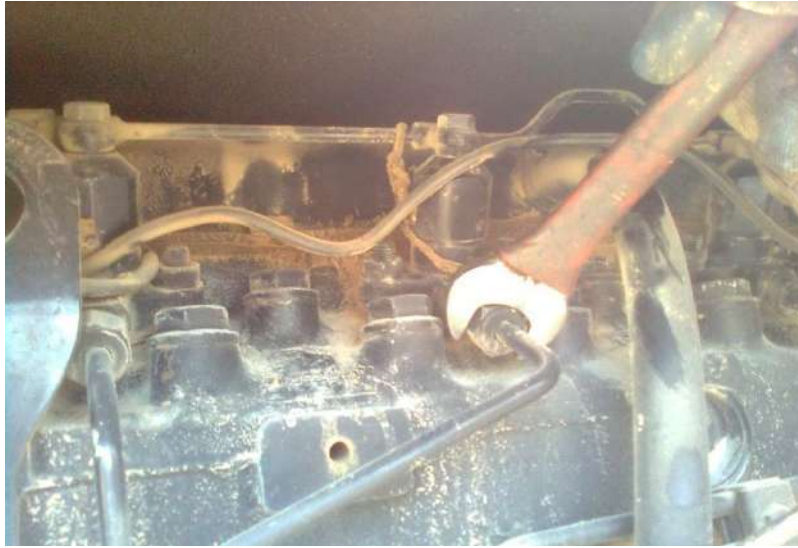
شكل (179-1) تنفيس الحاقنات (البخاخات)
