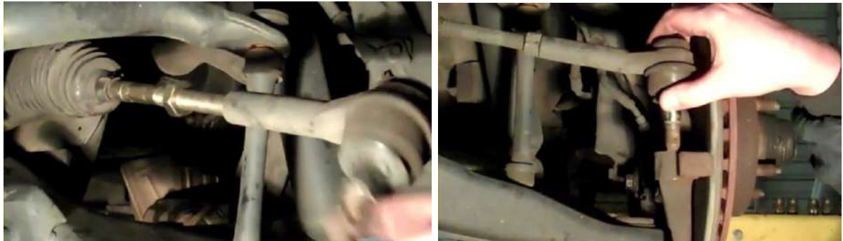
شكل ( 4-16 ) رفع عمود الربط الخارجي
