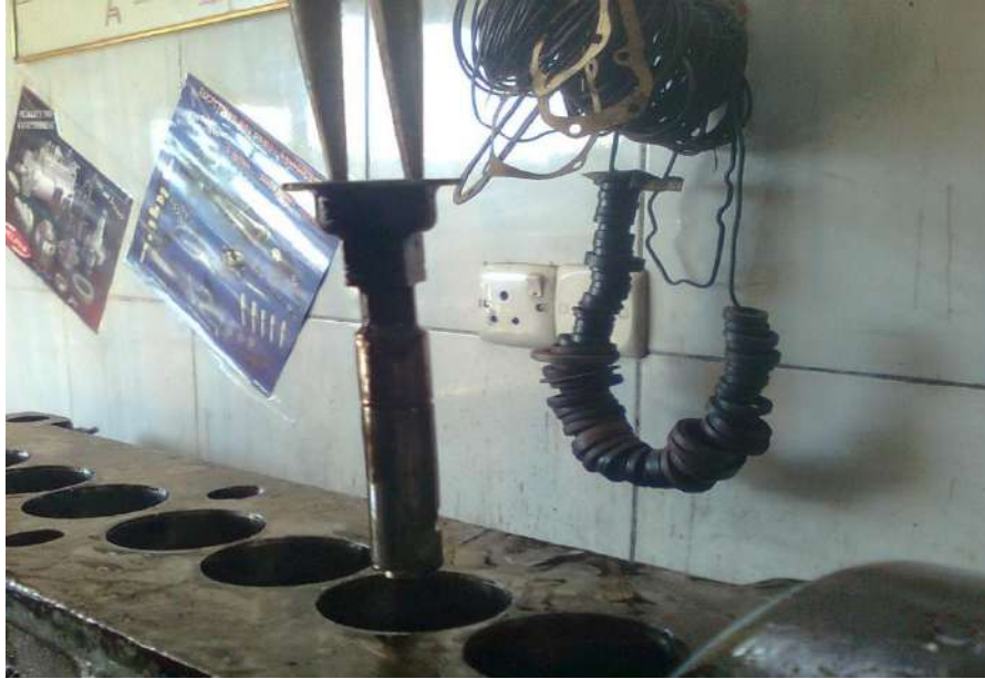
شكل (136-1) استخراج الكباسات من فتحات السدادات النحاسية
