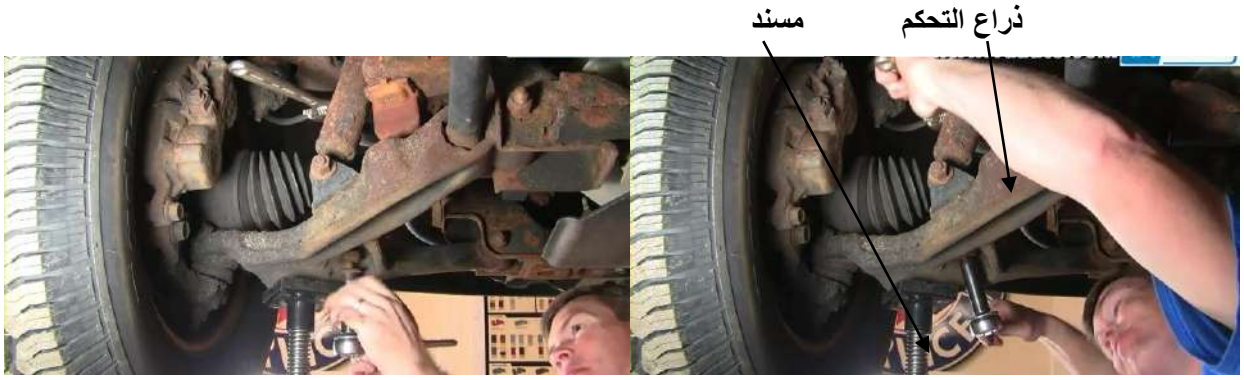
شكل ( 23-2 ) رفع ذراع التحكم السفلي بالمساند شكل ( 24-3 ) فتح الصامولة
