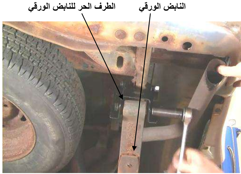
شكل ( 12-3 ) شد صامولة لولب ربط عين الناضج
