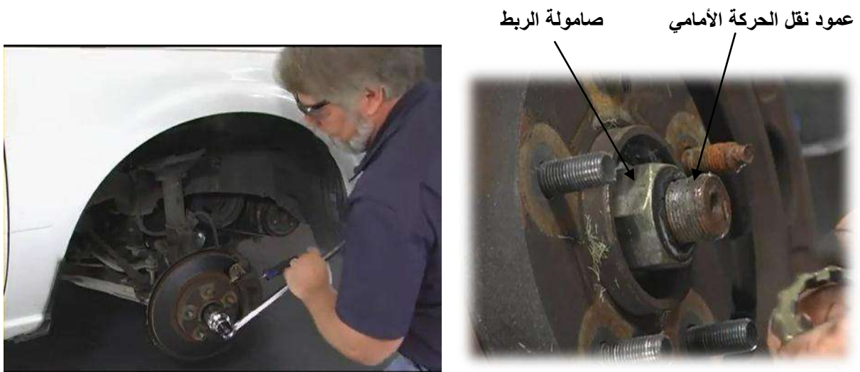
شكل (95-3) الصامولة بعد سحب مسمار القفل شكل (96-3) فتح الصامولة
