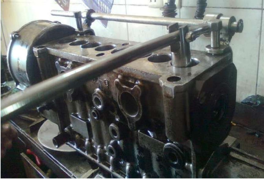
شكل (147-1) العدة الخاصة لضغط مجموعة الكباس
