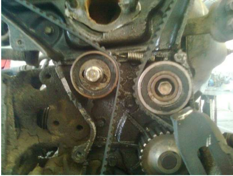
شكل (114-1) تثبيت نابض الضاغطات وشد البراعي
