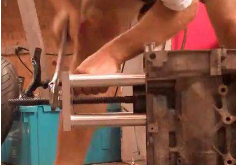
شكل (36-1) لف صامولة العمود المسنن مع اتجاه عقرب الساعة لإخراج البطانة
