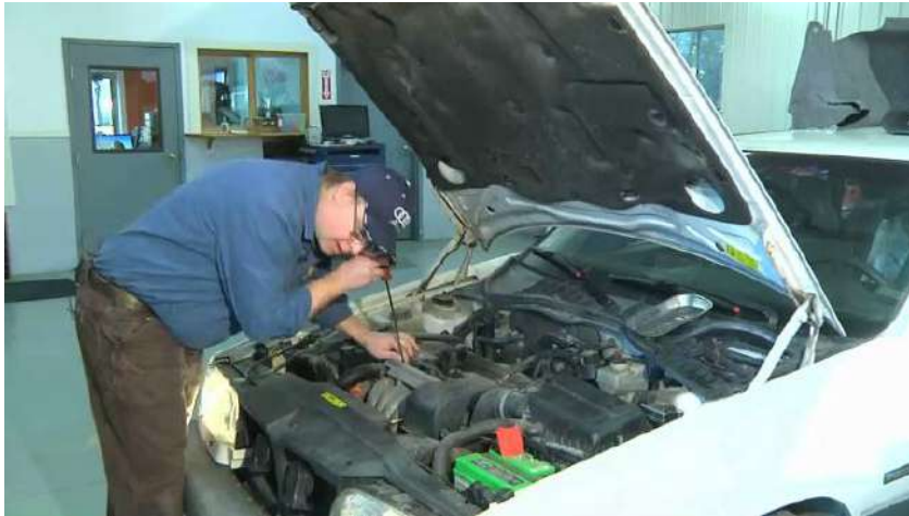
شكل (201-1) سماع صوت عمل الحاقن
