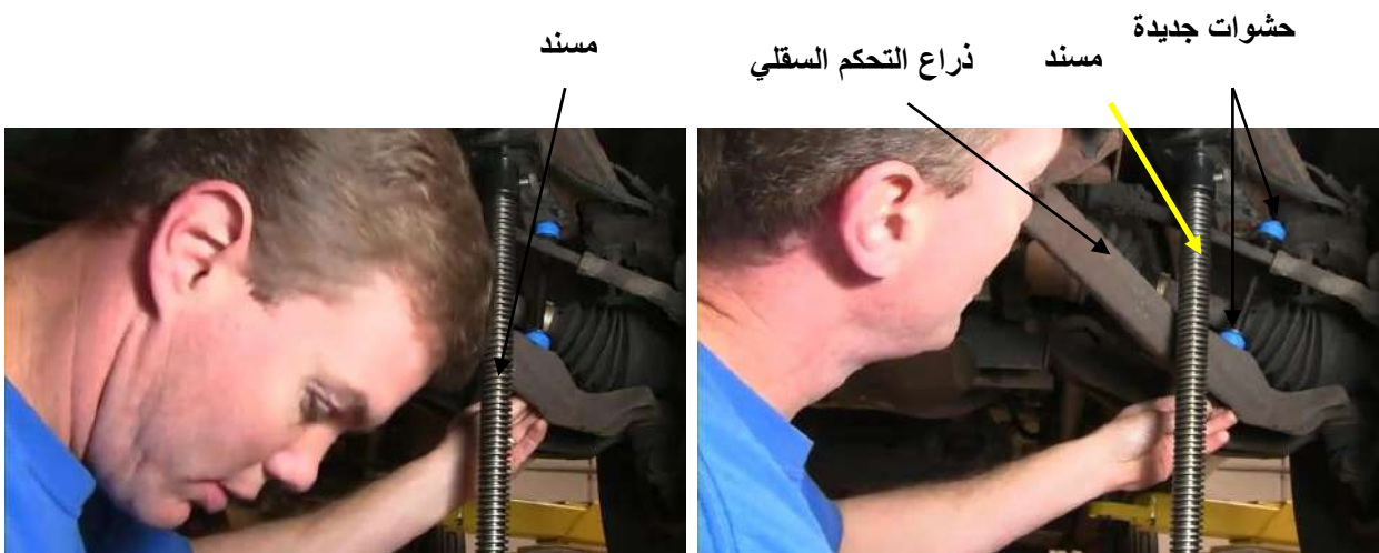
شكل ( 30-3 ) إنزال المسند بعد إدخال اللولب
