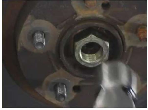
شكل (105-3) الطرق على الصامولة شكل (106-3) طرد بداية العمود خارج حامل العجلة
