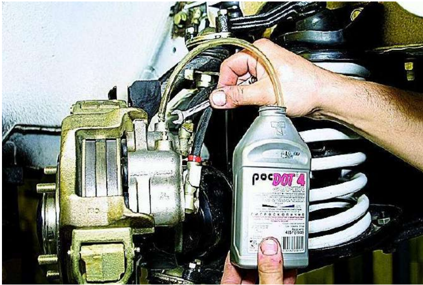
شكل (2-36) تركيب الأنبوب المطاطي على لولب التنفيس
