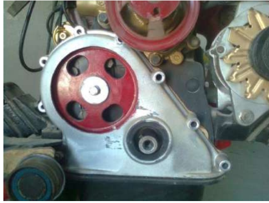
شكل (100-1) غطاء مسننات التوقيت بعد ازالة البراغي
