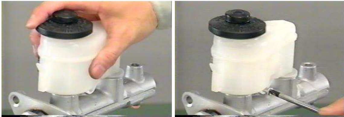
شكل (12-2) فتح لولب تثبيت غطاء البلاستيكي من جسم الاسطوانة
