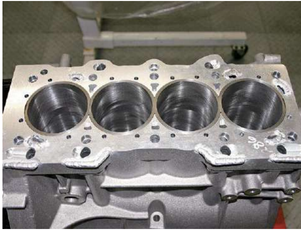
شكل (1-26) محرك ذو اسطوانات مصبوبة بشكل مفرد
