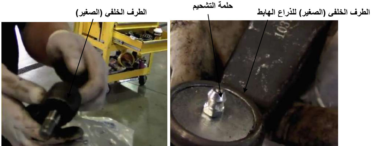
شكل ( 49-4 ) حلمة التشحيم مربوطة مع الطرف الخلفي للذراع شكل ( 50-4 ) ذراع جديد
