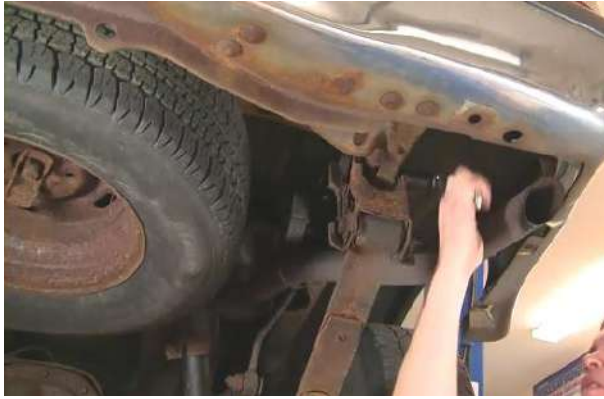
شكل ( 5-3 ) فك صامولة لولبي ربط الطرف الحر للناض الورقي بالشاصي
