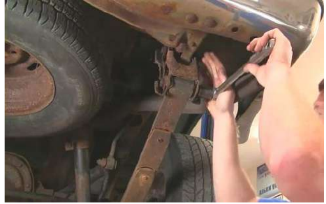
شكل ( 4-3 ) فك صامولة لولب ربط عين النابض الورقي بالطرف الحر
