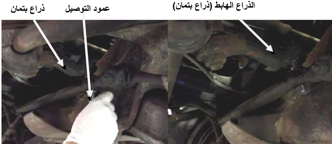
شكل ( 43-4 ) الذراع الهابط (ذراع بتمان) شكل ( 44-4 ) فتح صامولة ربط الطرف الخلفي للذراع
