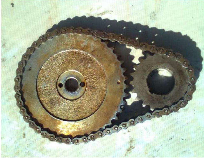
شكل (108-1) تثبيت المسننات والسلسلة خارج المحرك
