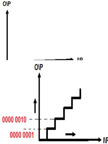
1. استخدم اللوحة التدريبية ADC (8 Bits) وضع إشارة الدخول 0V. لاحظ الخرج 0000 0000.
