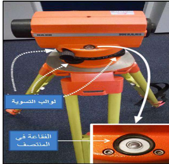
الشكل (2 - 12) يوضح موازنة جهاز التسوية والفقاعة في المنتصف
