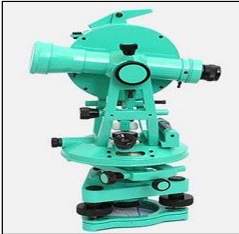
الشكل (4 - 24) يوضح جهاز الثيودولايت التكراري
