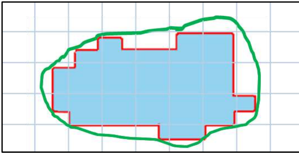
شكل (1-22) حساب المساحة بطريقة المربعات
