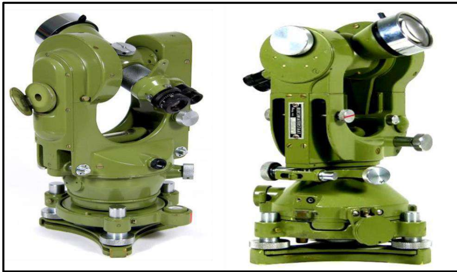
الشكل (4 - 25) يوضح أنواع أجهزة ثيودولايت الاتجاه
