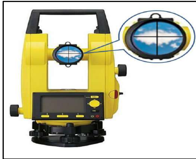
الشكل (4 - 18) توجيه التلسكوب نحو السماء وتوضيح الشعيرات
