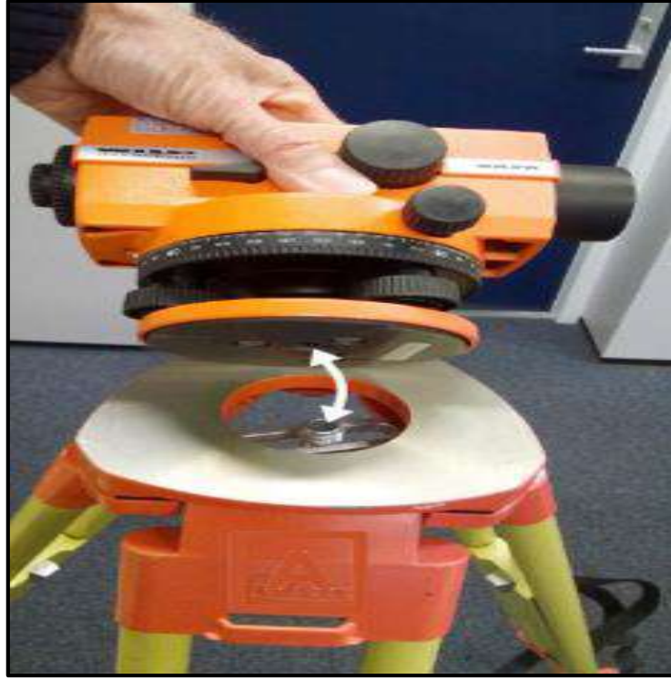
الشكل (2 - 10) يوضح تركيب وتثبيت الجهاز فوق الركيزة
