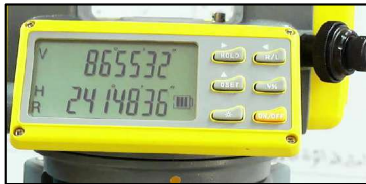
الشكل (4 - 27) يوضح قراءة الزاوية الأفقية والرأسية في شاشة جهاز الثيودولايت
