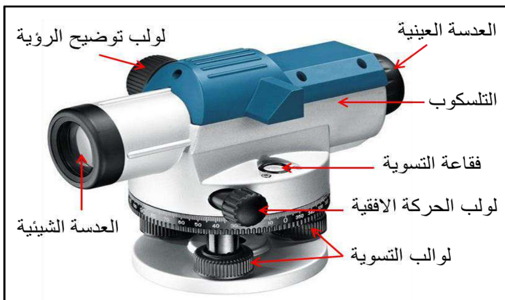
الشكل (2 - 3) يوضح أجزاء جهاز التسوية
