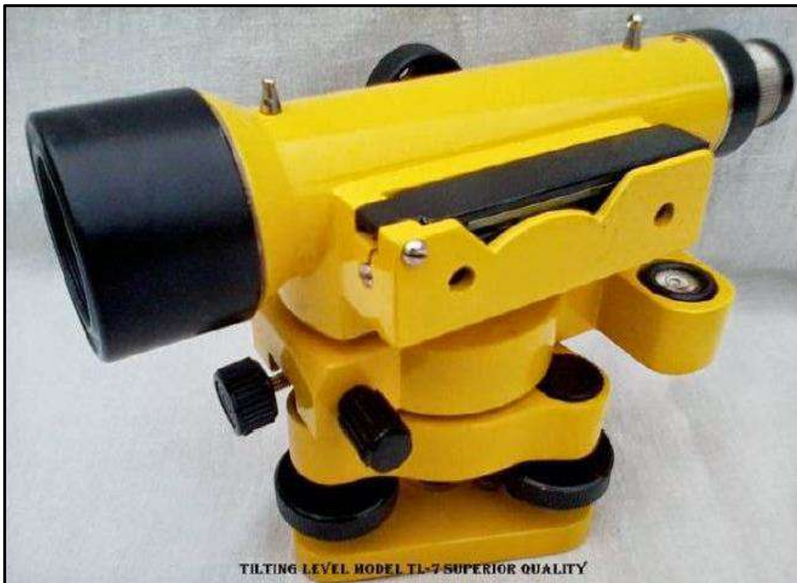
الشكل (2 - 6) جهاز التسوية نوع الإمالة
