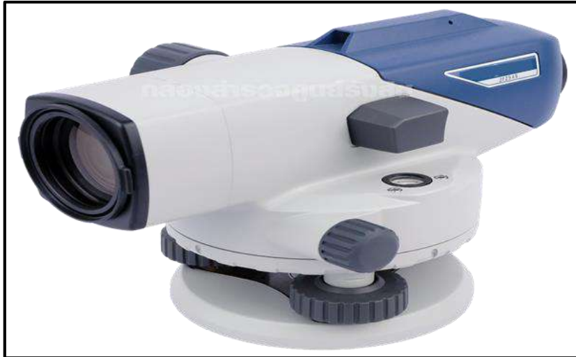
الشكل (2 - 7) جهاز التسوية نوع الأوتوماتيكي
