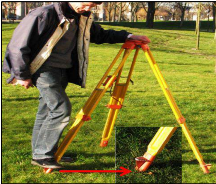
الشكل (2-9) يوضح تثبيت الركيزة في الأرض وغرسها بالقدم
