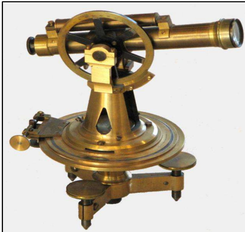
الشكل (4 - 4) يوضح جهاز الثيودولايت قديماً
