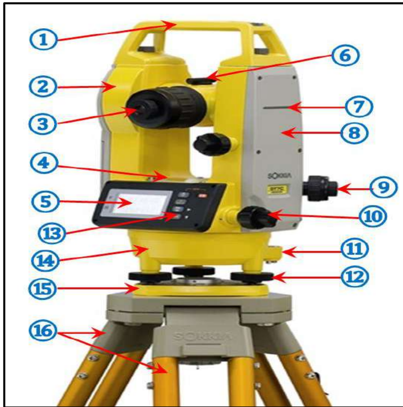
الشكل (4 - 6) أجزاء جهاز الثيودولايت الرقمي
