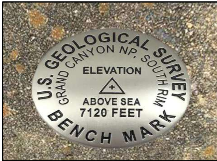
الشكل (2 – 16) يوضح نقطة لراقم التسوية (B.M.)
