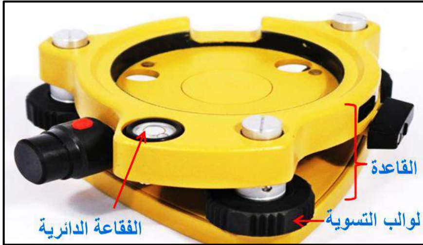
الشكل (4 - 13) الفقاعة الدائرية في قاعدة جهاز الثيودولايت
