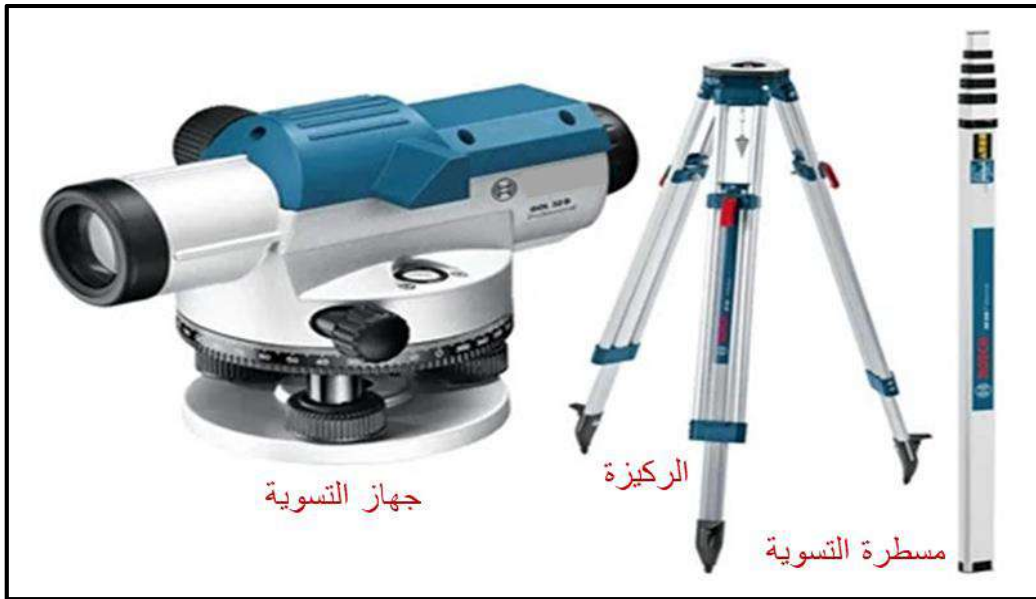
الشكل (2 - 2) جهاز التسوية وملحقاته
