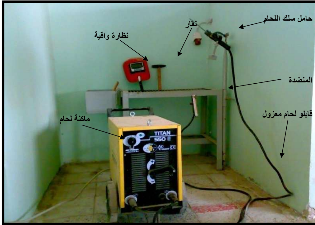
شكل 3-1 معدات لحام القوس الكهربائي
