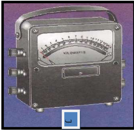
شكل 4-11 جهاز قياس القدرة الكهربائية للتيار المتردد
