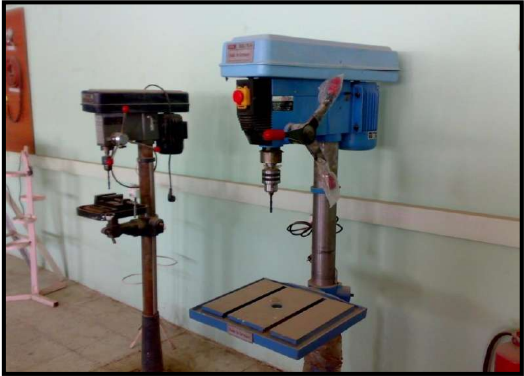
شكل 3-3 مثاقب كهربائية عمودية
