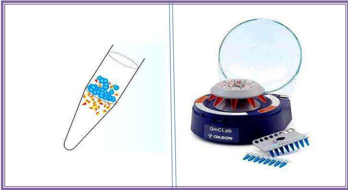
شكل 16 - 6 جهاز الطرد المركزي وملحقاته شكل 16 - 7 أنبوبة الجهاز والمحلول متفكك
