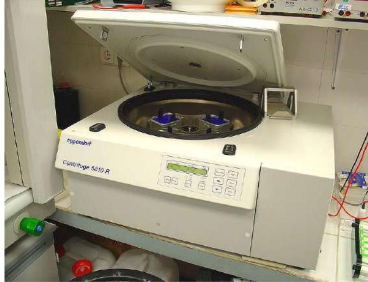
شكل 16 - 9 جهاز الطرد المركزي متعدد الأغراض مع مفاتيح السيطرة
