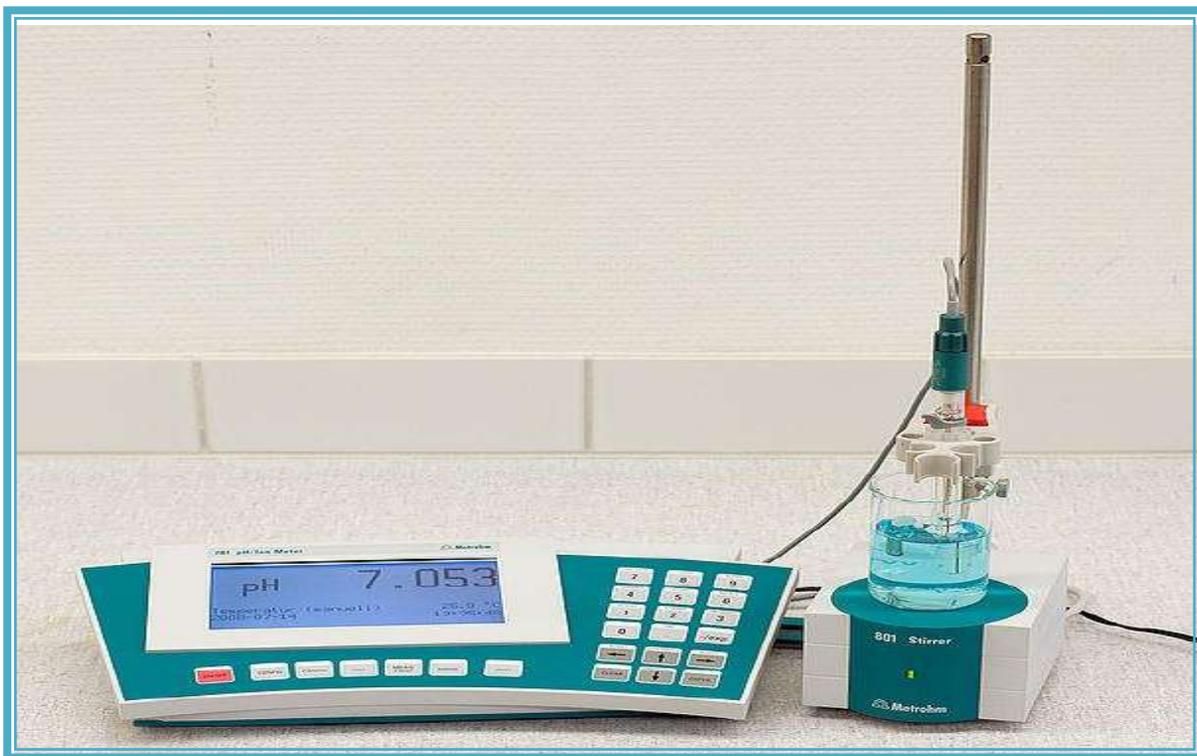
شكل 16 - 22 جهاز قياس الحمضية
