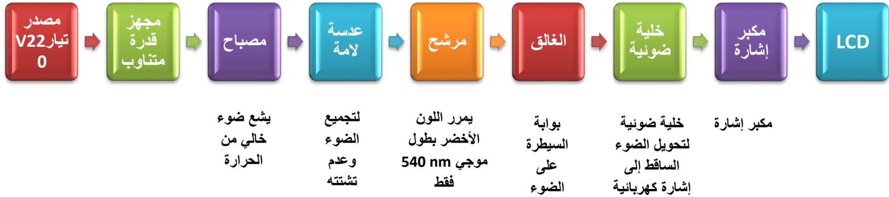
شكل 21-16 مخطط كتلي لعمل جهاز الهيموكلوبين
