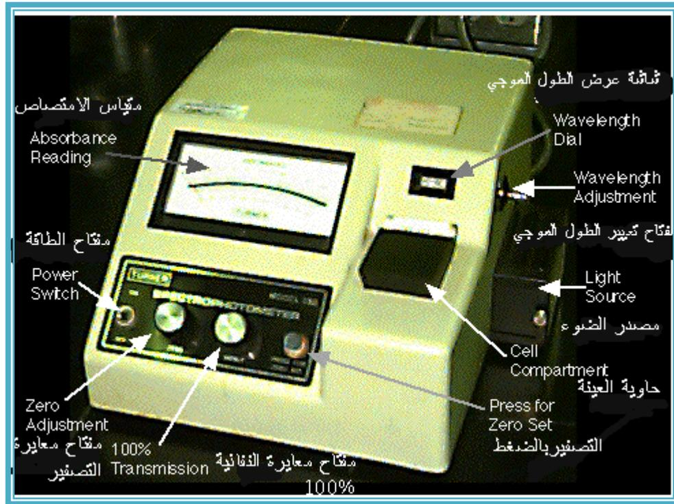
شكل 18-16 الأجزاء الخارجية لجهاز (Spectrophotometer)
