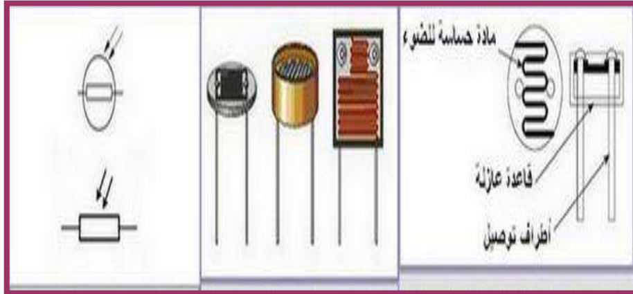
الشكل 2-26 رمز وتركيب المقاومة الضوئية
