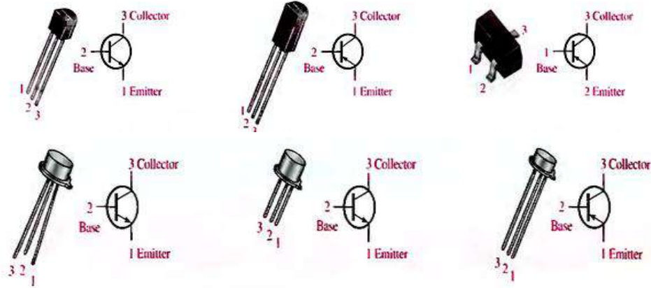
الشكل 5-6 الأشكال المختلفة للترانزستور ثنائي القطبية متعدد الأغراض / ذو الإشارة الصغيرة
