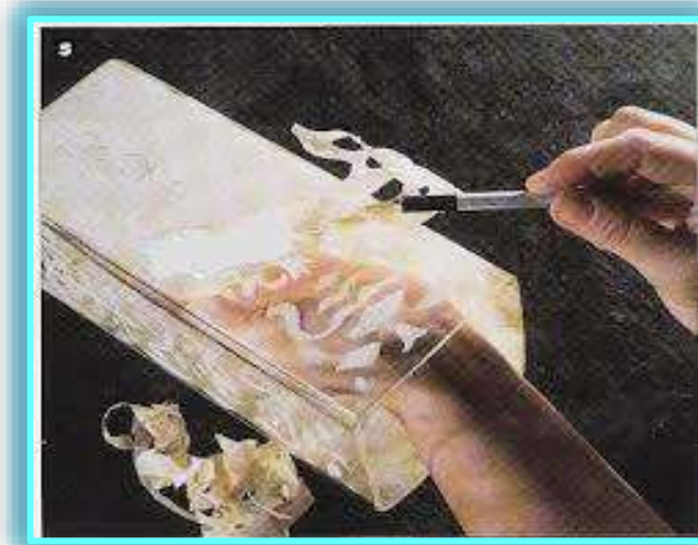
الشكل (6-23) استخدام الورق اللاصق بدل الاستنسل
