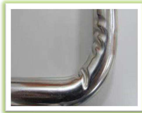
الشكل ( 17-1 ) عيوب تقويس الانابيب
