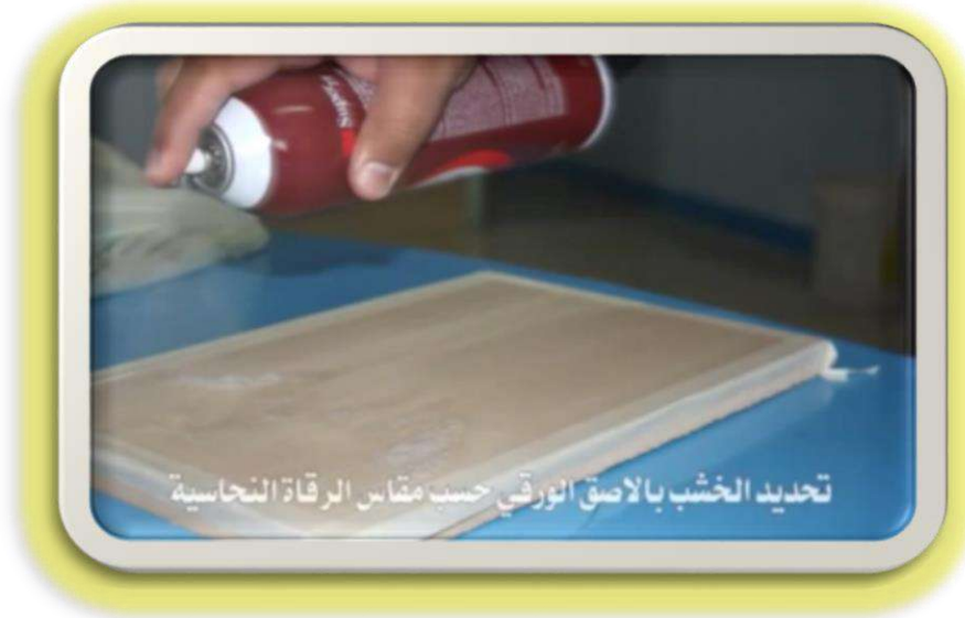
الشكل (5-29) تحديد الخشب باللاصق الورقي
