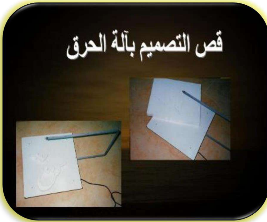
الشكل (5-14) يوضح قص التصميم بآلة الحرق
