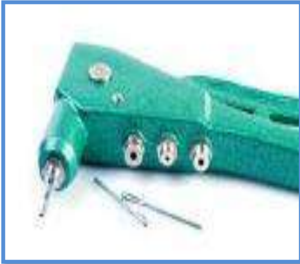
الشكل (3-7) آلة تثبيت البرشام (التونك) بانواع مختلفة
