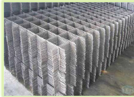
الشكل ( 4-1 ) يوضح حديد المشبكات
