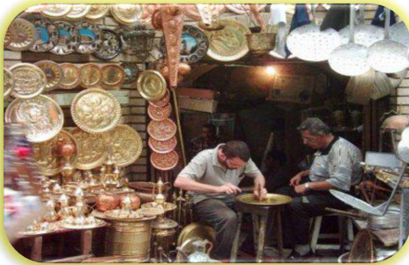
الشكل (5-13) يوضح عملية الطرق على النحاس في سوق النحاسيين
