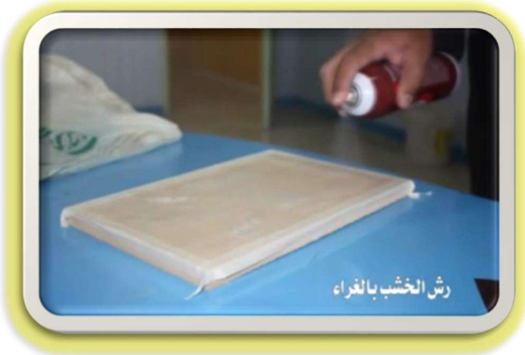
الشكل (5-30) يوضح فيه رش الخشب بالغراء
