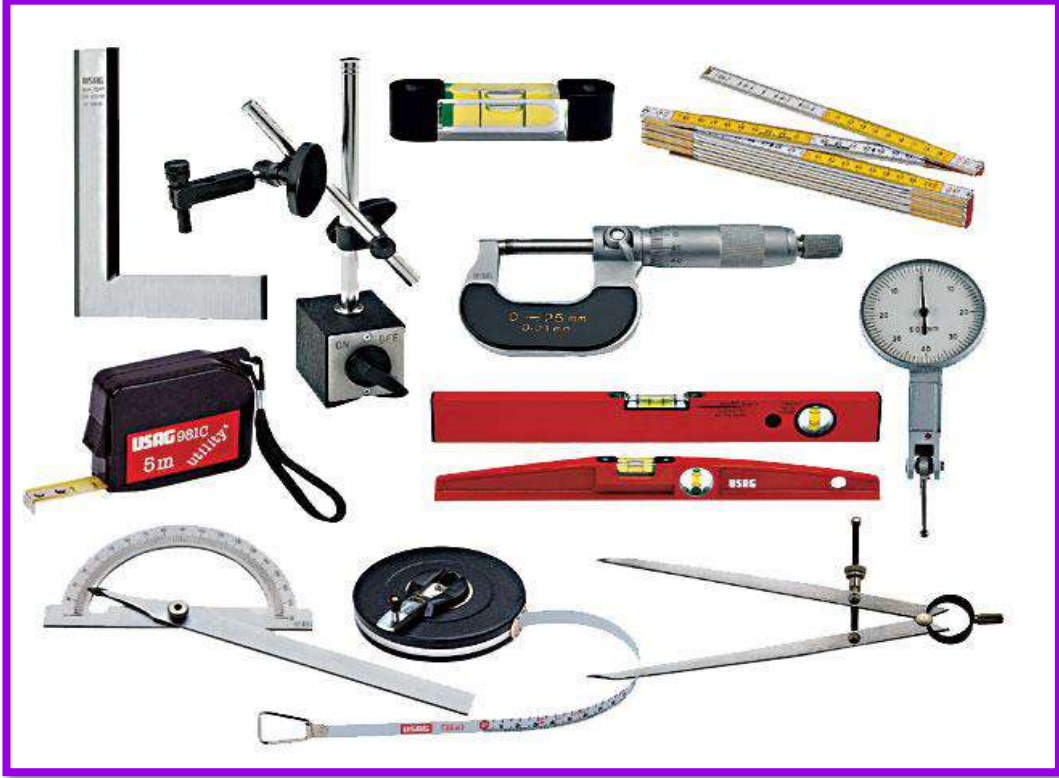
الشكل (4- 12) انواع مختلفة من ادوات القياس
