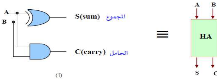
الشكل 2-3 الدائرة المنطقية للجامع النصفى مع المخطط الكتلي له
