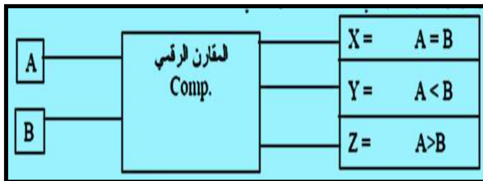
شكل 8-3 توضح المخطط الكتلي لدائرة المقارن الرقمي
