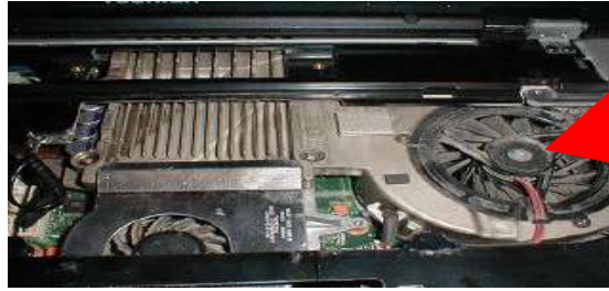
شكل 9-2 كسر في مروحة التبريد
