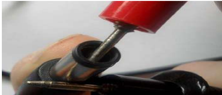
شكل 5-2 قياس جهد الخرج للشاحن
