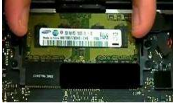
شكل 12-2 تركيب الذاكرة في الحاسوب المحمول
