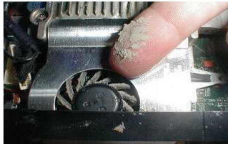
شكل 2- 10 إزالة الغبار من مروحة الحاسوب المحمول
