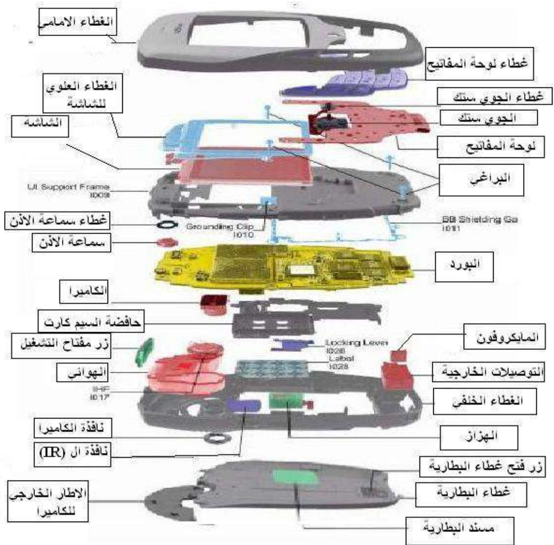
الشكل 3-19 يوضح اجزاء ومكونات الهاتف المحمول نوع نوكيا
