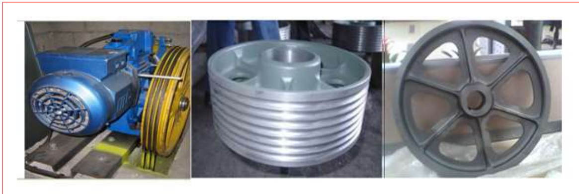
الشكل 16-1 البكرات المستعملة في المصاعد الكهربائية
