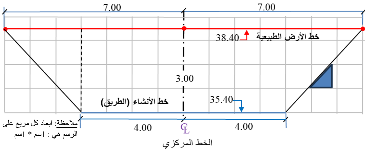
الشكل (3-17) رسم مقطع عرضي عند المحطة (7+00)
