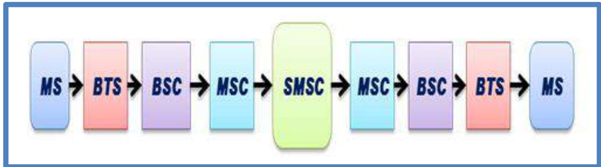
الشكل 4-7 متابعة رسالة من الهاتف إلى محطة القاعدة للاتصال BTS وإلى MTSO
