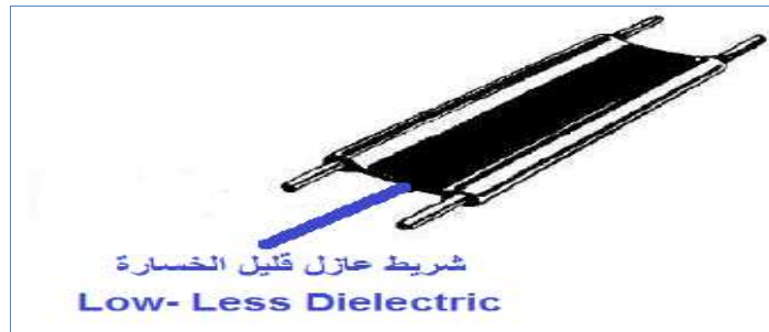
الشكل 6-2 خط النقل المفتوح Twin Lead Ribbon
