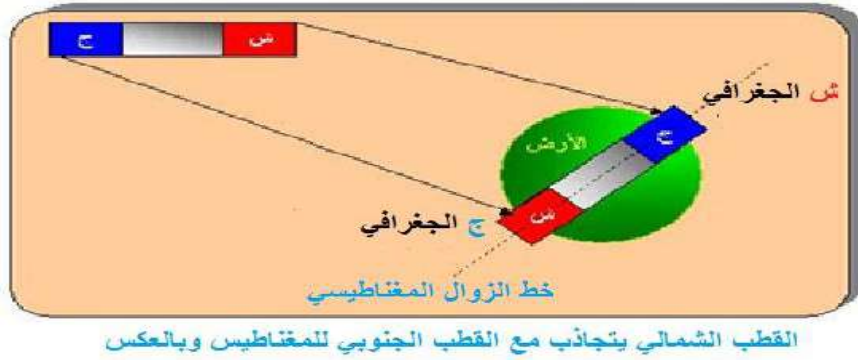
الشكل 1-9 تجاذب قطبي المغناطيس
