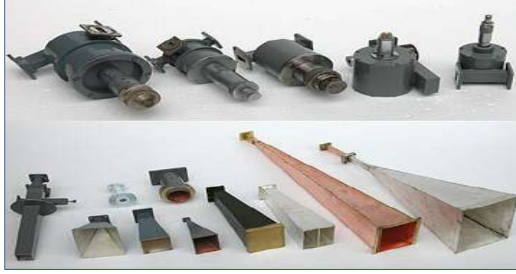
الشكل 2-21 أشكال مختلفة لدليل الموجة
