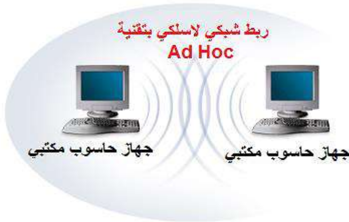
الشكل 8-8 الربط الشبكي اللاسلكي باستخدام تقنية Ad Hoc
