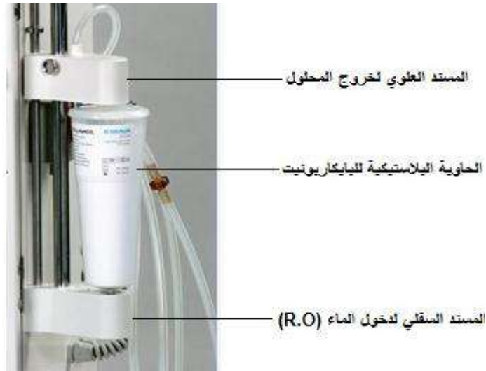
شكل ١٢-٢٠ طريقة وضع الكارتريج في جهاز الكلية الاصطناعية
