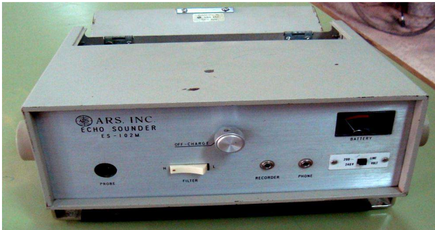
الشكل ٢٤-٢ صورة فوتوغرافية لآحد أجهزة الصدى الصوتي لسماع صوت قلب الجنين
