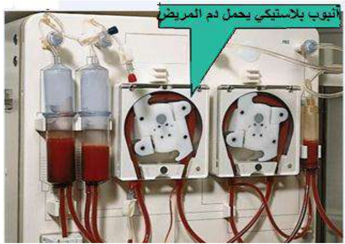
شكل ١٢-٥ منظومة الأنابيب البلاستيكية للدم في جهاز الكلية الاصطناعية
