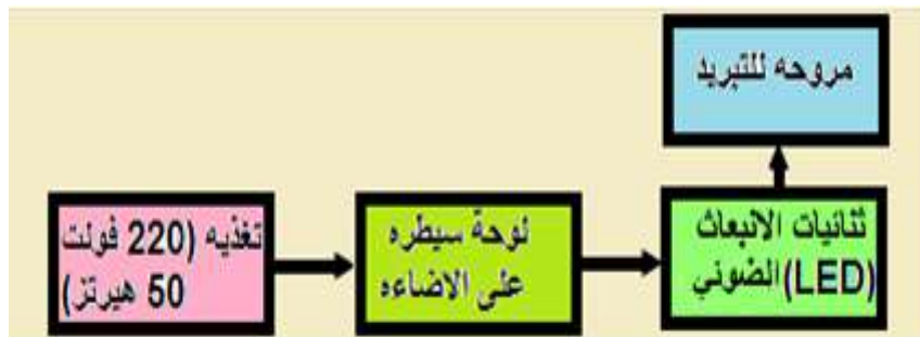
شكل ٧ - ٣٥ المخطط الكتلوي لجهاز تبييض الاسنان
