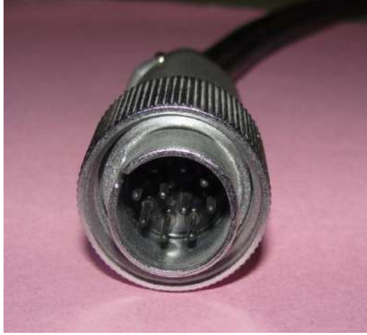
شكل ١١-٣ الطرف الأول لكيبل المريض الذي يربط بجهاز (E.C.G)
