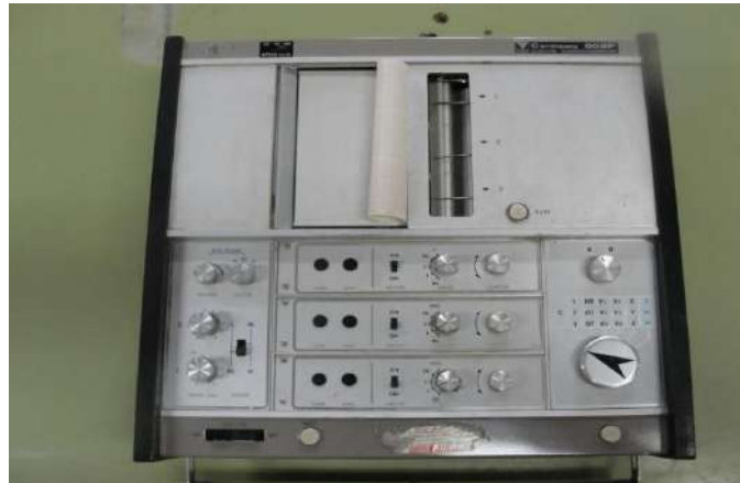
الشكل ٣-١٩ يمثل جهاز تخطيط قلب ذو ثلاث قنوات
