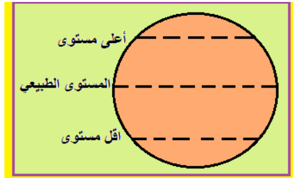
شكل ٧ - ٥ عدسة الزيت في محرك ضاغط الهواء
