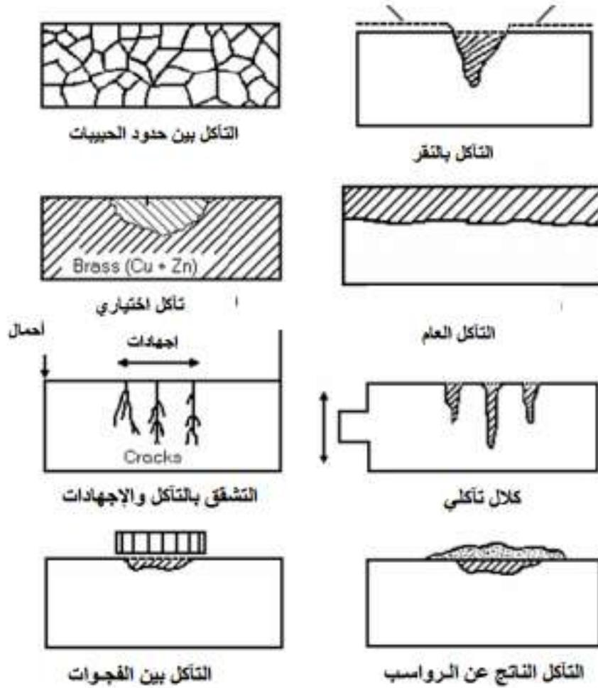
الشكل 6 - 3 : نماذج لأهم أنواع التآكل
