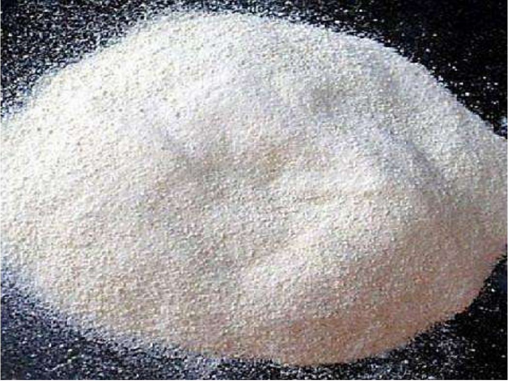
شكل (5-19) الكوارتز الحامل لحامض الفسفوريك عامل مساعد لوحدة البلمرة
