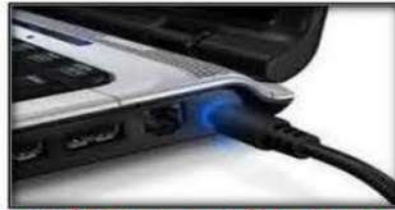
الشكل (4-6) منفذ لتوصيل الطاقة الكهربائية
