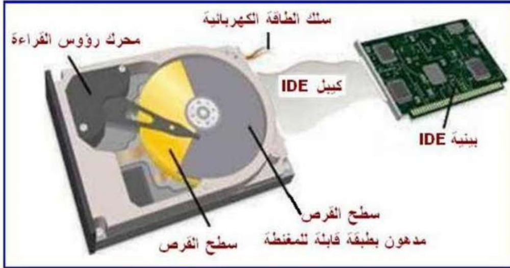
الشكل ( 3 - 9 ) المكونات الداخلية للقرص الصلب
