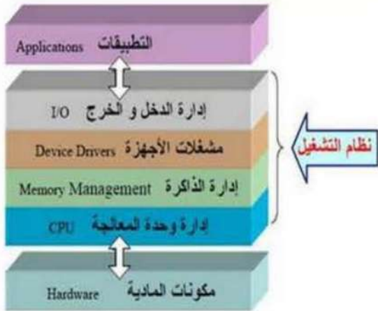
الشكل ( 2 - 4 ) الوظائف المختلفة التي يقوم نظام التشغيل بالتحكم بها
