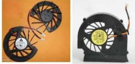
الشكل (12-4) أنواع من مراوح التبريد في الحاسوب الدفكري
