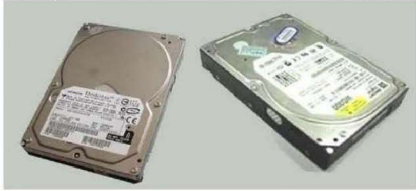
الشكل ( 3 - 8 ) الهيئة الفيزيائية للقرص الصلب نموذجي
