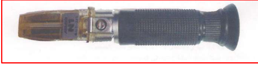
الشكل (13-14) جهاز الرفراكتوميتر لقياس نسبة المواد الصلبة الذائبة الكلية (TSS) Handy Refracctometer
