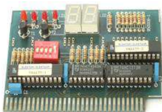
الشكل ( 6 - 7 ) بطاقة الـ POST الخاص لتوصيلات الـ ISA
