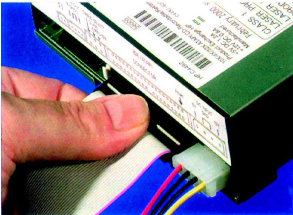
الشكل ( 2-21 ) ألوان كيبلات ومنطقة تثبيت موصل طاقة التغذية لمشغل الأقراص الليزرية
