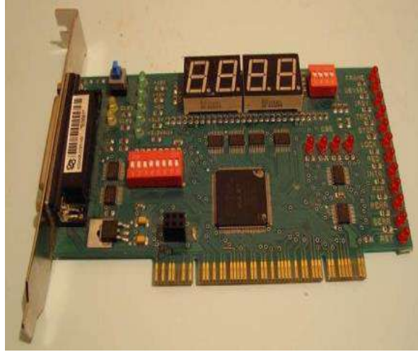
الشكل ( 4 - 7 ) بطاقة الـ POST الخاص لتوصيلات الـ PCI المتقدم
