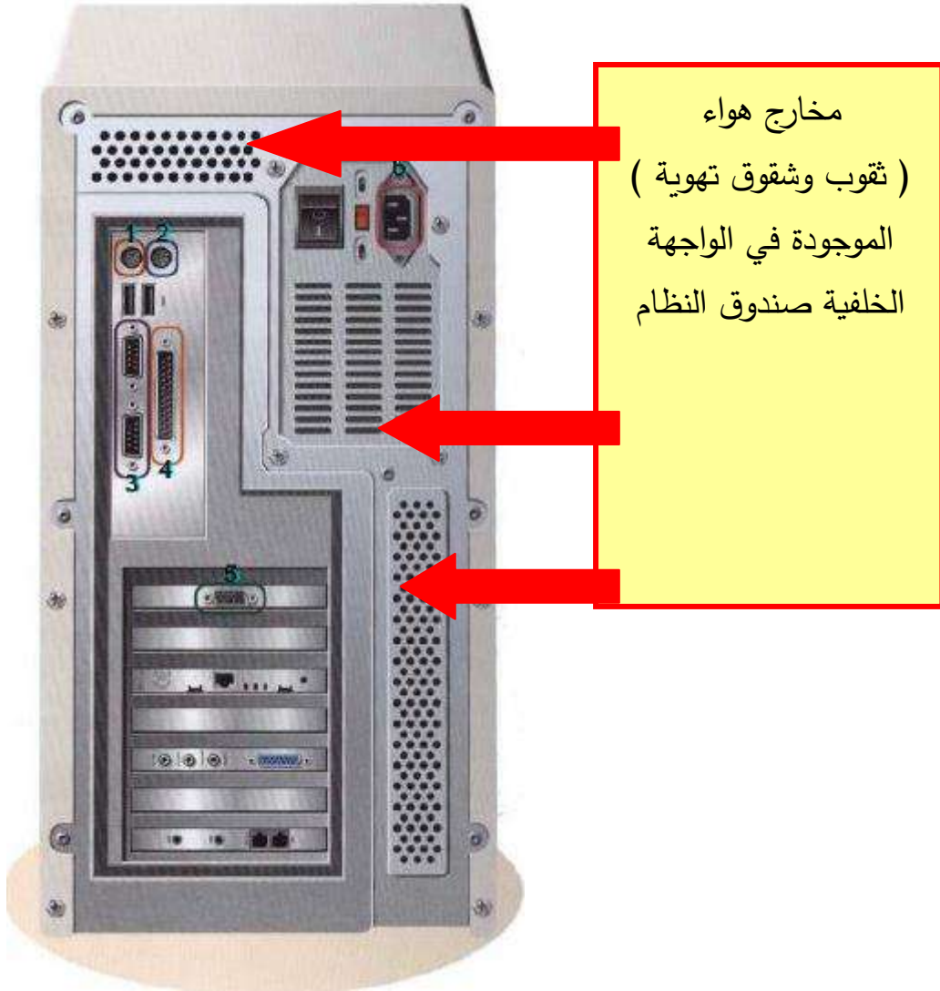
الشكل ( 2-40 ) ثقوب وشقوق التهوية في الواجهة الخلفية لعلبة النظام
