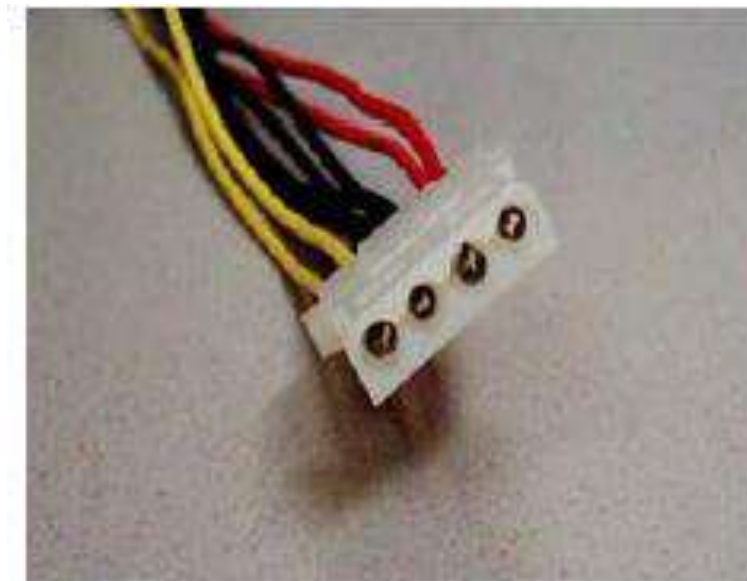
الشكل ( 2 - 19 ) موصل طاقة التغذية لمشغل القرص الصلب والليزري
