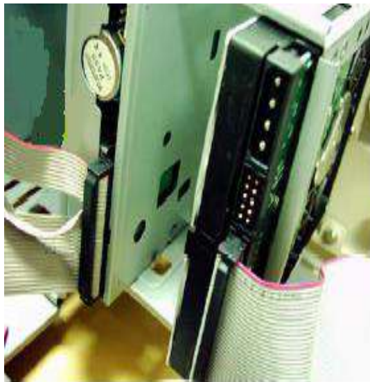
الشكل (25-2) ربط الكيبل (IDE) في مشغل الأقراص المرنة
