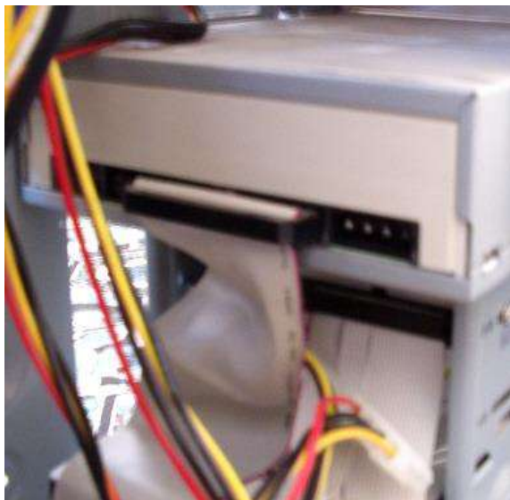
الشكل (2-31) تثبيت الأسطوانات المدمجة في صندوق النظام
