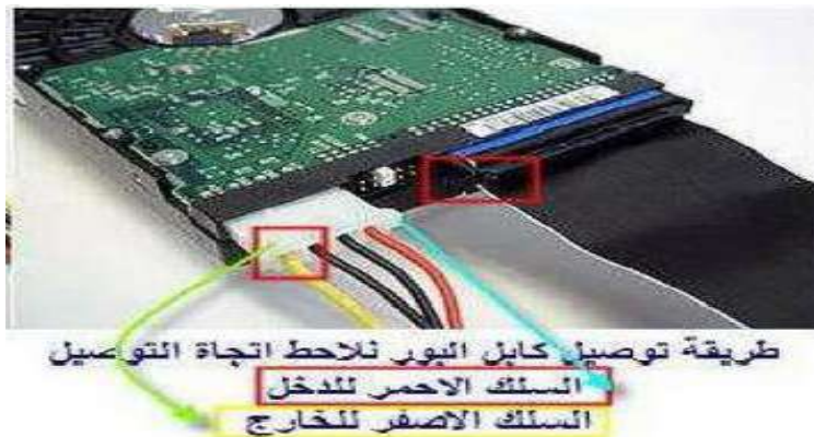
الشكل (28-2) توصيل كابل الطاقة
