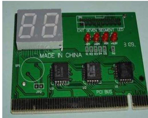
الشكل ( 5 - 7 ) بطاقة الـ POST الخاص لتوصيلات الـ PCI
