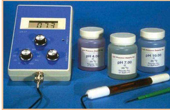
شكل (21) جهاز قياس الـ pH مع المحليل النظمة لضبط عمل الجهاز
