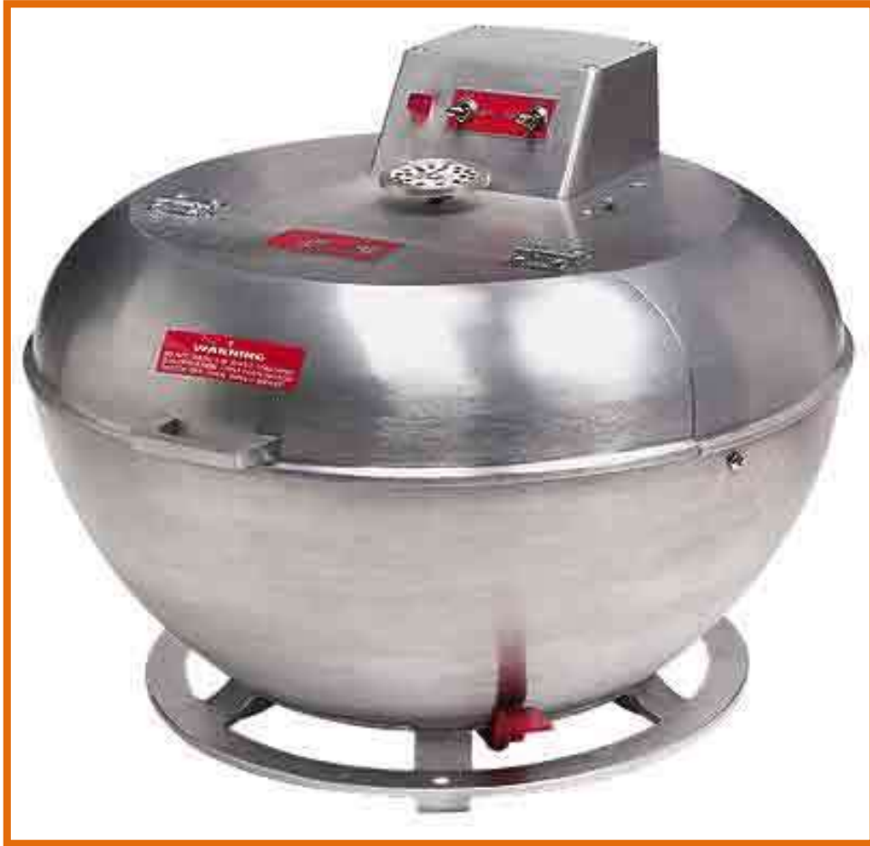
شكل (56) جهاز الطرد المركزي لتقدير نسبة الدهن بطريقة بابكوك
