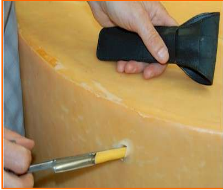
شكل (46) يمثل عملية اخذالعينة من قالب الجبن بواسطة قلم أخذ النماذج Trier
