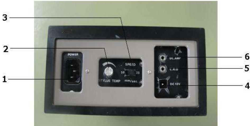
شكل 2-3 مكونات جانب جهاز تخطيط القلب
