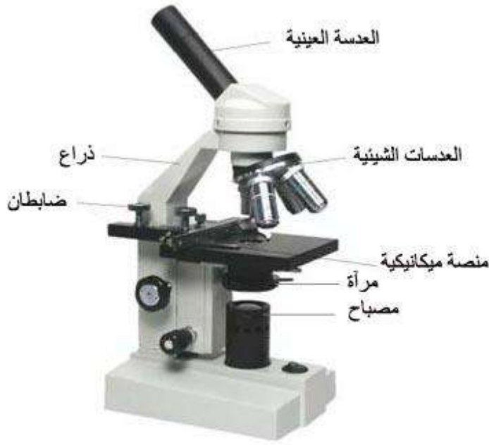
شكل (1) اجزاء المايكروسكوب المركب
