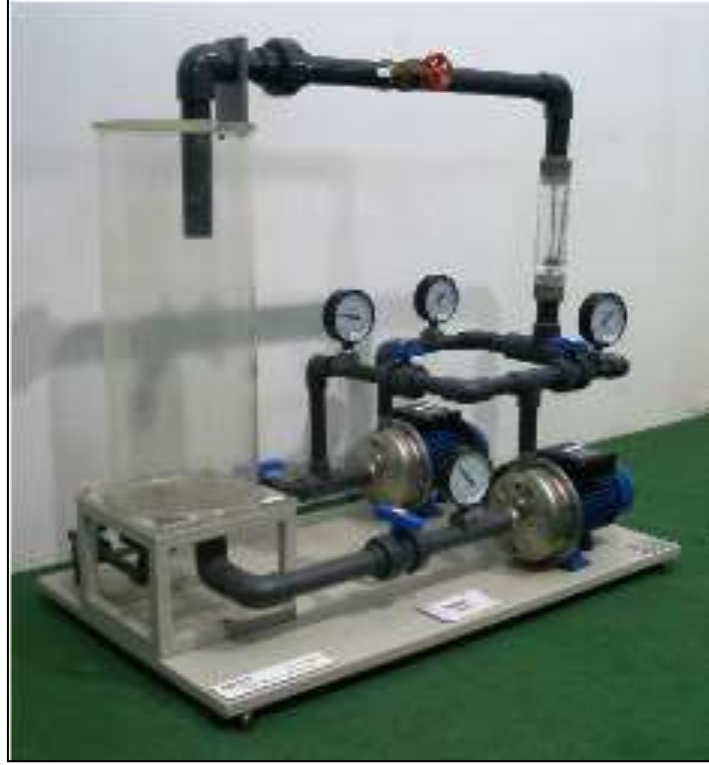
الشكل (3-17) جهاز تجربة ربط الأنابيب
