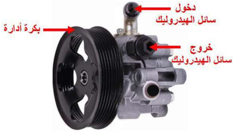
الشكل (31-3) مضخة هيدروليكية ملحقة مع منظومة الاستدارة
