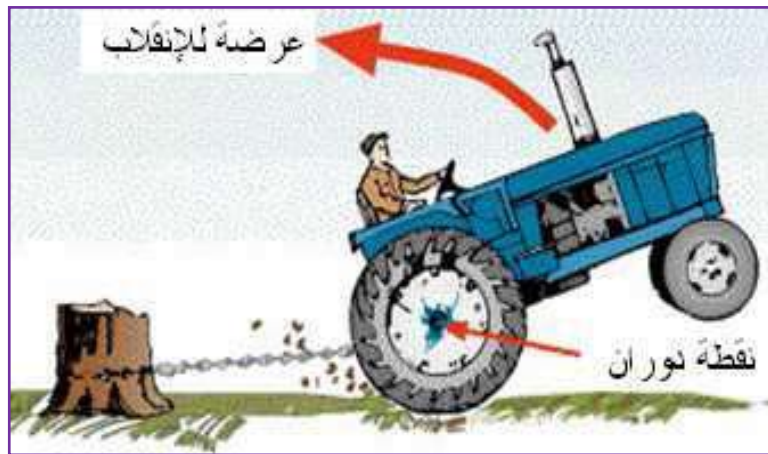
الشكل (5-7) انقلاب الساحبة في حال السحب بقوة أكبر من القوة المصممة لها الساحبة
