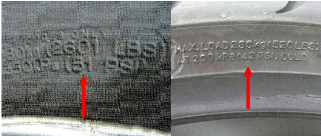
الشكل (4-21) قيمة ضغط الإطار الموصى به من قبل الشركة المصنعة
