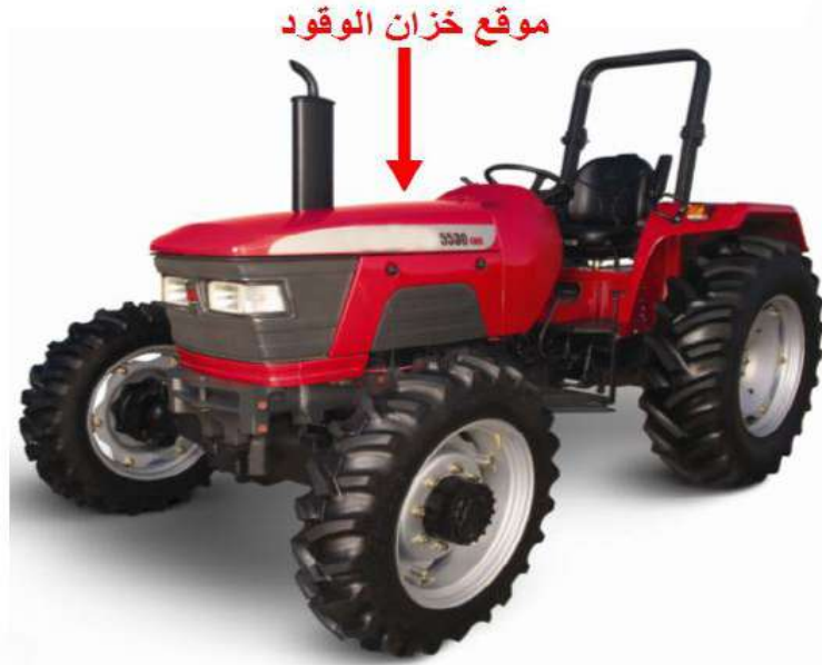
الشكل (2-3) خزان الوقود فوق المحرك
