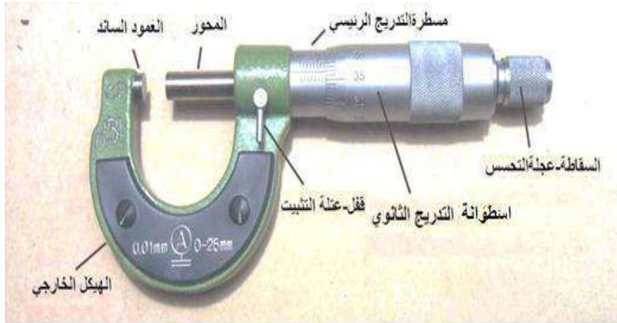
الشكل (2-17) مايكرومتر القياس الخارجي
