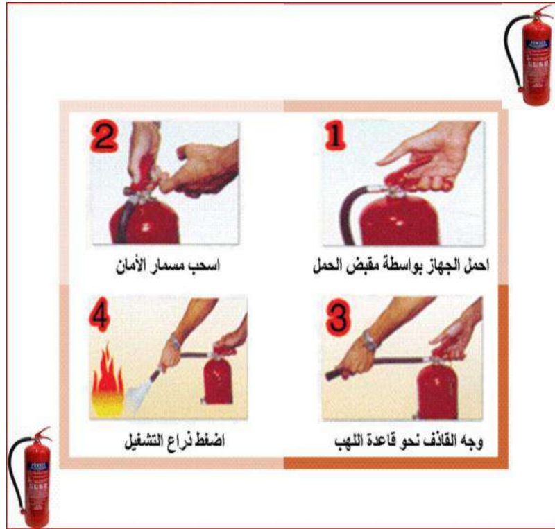
الشكل رقم(1-23) طريقة استخدام طفاية الحريق
