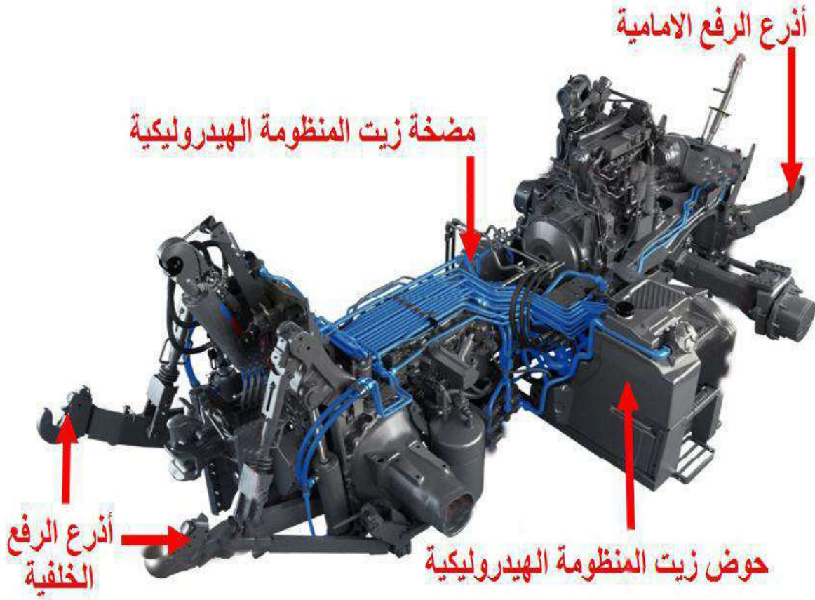
الشكل (35-3) أجزاء منظومة تعليق أمامية وخلفية لساحبة حديثة
