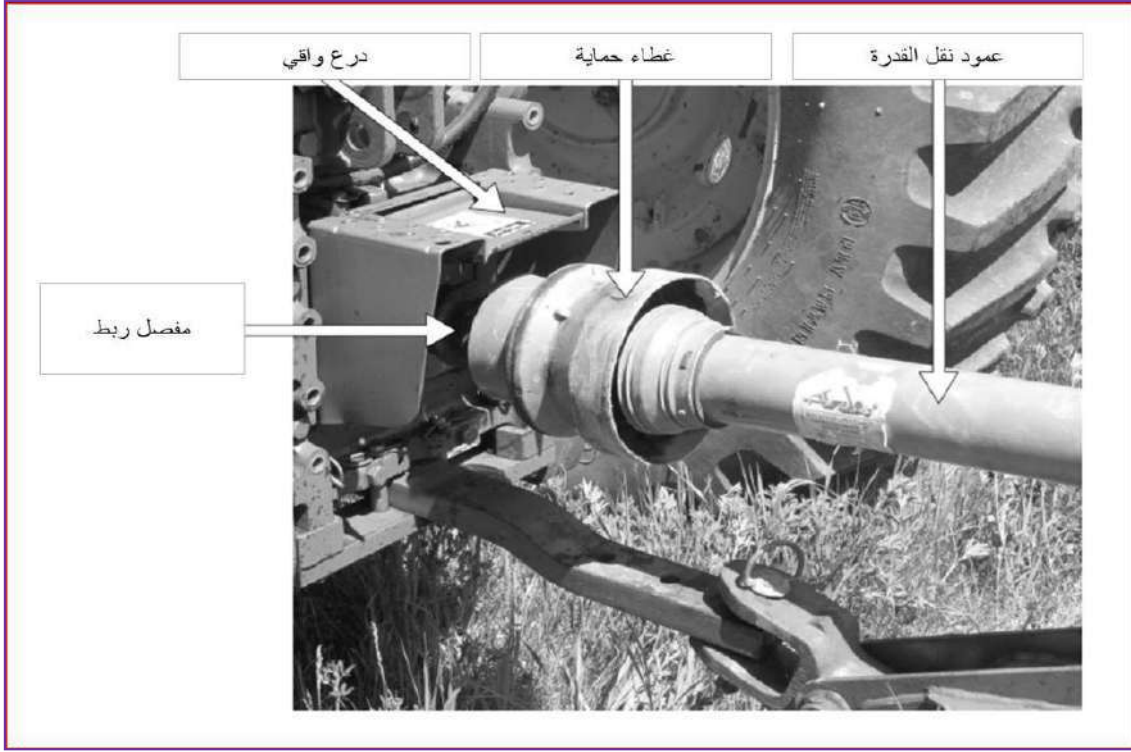
الشكل (5-8) عمود نقل القدرة مربوط بين الساحة والمعدة الزراعية
