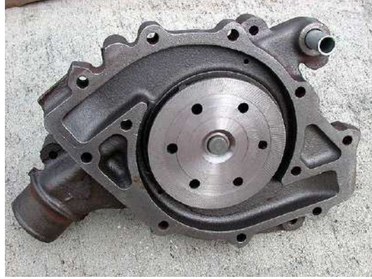
الشكل (3-24) مضخة سائل التبريد المستخدم في المحرك
