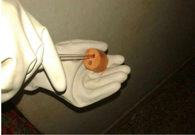
شكل 1-26 طريقة ادخال انبوب زجاجي في قطعة مطاطية
