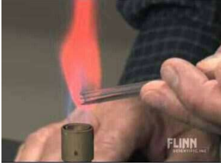
شكل 25-1 طريقة تهذيب نهاية الانبوب الزجاجي
