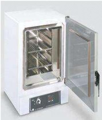
7 انقل المحتويات مع طبق التبخير إلى المجفف الكهربائي مع تثبيت درجة الحرارة عند  $55^{\circ}\text{C}$  ولمدة من 4-6 ساعة أو عندما تظهر بلورات بيضاء صلبة .
