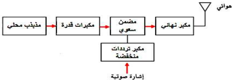
الشكل (1-2) المخطط الكتلي لمرسلة راديوية (A.M)
