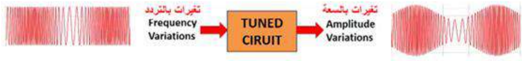
الشكل (8-2) مخطط لدائرة الرنين مع تحويل التغيرات في التردد إلى تغيرات في السعة
