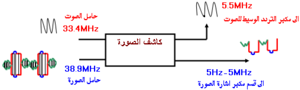
الشكل (2-17) المخطط الكتلي لكاشف الصورة
