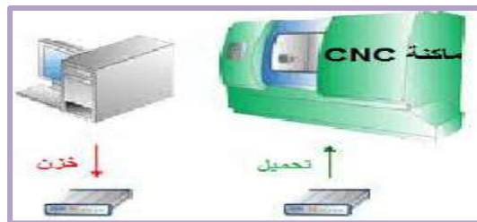
الشكل(25-4) آلية نقل البرامج من الحاسبة إلى ماكينة CNC عبر أجهزة الخزن(مثل السواقة(USB)
