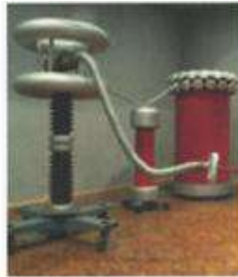
الشكل (2-44) وحدات محول متوالي أفقيا بجهد خرج 350KV الى وحدة تفريغ
