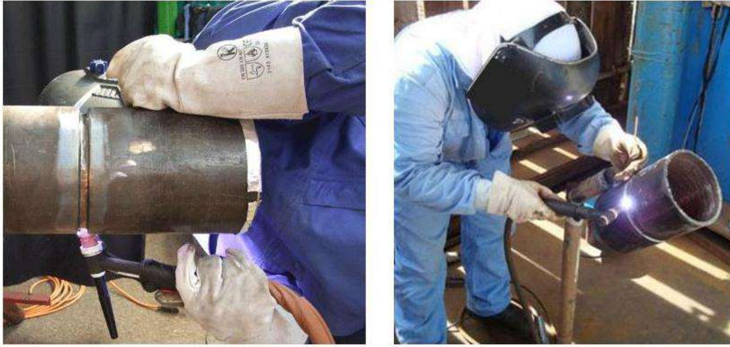
الشكل (1-31) يوضح التدريب على لحام الأنابيب
