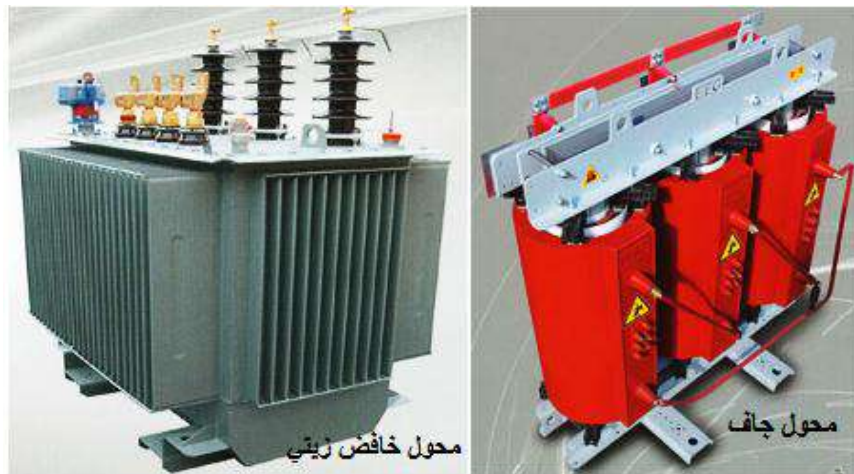
الشكل (4-6) محول توزيع بنسبة تحويل 11kv/416v أو 33KV/416V تبريد زيت ONAN سعة 1000KVA توصيل DYN11 ونوع آخر جاف
