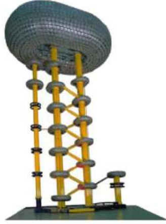
الشكل (2-45) وحدات من محولات تيار متناوب متوالية بشكل رأسي لتوفير الأمان
