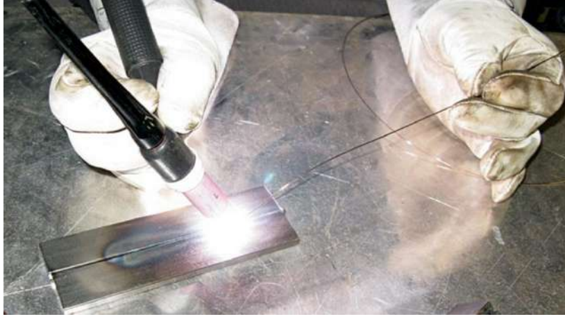
الشكل (1-30) يوضح ربط قطعتين بلحام قطب التنكستن وغاز الأركون
