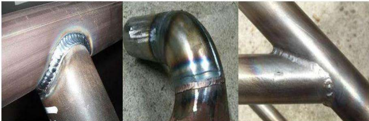
الشكل (1-13) يوضح توصيل الأنابيب وملحقاتها باللحام
