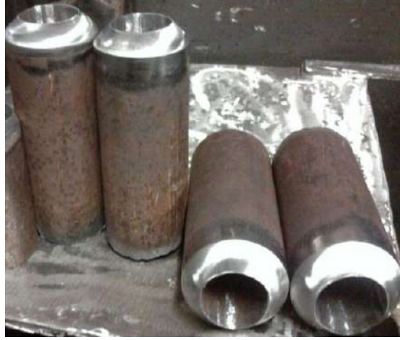
الشكل (1-32) يوضح تحضير قطعة العمل
