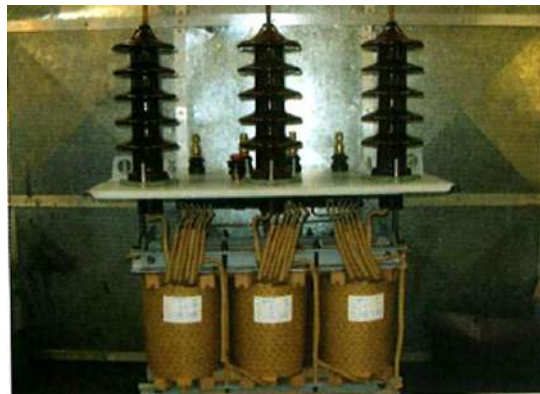
الشكل (4-4) يبين التركيب الداخلي لأحد محولات القدرة
