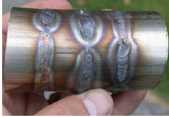
الشكل (1-33) يوضح اللحام التجريبي في قطعة العمل
