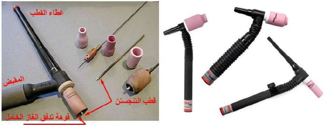
الشكل (1-26) يوضح أنواع وأجزاء مسدس اللحام
