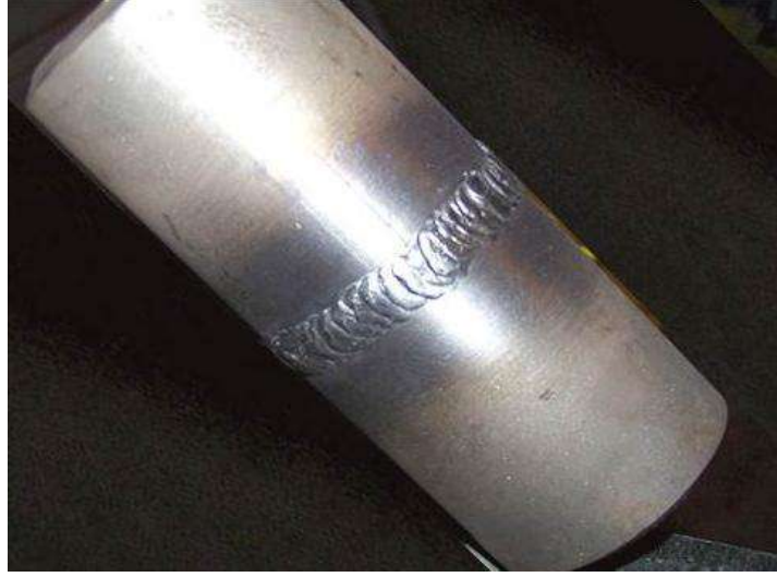
الشكل (1-46) يوضح التمرين بعد أتمام عملية اللحام
