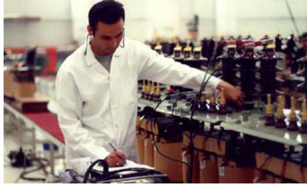
الشكل (4-15) فحص العازلية للمحوالة بأستخدام أجهزة توليد الجهد العالي (الميجر)
