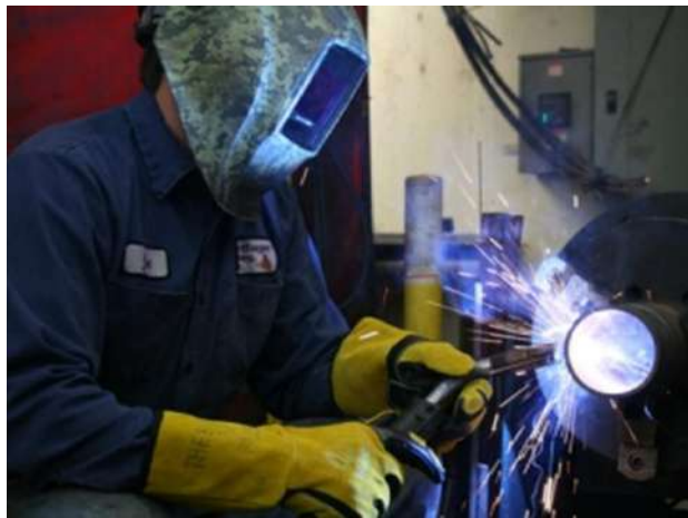
الشكل (1-45) يوضح تطبيق شروط السلامة ومسك مسدس اللحام بشكل أفضل
