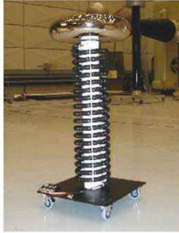
الشكل (2-52) تقنية قياس الجهد العالي بأستخدام مقاومات وفولتميتر ذات ممانعة عالية
