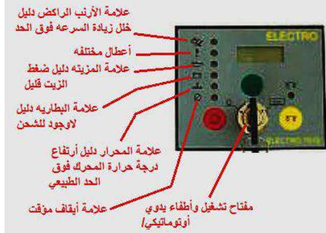
الشكل (3-7) العلامات الدالة والمنبه لوجود خلل في أحد أجزاء المولدة لمسيطر أوتوماتيكي
