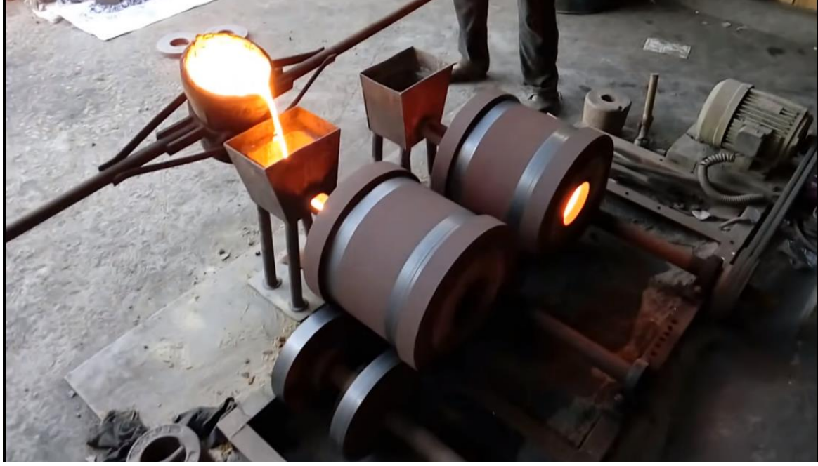
الشكل (5-5) ماكينة الطرد المركزي الأفقية أثناء صب المنصهر المعدن في حوض الصب
