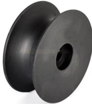
الشكل (5-13) المنتج النهائي لمسبوكية بكرة دوارة بعد عمليات التشغيل المسبوكات
