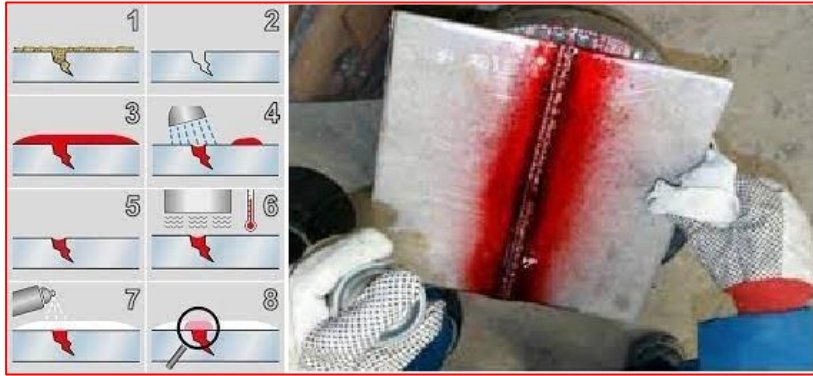
الشكل (28-6) إختبار الفحص بالصبغة المتغلغلة
