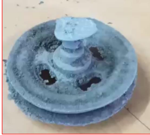
الشكل (6-17) المسبوكة بعد إزالة قالب الرمل من المنصهر بعد إنجماده
