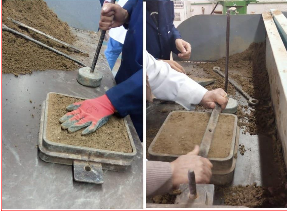
الشكل (6-14) دك الرمل في القالب وجعله متساوياً باستخدام المسطرة والمدكات
