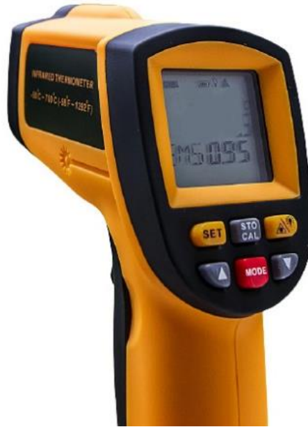
الشكل (3-5) جهاز لقياس درجة الحرارة عن بعد
