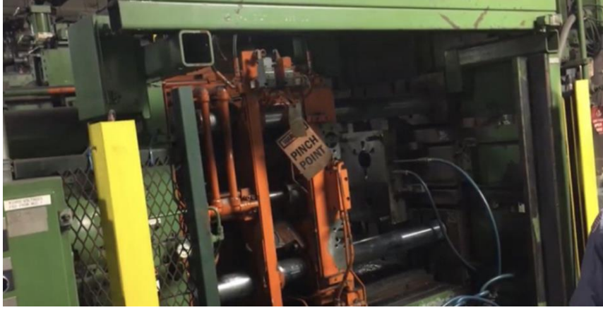
الشكل (a12-3) تهيئة الماكينة وفحص القالب قبل السباكة
