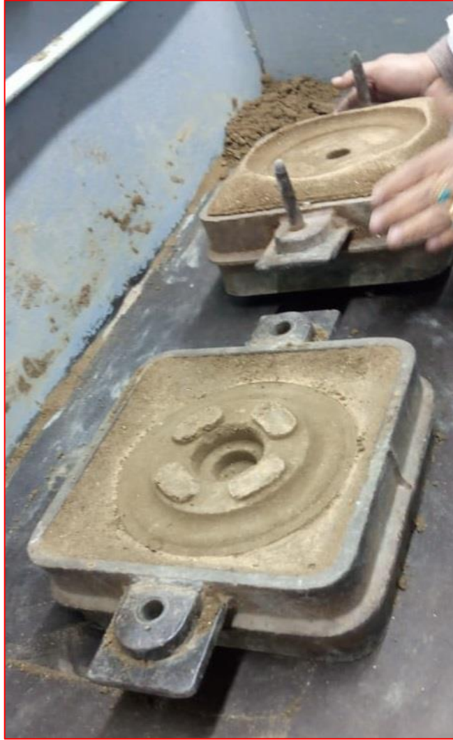
الشكل (6-16) قالب الرمل بعد إزالة نموذج القالب قبل عملية صب المنصهر
