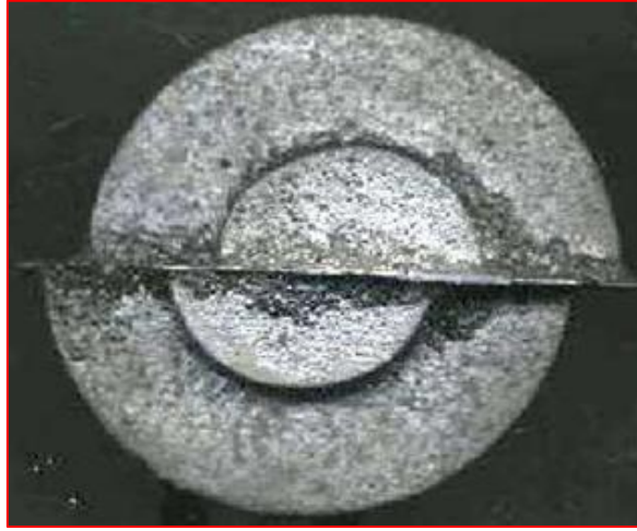
الشكل (1-6) يبين عيب عدم تطابق المسبوكة
