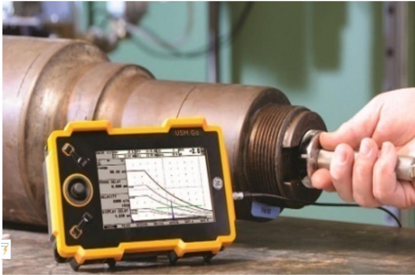
الشكل (6-31) الفحص بالموجات فوق الصوتية
