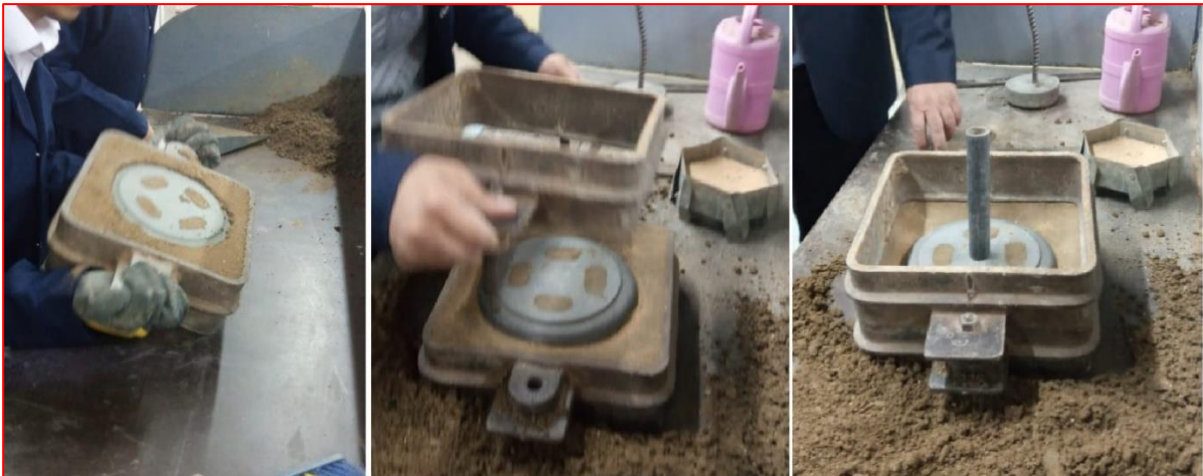
الشكل (6-15) قلب الصندوق السفلي ووضع الصندوق العلوي للمقابلة مع منظومة الصب
