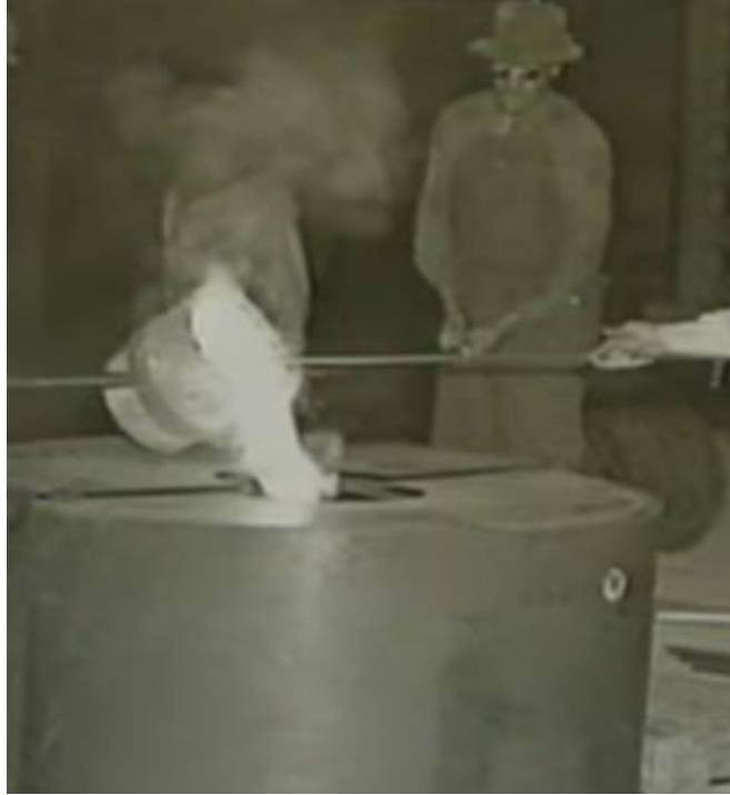
الشكل (5-12) صب منصهر المعدن على القالب من خلال قناة الصب المركزية
