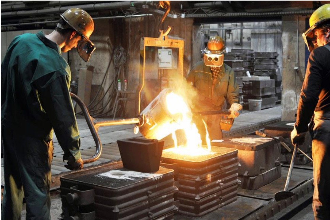
الشكل (19-2) صب منصهر الفولاذ من البودقة بمُعدات مناولة ونقل جيدة
