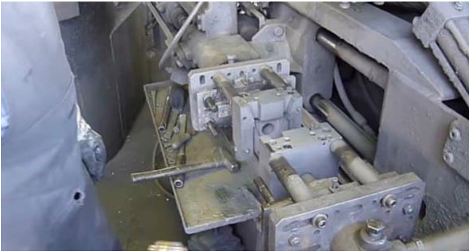
الشكل (3-7 a) تهيئة القالب
