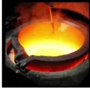
الشكل (3-4) يوضح فرن صهر الفولاذ
