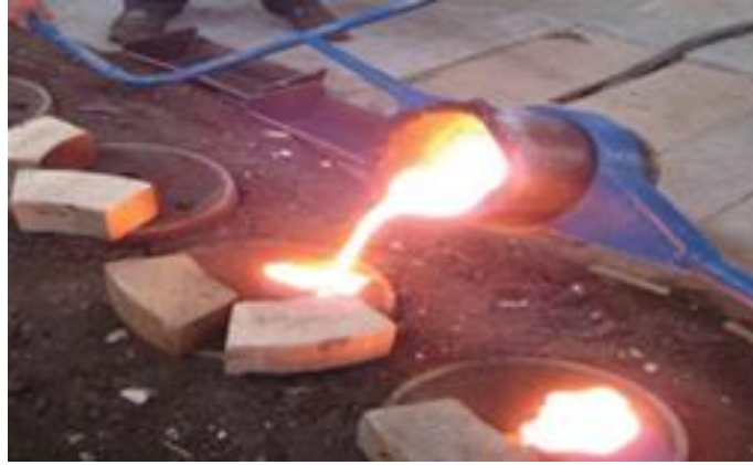
الشكل (11-2) صب منصهر المعدن
