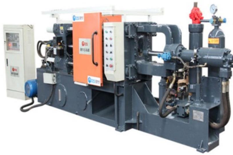
الشكل (a9-3) يوضح ماكينة السباكة بالضغط بالغرفة الباردة.
