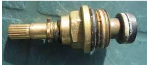
الشكل (30-2) قلب حنفية مركب فيه مانعات التسرب
