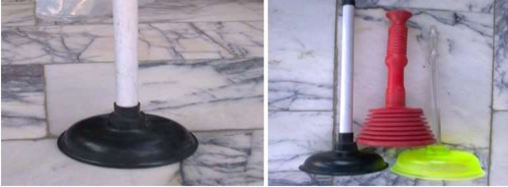
الشكل ( 11-3 ) يمثل المضخة المطاطي
