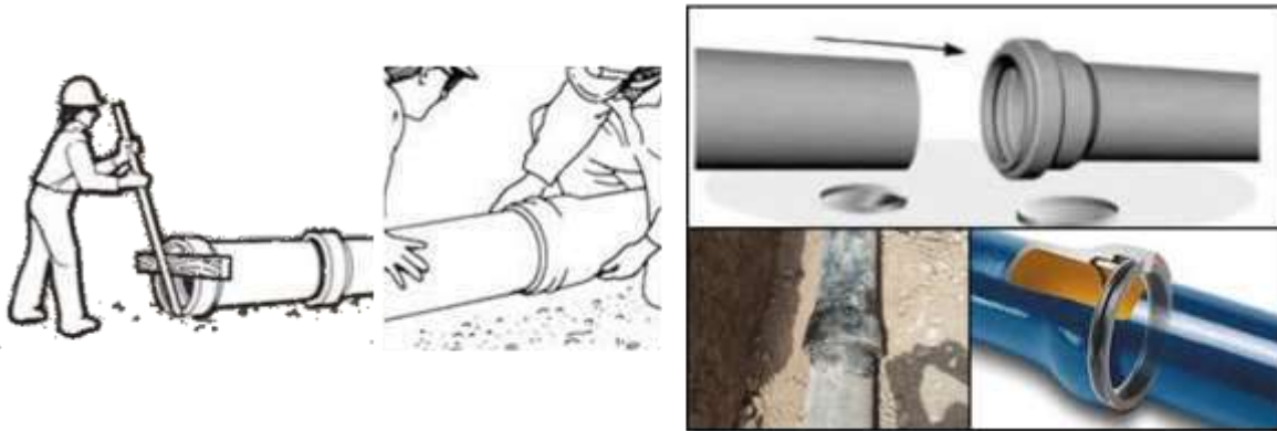
الشكل ( 2 - 26 ) يوضح تركيب الأنابيب صغيرة الاقطار وخفيفة الوزن
