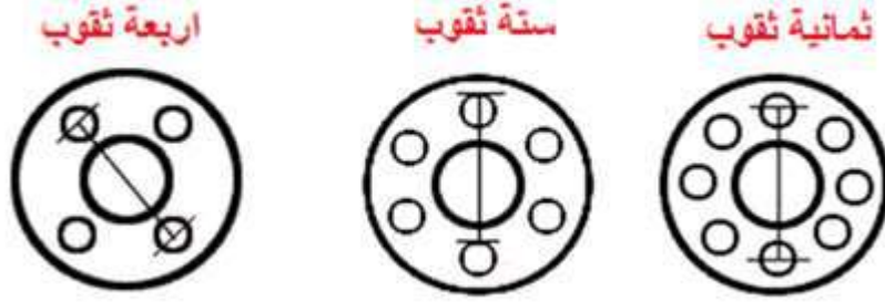
الشكل ( 2 - 49 ) يوضح قياس دائرة التنقيب ( لفلنجة مزدوجة الثقوب )
